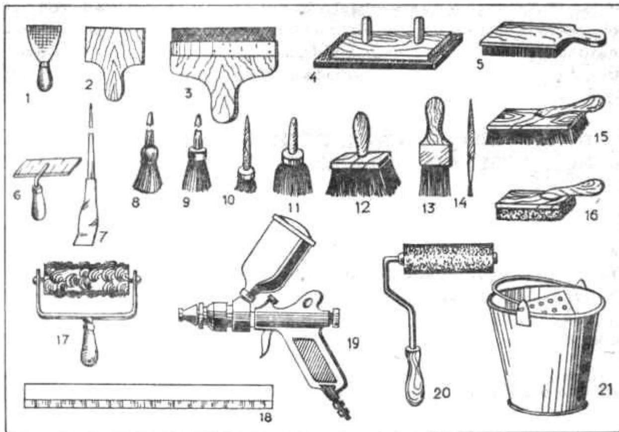
**Рис. 91. Основные инструменты и приспособления для малярных работ:**
