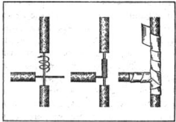
**Рис. 131.** Соединение проводов под углом.
