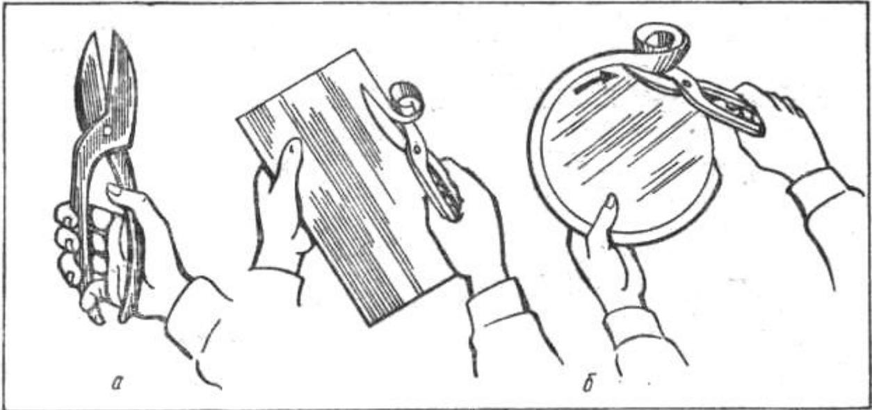
**Рис. 27. Резка металла ручными ножницами:**
