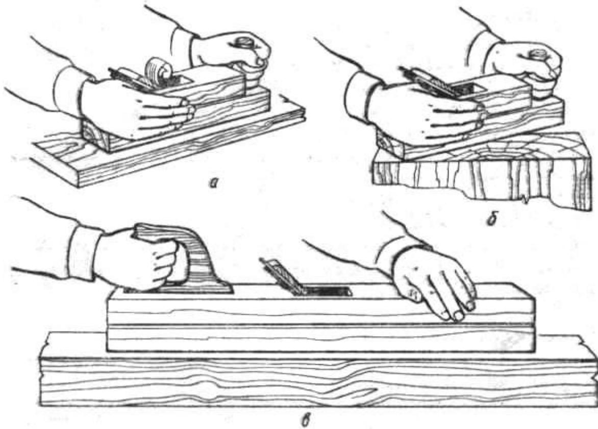
**Рис. 15. Стругание древесины:**
