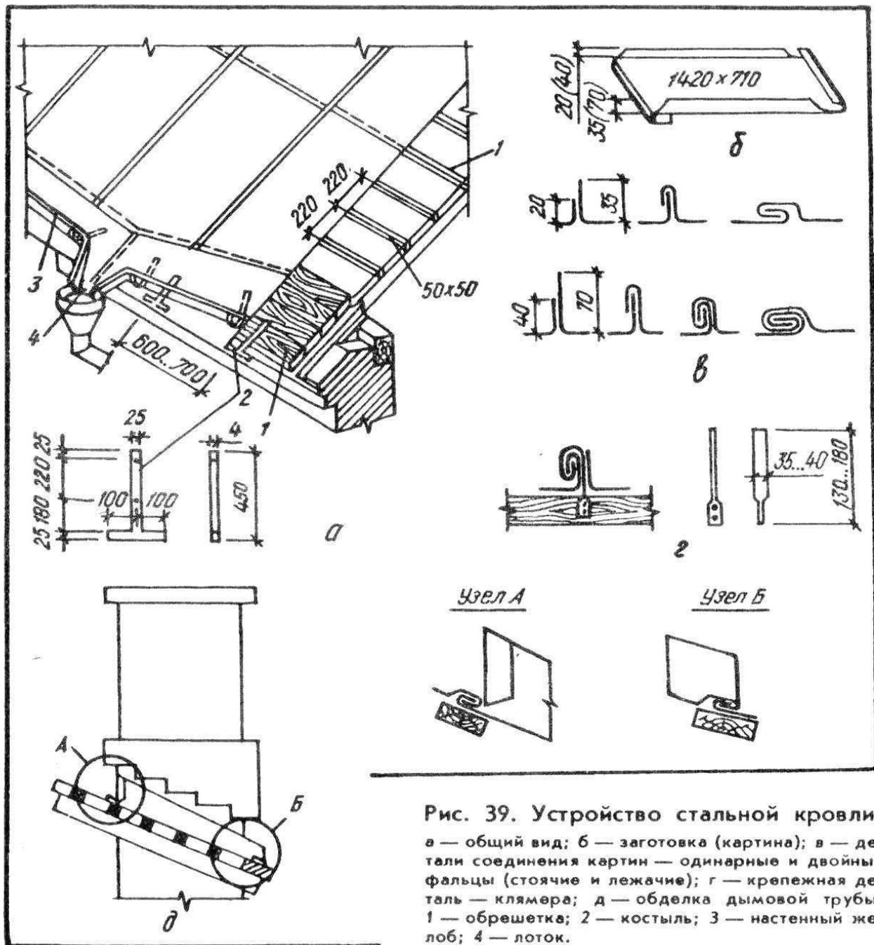
Рис. 39. Устройство стальной кровли:
