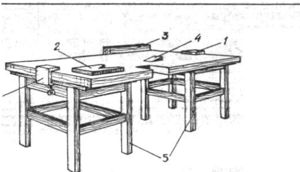
Для строгания пласти доску укладывают на верстачную доску упирают один торец в упор, а по другому ударяют молотком. Обрабатываемая доска при этом насаживается на шипы и достаточно прочно держится в процессе обработки. При строгании кромки материал упирают в вырез треугольника. В вертикальном положении обрабатываемый материал закрепляют клином в прямоугольном вырезе. Поперечную распиловку материала производят, пользуясь упором, закрепленным шурупами справа на продольной стороне верстачной доски.
