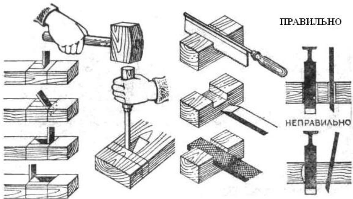
**Рис. 16. Выдалбливание отверстий в древесине:**
