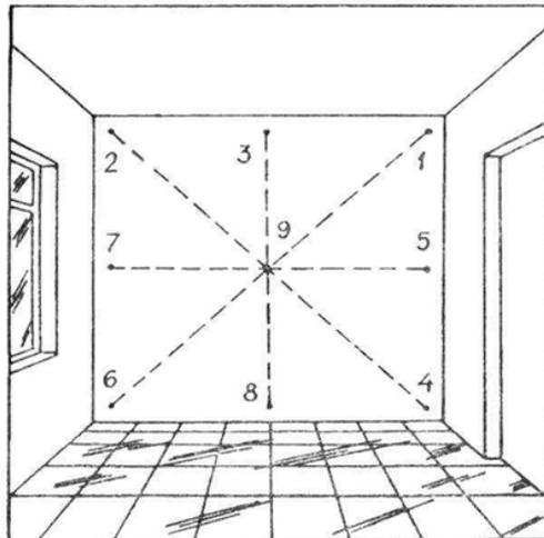
Рис. 116. Схема провешивания поверхности под маяки.
