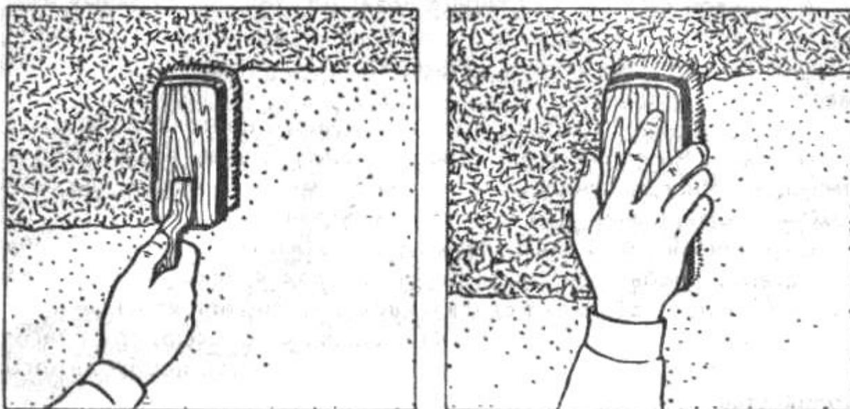
**Рис. 105. Торцевание поверхности щеткой-торцовкой и одежной щеткой.**
