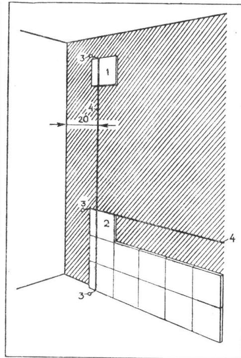
между установленными крайними плитками и укладывают плитки второго ряда, идя от одного края к другому.
