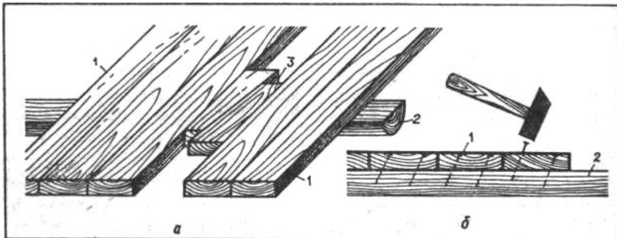
к каждой балке или лаге. Щель между стеной и первой доской будет перекрыта плинтусом. Затем производят дальнейшее настиление пола.
