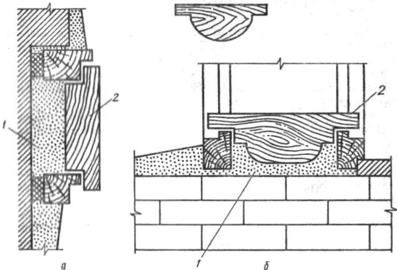
Рис. 72. Оштукатуривание заглущин с помощью малок: а — верхней и боковых; б — нижней; 1 — заглушина; 2 — малка.
