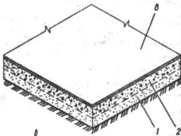
В санитарных узлах первых этажей устраивают плиточные полы. Основание для них готовят так же, как для дощатых полов по лагам, с той разницей, что щебеночный подстилающий слой приливают не известковым, а цементным раствором состава 1 : 3 (цемент : песок), и тщательно выравнивают.
