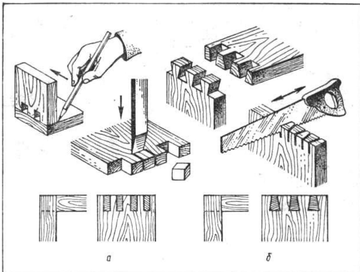
**Рис. 18. Угловые ящичные соединения:**
