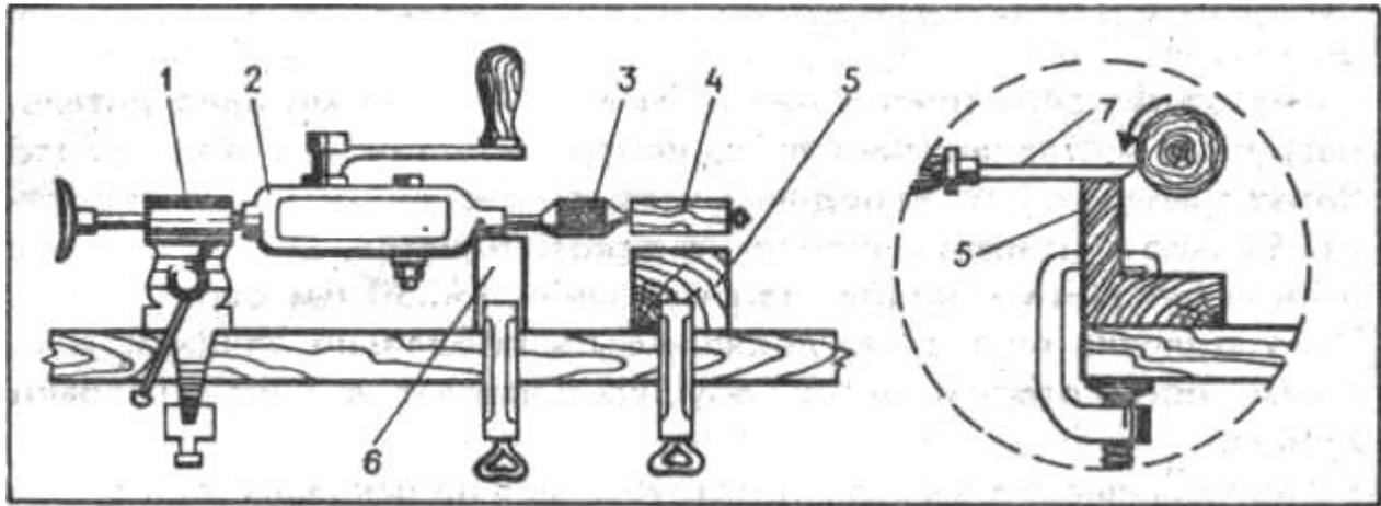
**Рис. 22. Использование дрели в качестве настольного токарного станка:**
