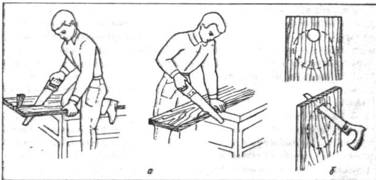
**Рис. 14. Резание древесины ножовкой:**
