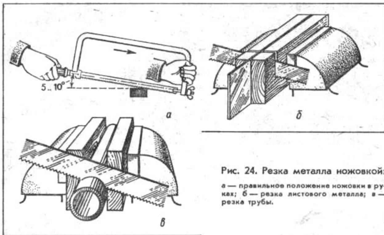
Рис. 24. Резка металла ножовкой:
