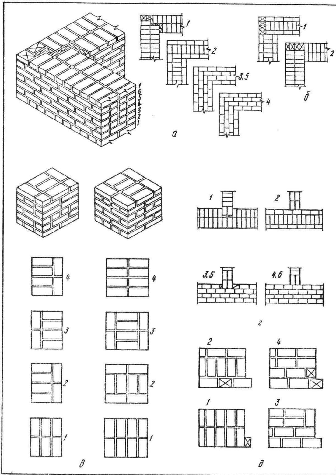
**Рис. 33. Сплошная кладке стен и столбов из кирпича:**
