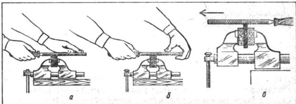
опиловании зажимают между двумя уголками или дощечками (рис. 26, в).
