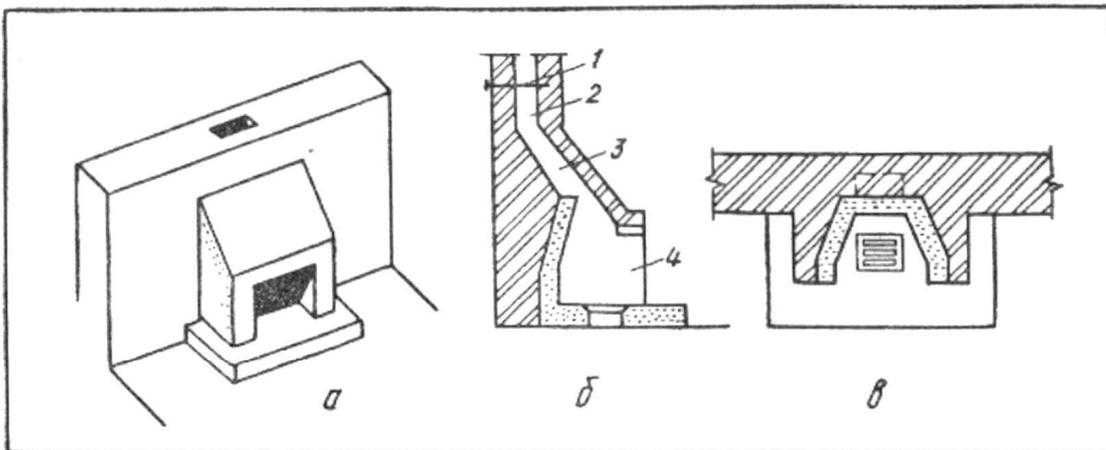
1/16 высоты портала; площадь ее принимают в 1,25 раза больше поперечного сечения дымохода.
