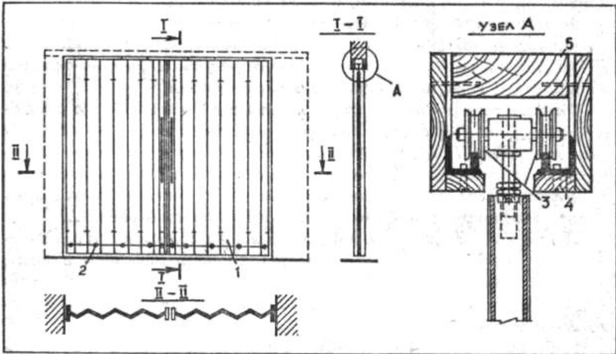
**50. Легкая ширнрно-складывающаяся перегородка из узких щитов:**
