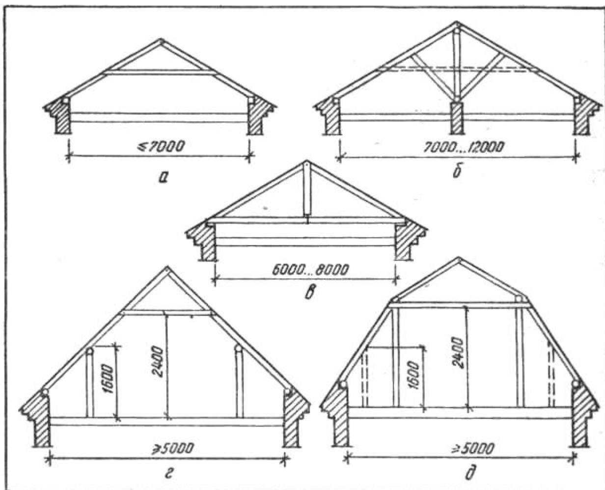
**Рис. 37. Устройство стропил и мансардных крыш:**
