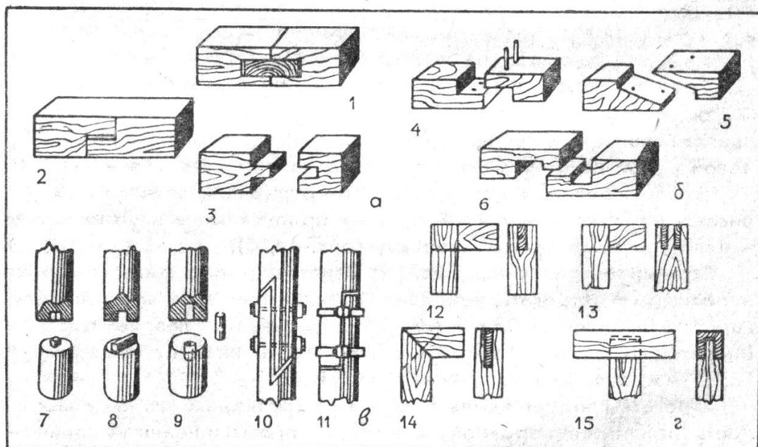
**Рис. 17. Приемы соединения деревянных элементов:**
