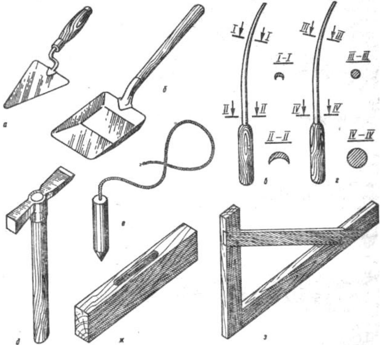
**Рис. 29. Инструменты для каменных работ:**
