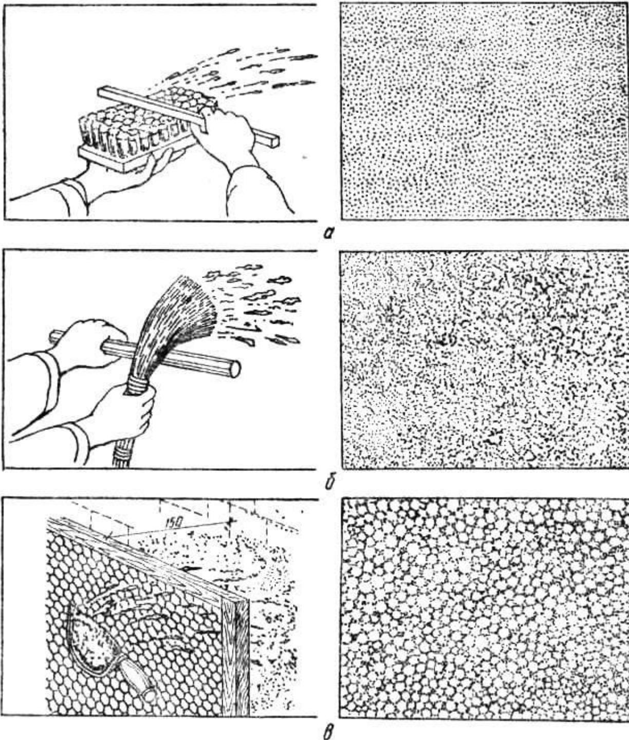
**Рис. 73. Отделка оштукатуренной поверхности набрызгом:**
