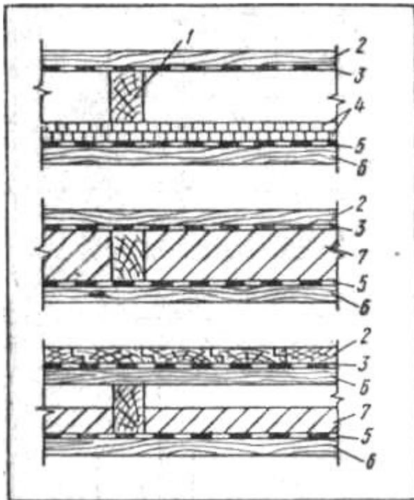
**Рис. 154. Варианты конструктивного решения каркасной стены сауны:**
