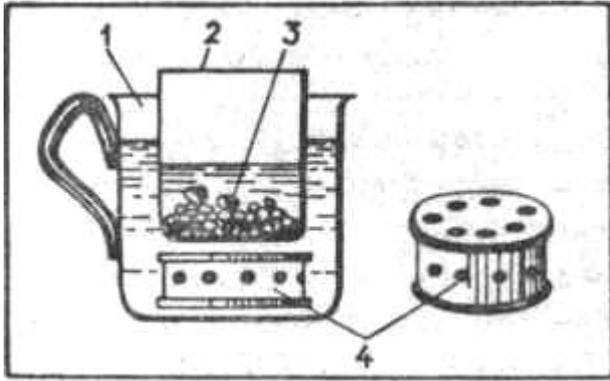
**Рис. 13. Клееварка для столярного клея:**
