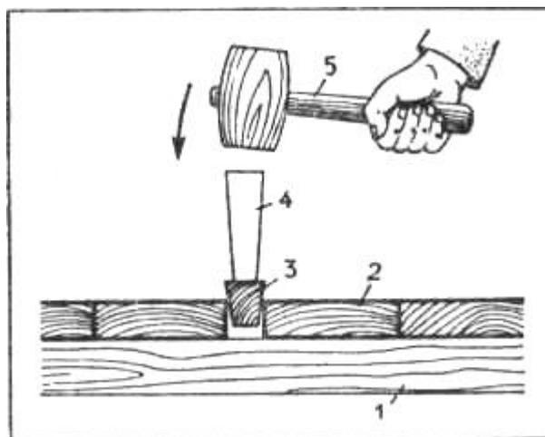
расчищают щели, затем соответственно размерам щелей из мягкого сухого дерева заготавливают планки. В сечении такая планка имеет вид слегка суживающегося клина. Планки ставят насухо или на клею ПВА; забивают их при помощи деревянного клина и киянки (рис. 55). Узкие щели заделывают штукатурной дранкой.
