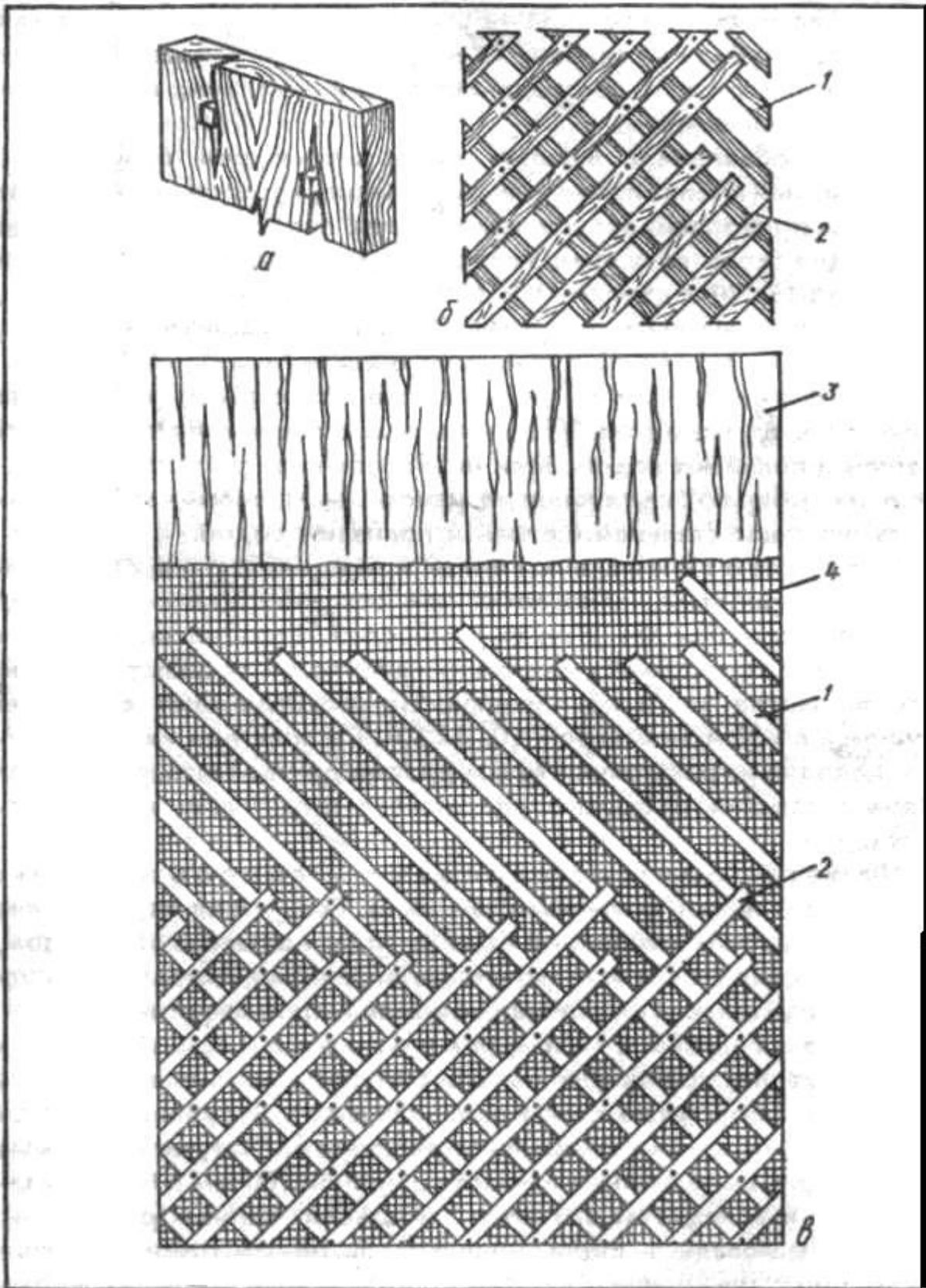
**Рис. 64. Подготовка деревянной поверхности к оштукатуриванию:**
