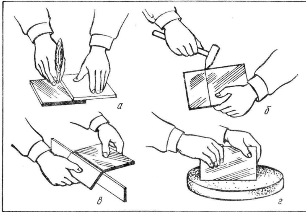
Рис. 115. Перерубывание глазурованной плитки:
