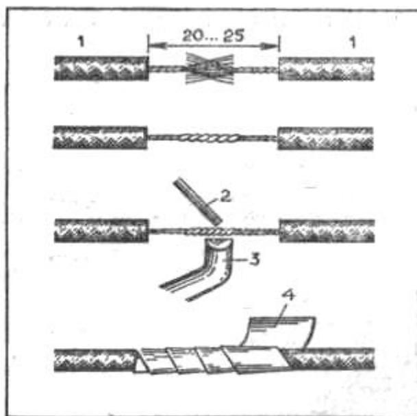
**Рис. 129. Соединение провода, сплетенного из большого количества тонких провололочек:**
