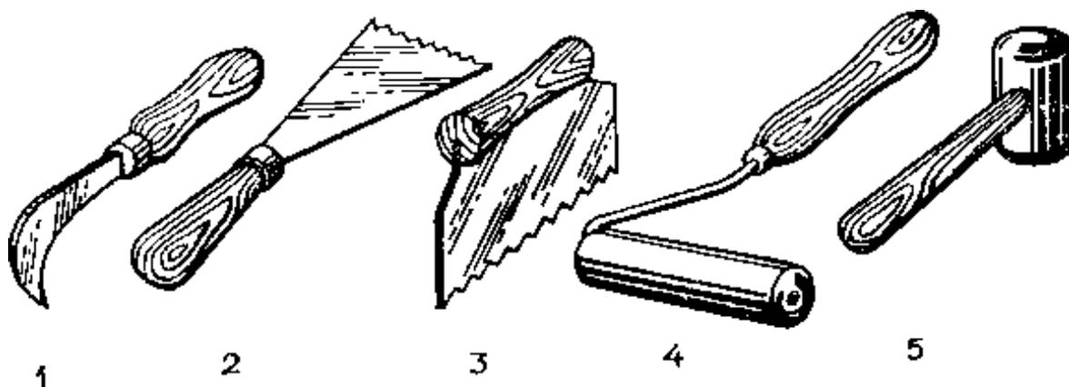
**Рис. 60. Набор инструментов, используемых при наклеивании линолеума:**
