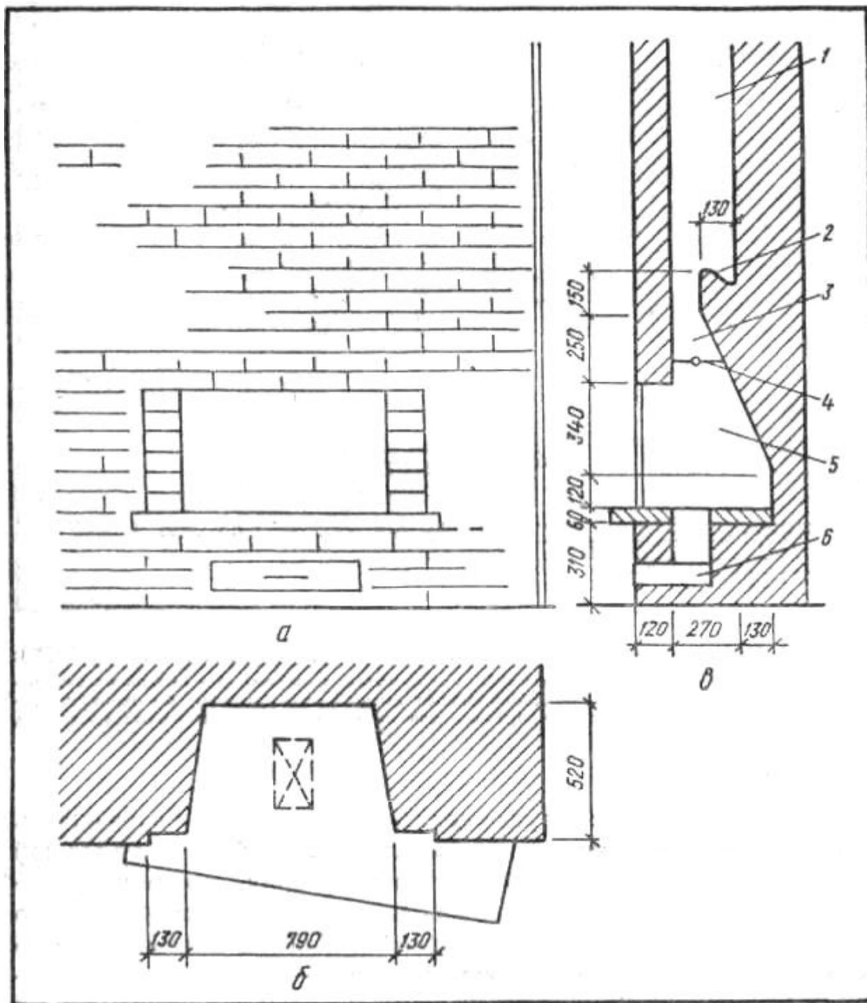
**Рис. 139. Камин, встроенный в стену здания (Эстонская ССР):**
