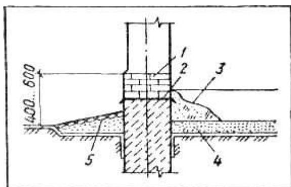
**Рис. 32. Устройство цоколя каменной стены по ленточному фундаменту:**
