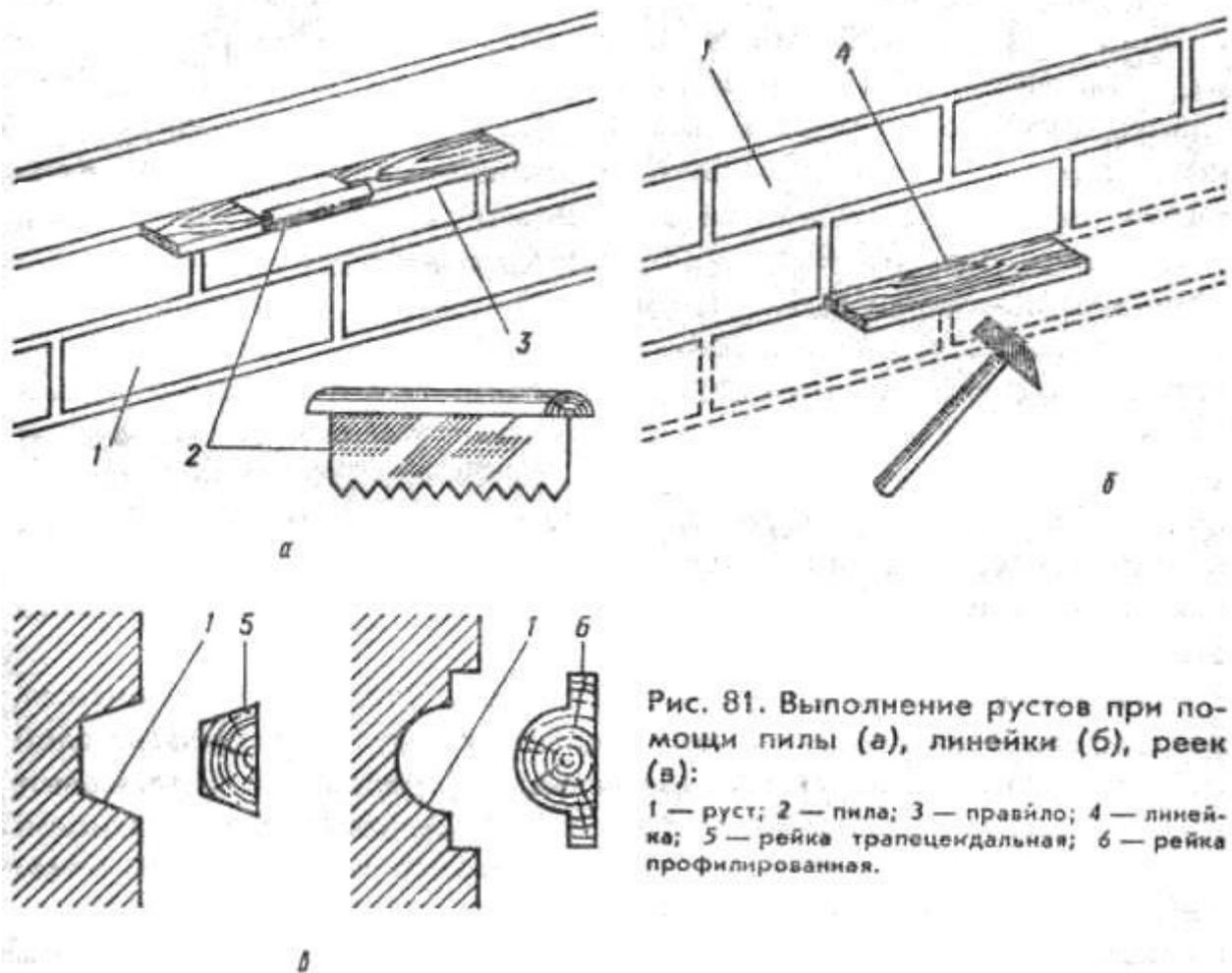
Рис. 81. Выполнение рустов при помощи пилы (а), линейки (б), реек (в):
