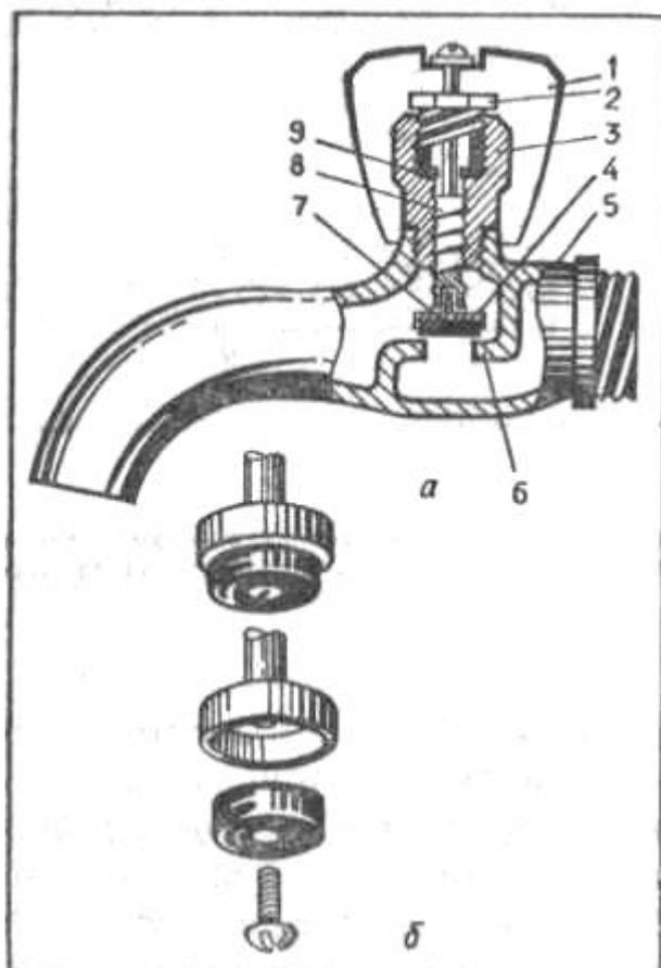
**Рис. 122. Конструкция и ремонт водоразборного крана:**
