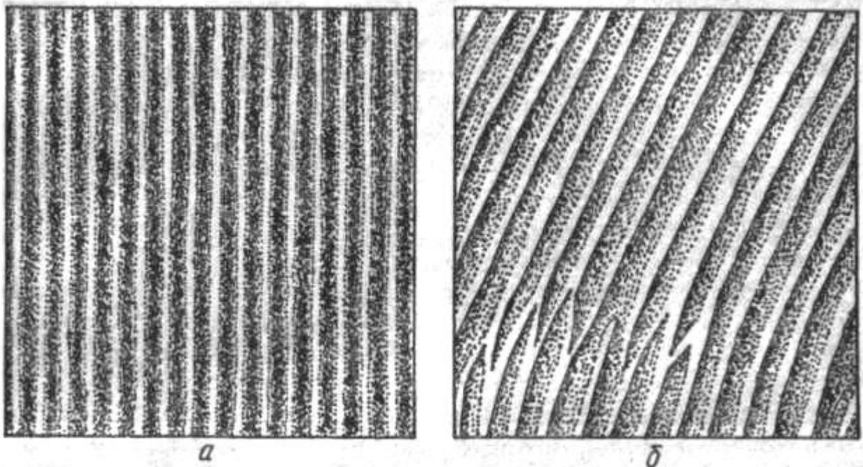
Рис. 83. Фактуры получаемые при обработке поверхности троянкой и скерпелем:
