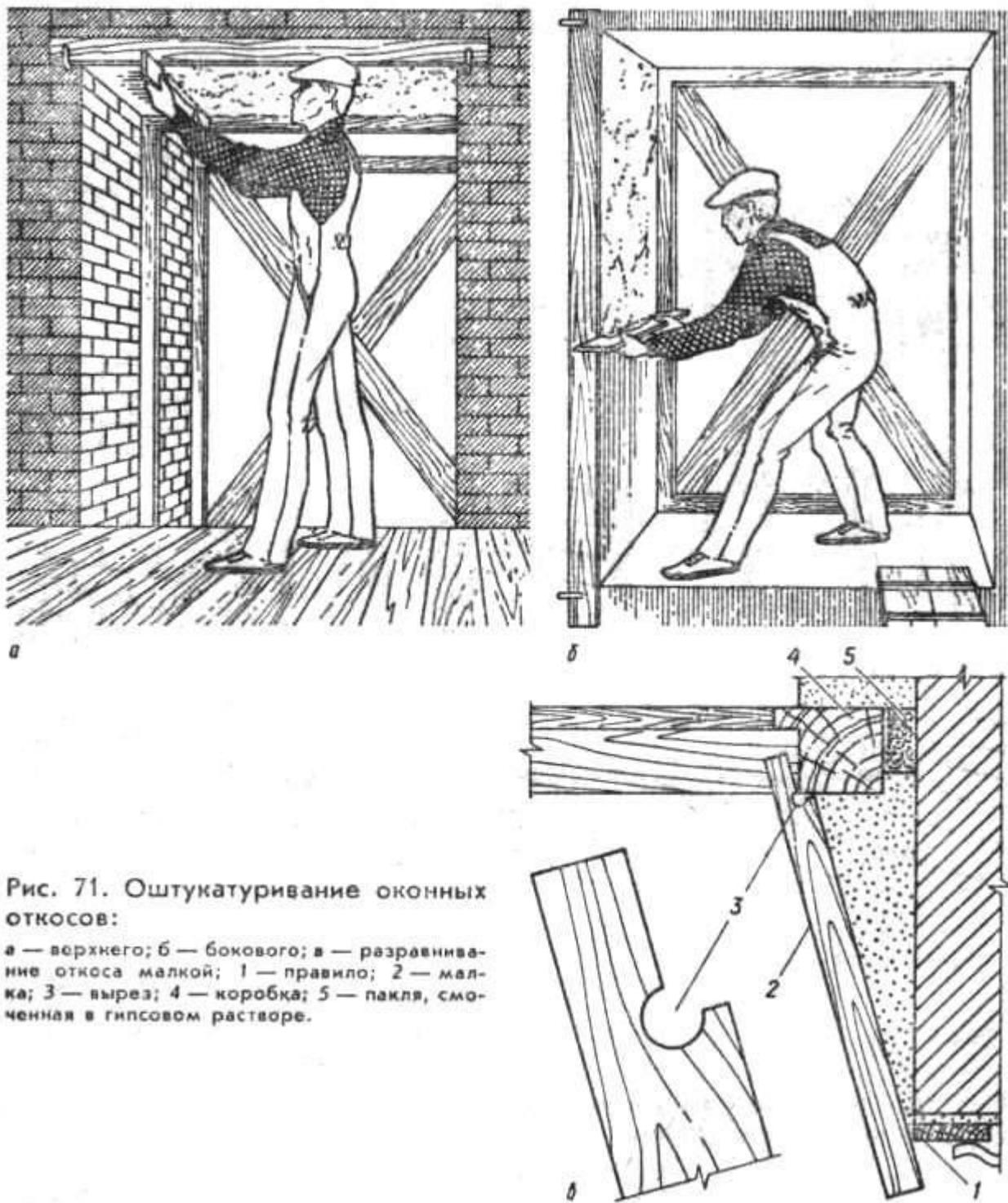
Рис. 71. Оштукатуривание оконных откосов:
