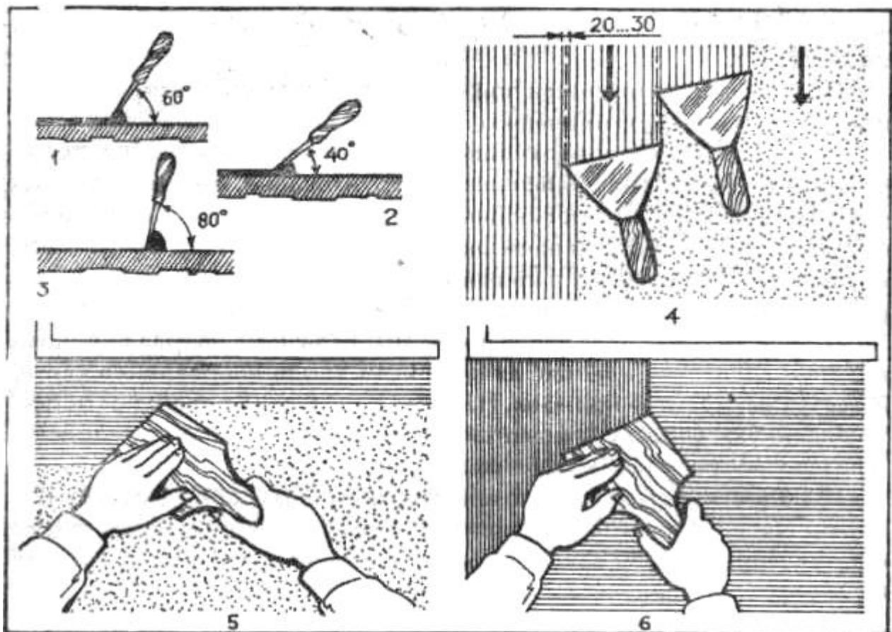
**Рис. 93. Шпатлевание поверхности:**
