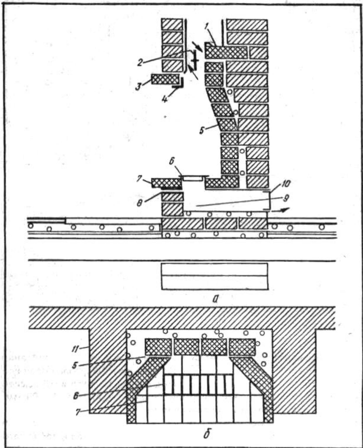
**Рис. 137. Конструкция камина с подзольником (ЧССР):**
