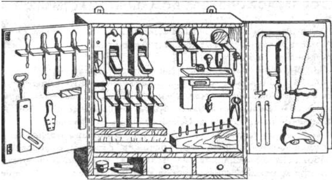
**Рис. 3. Настенный шкаф для столярных инструментов.**
