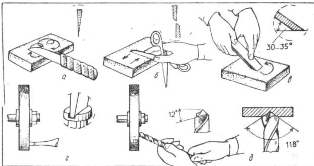
**Рис 9** Примеры затачивания инструментов
