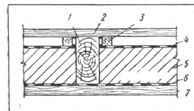
1 — бака; 2 — дощатый настил; 3 — брусок 40×40 мм; 4 — строительная бумага; 5 — минеральная вата; 6 — строительная бумага на алюминиевой фольге; 7 — подшивка потолка досками.
