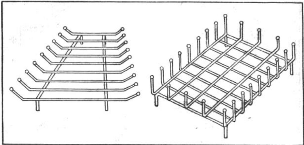
Рис. 140. Корзинки для сжигания топлива.
