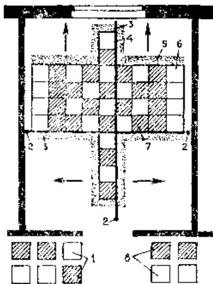
**Рис. 62. Схема наклеивания плиток на пол параллельными рядами с фризом:**
