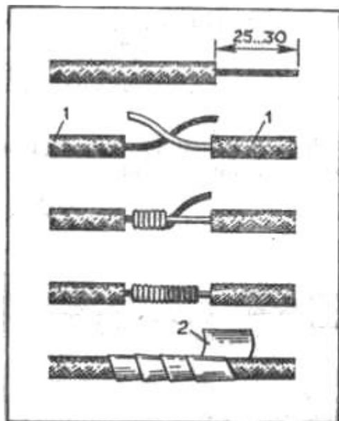
**Рис. 128. Соединение провода из одного толстого проводника:**
