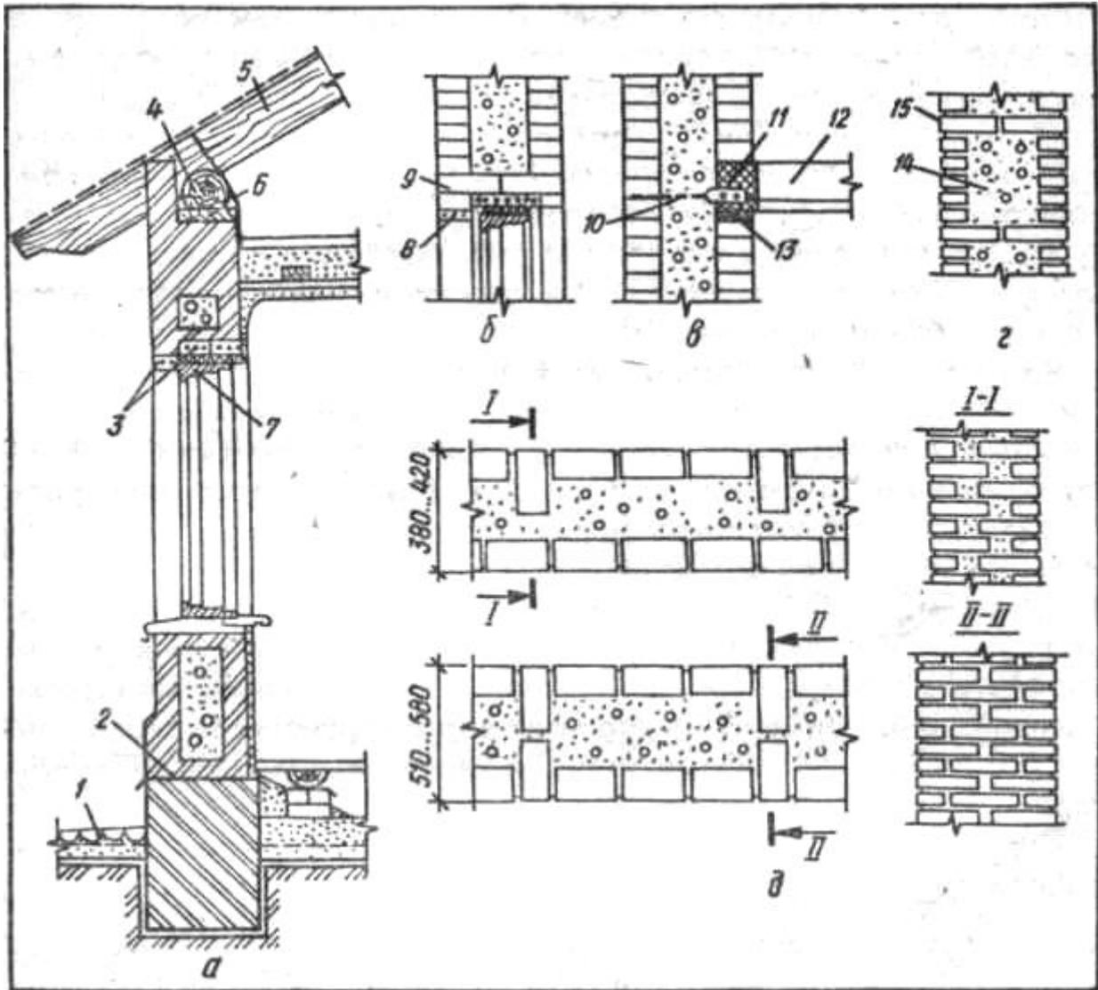
**Рис. 35. Конструктивные решения пустотелых кирпичных стен:**
