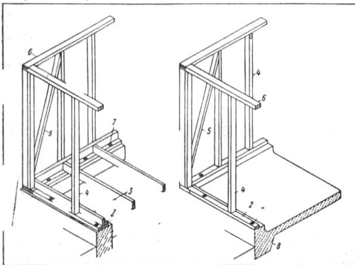
**Рис. 152. Схемы конструктивного решения сауны на ленточном фундаменте**
