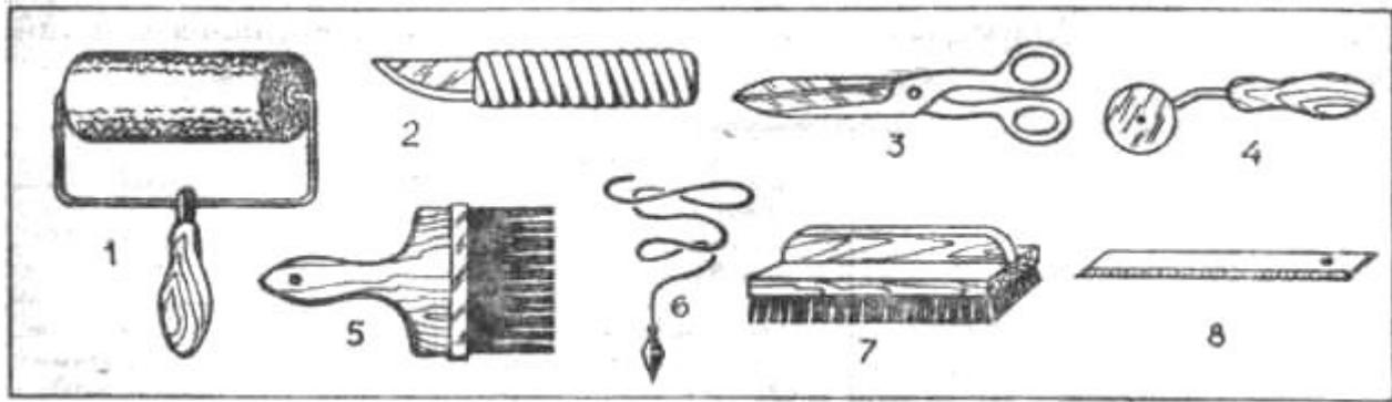
**Рис. 112. Инструменты для обойных работ:**
