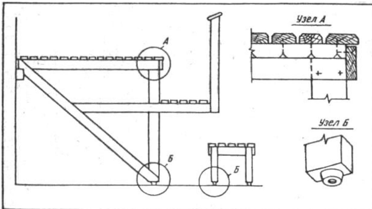
Рис. 146. Вариант конструкции скамьи.
