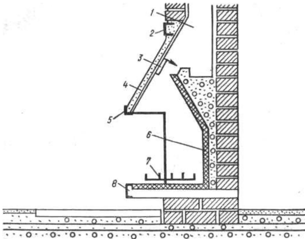
**Рис. 138. Конструкция камина с металлическим дымосборником (ЧССР):**
