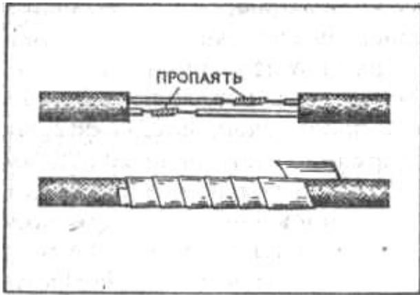
**Рис. 130.** Соединение двужильного провода.
