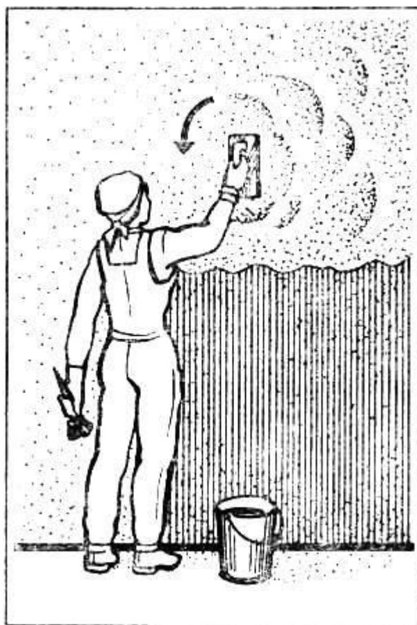
затирки пересохшую поверхность смачивают водой при помощи кисти.
