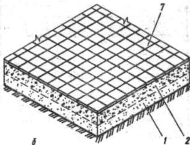
Рис. 52. Устройство полов по грунту:
