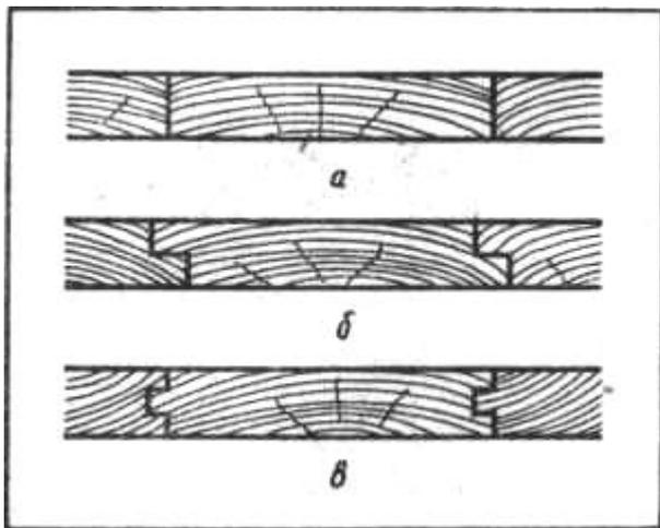
**Рис. 53. Способы соединения половых досок:**
