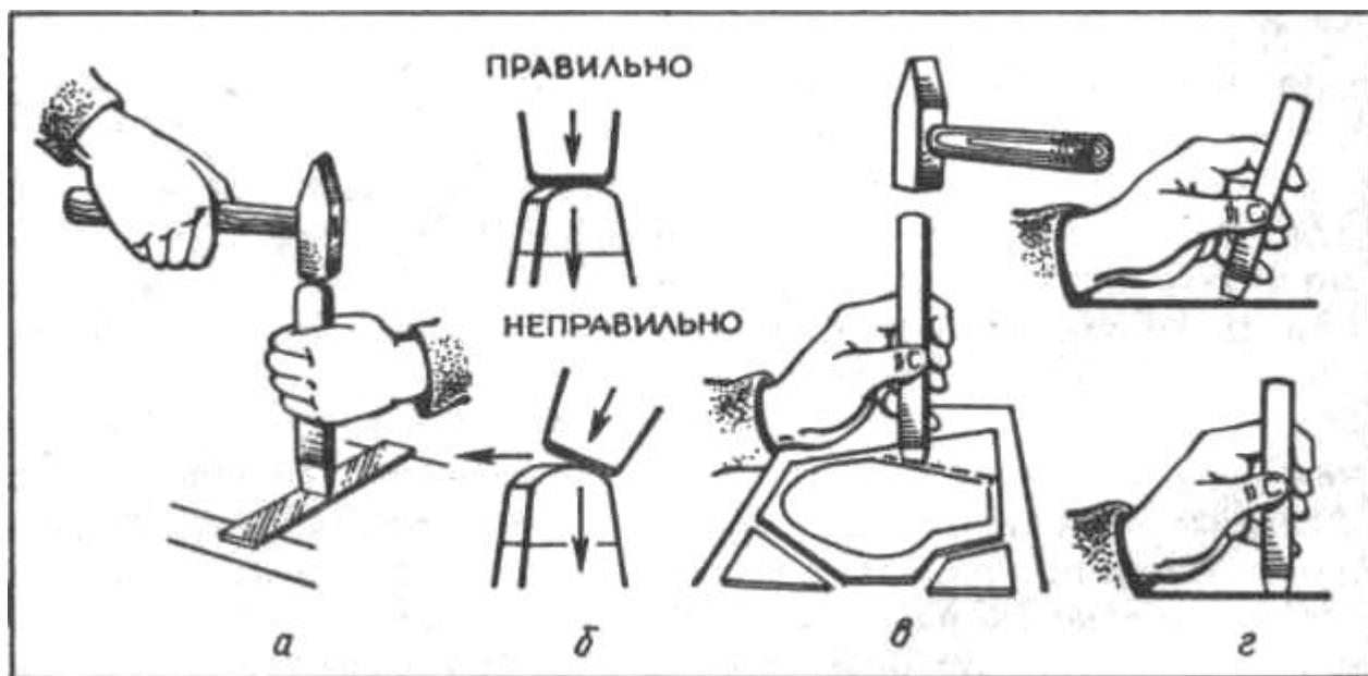
**Рис. 23. Рубка металла зубилом:**
