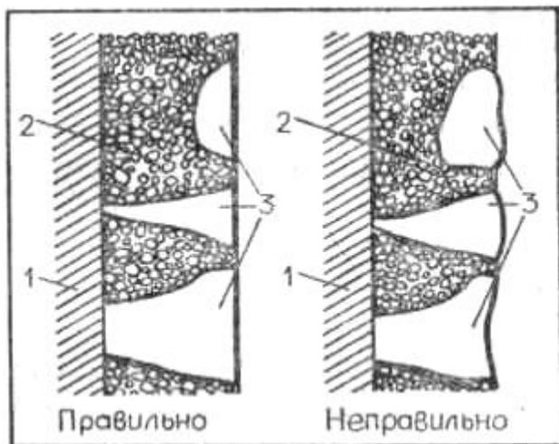
**Рис. 85. Подмазывание трещин в штукатурке:**
