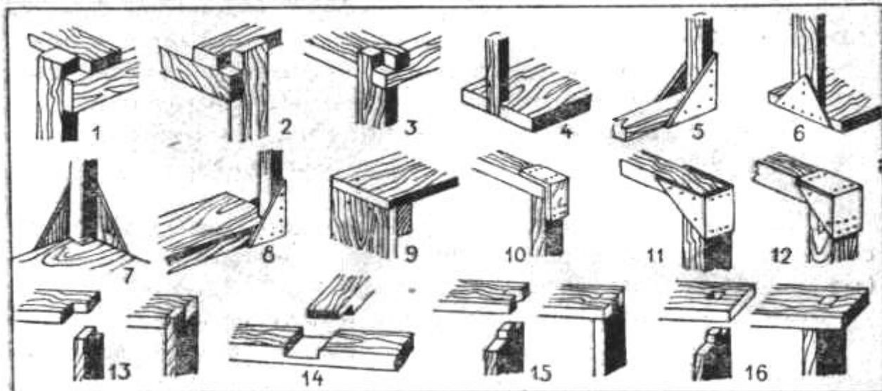
**Рис. 19. Способы соединения деревянных элементов:**
