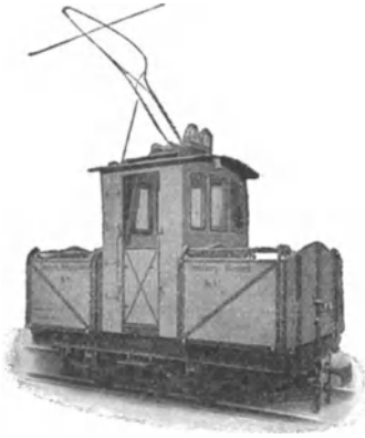
Abb. 168. Elektrischer Motorwagen zur Beförderung von Kohle (Ausführung von Orenstein & Koppel, Berlin).
