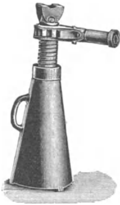
Abb. 50. Schraubenwinde (Bauart von A. Schlesinger, Werdohl).
