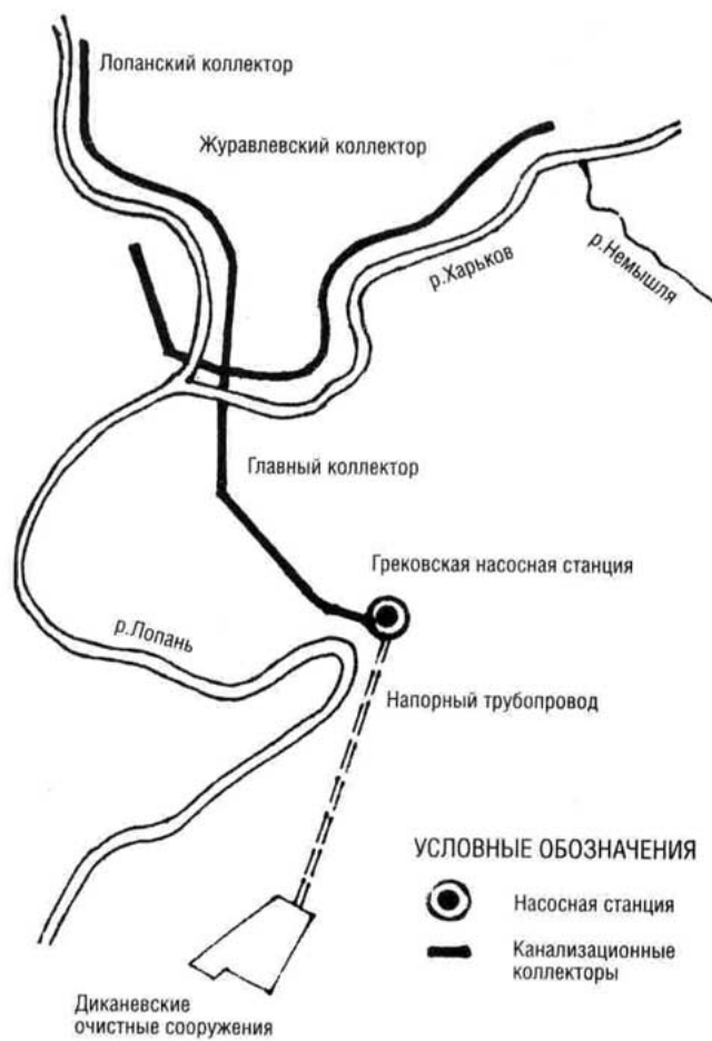
Схема канализационных коллекторов постройки 1912-1914 гг.
