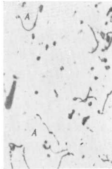
Рис. 148. Парные дислокации в плоском скоплении дислокаций в нихроме 80/20 с добавкой 7,5% (ат.) Al (Глейтер и Хорнбоген)
