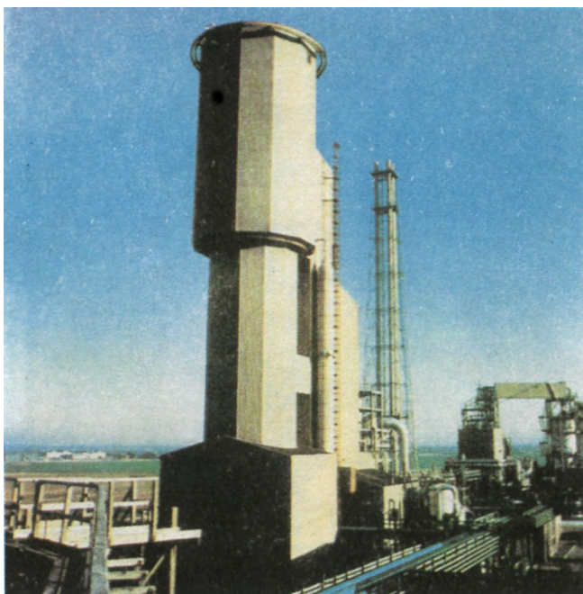
Биореактор для производства белка из метанола (Биллингхем, Англия).
