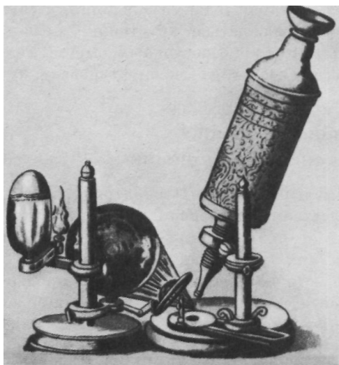
Многолинзовый микроскоп Роберта Гука, с помощью которого он обнаружил растительные клетки на тонком срезе бутылочной пробки.
