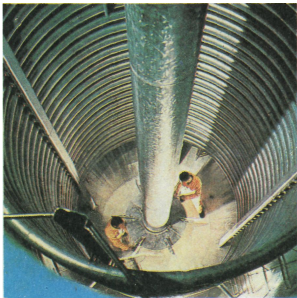
Незаполненный биореактор для крупномасштабного производства пенициллина (вид изнутри). Отчетливо видны мешалка и охлаждающая рубашка.
