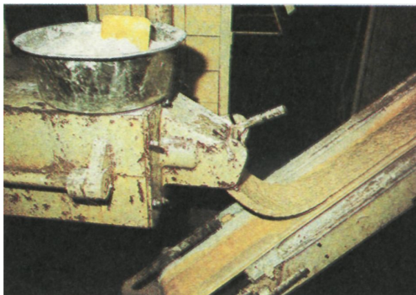
Готовое тесто покидает бродильный чан для формирования буханок хлеба, где повторно «подходит».
