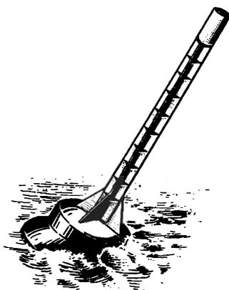
Рис. 19. Веха со спиральным радиолокационным отражателем
