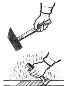
Рис. 132. Наковка штукатурки зубилом
