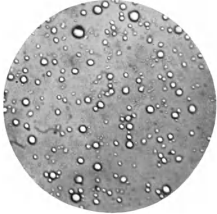
Abb. 7. Magermilch bei 50 atü homogenisiert (Probe 8).
