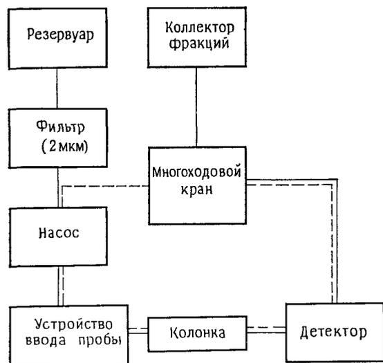
Рис. 4.13. Схема циркуляционной установки.
