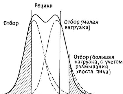
Рис. 1.15 Использование метода циркуляции с отбором пика.
