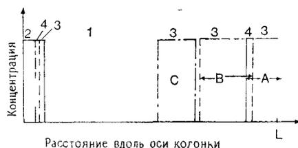
Рис. 3.2. Схематические профили концентраций внутри идеальной препаративной колонны при элюировании. Бесконечное число тарелок (отсутствие размывания зон). Обозначения см на рис. 3.1.
