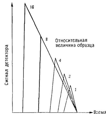
Рис. 1.19. Представление (с помощью треугольников) изменения формы полосы с увеличением нагрузки.
