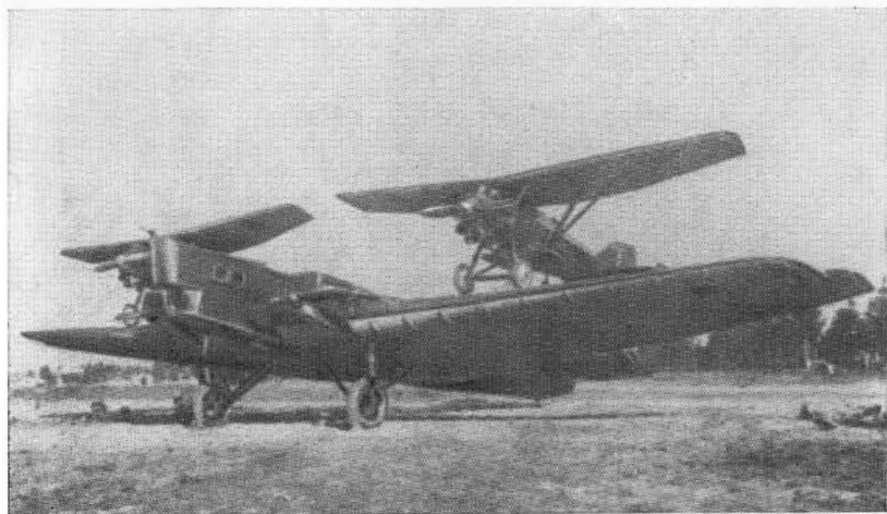
Самолет-звено конструктора В. С. Вахмистрова.
