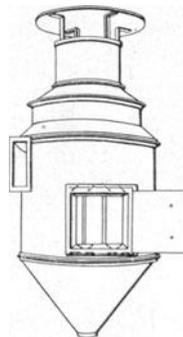
Abb. 45. Vereinigung von Fliehkraftabscheider mit Schlauchfilter (Exhaustorenwerk in Nürnberg).
