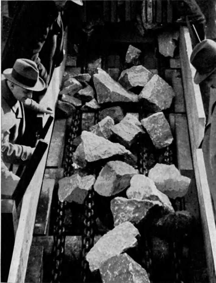
Abb. 4. Ketten-Beschickungs- und Sortierrost der Ibag in Neustadt.
