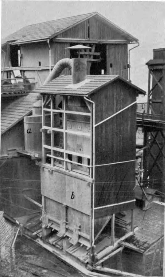
Abb. 46. Fliehkraftabscheider (a) mit hintergeschaltetem Schlauchfilter (b) (Kirner Hartsteinwerke in Kirn).
