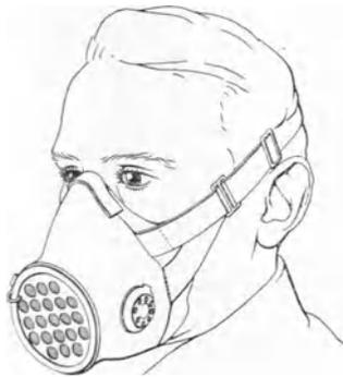
Abb. 49. Staubschutzmaske Lix
