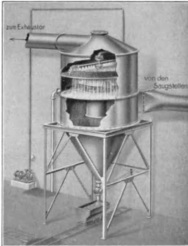
Abb. 42. Daqua-Fliehkraftnaßabscheider (Danneberg & Quandt in Berlin).
