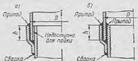
Рис. 12.5. Кольцевое соединение деталей примерно одинаковой толщины, выполненное внахлестку: а — при односторонней пропайке; б — при двухсторонней пропайке
