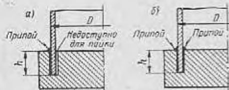
Рис. 12.6. Кольцевое соединение тонкостенной детали с массивной, выполненное сплавом: а — при односторонней пропайке; б — при двухсторонней пропайке
