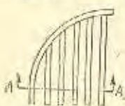
Рис. 24.19. Конструкция стальных решеток под насадку из колец Рашига диаметрами 25, 50 и 80 мм по МН 4095-62-МН 4109-62
