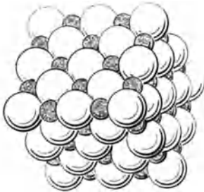
Abb. 62. Raumerfüllung der Na- und Cl-Ionen im Steinsalzgitter; die großen Kugeln sind die Cl-Ionen (aus von LAUE: Röntgeninterferenzen).
