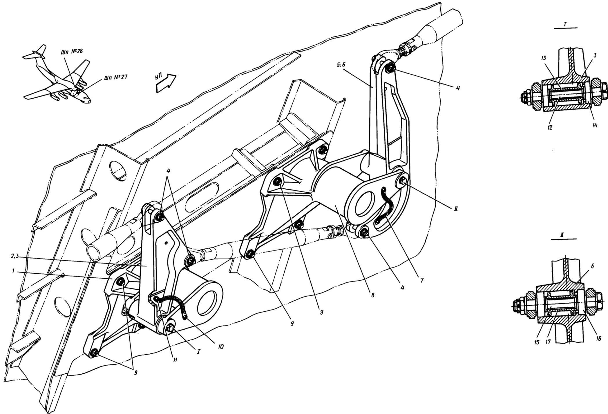
Установка компенсационной качалки управления элеронами
