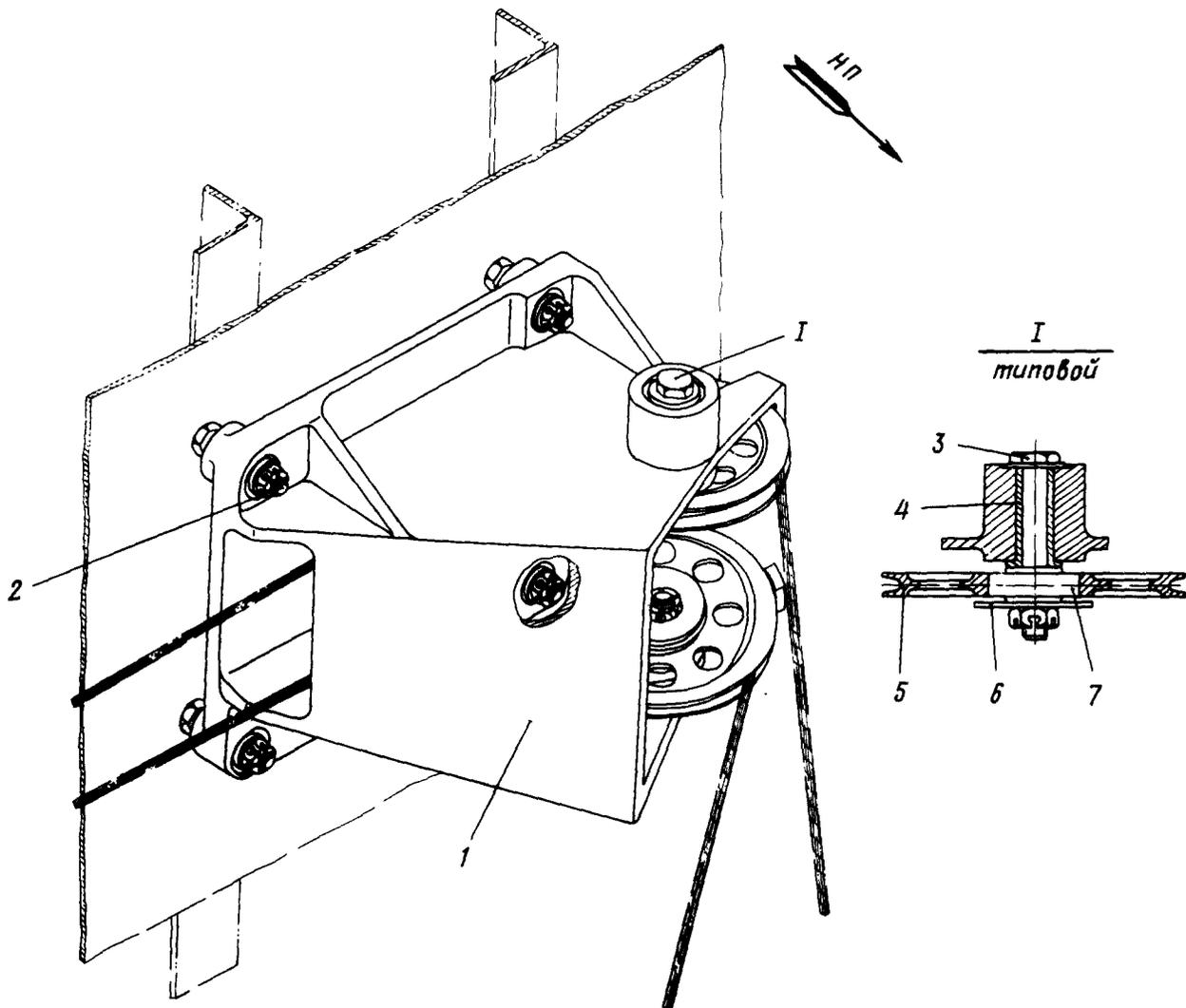
**Установка роликов управления спойлерами в аэрокосмическом режиме
