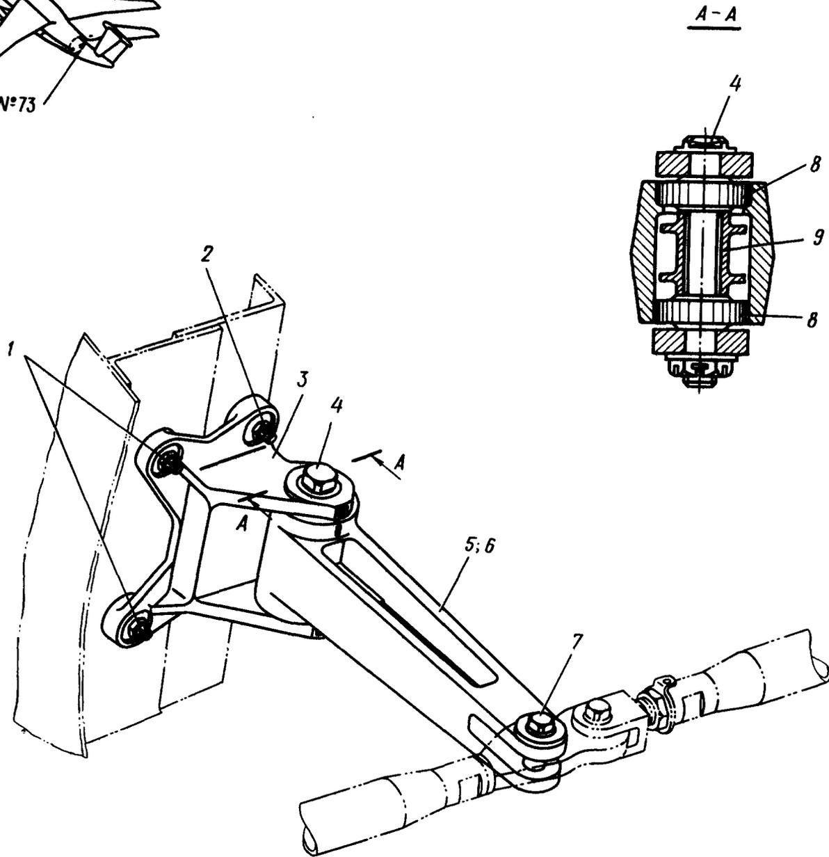
Установка качалки управления РВ на шпангоуте № 73
