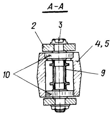
Установка качалки управления элеронами между нервюрами № 0 и I
