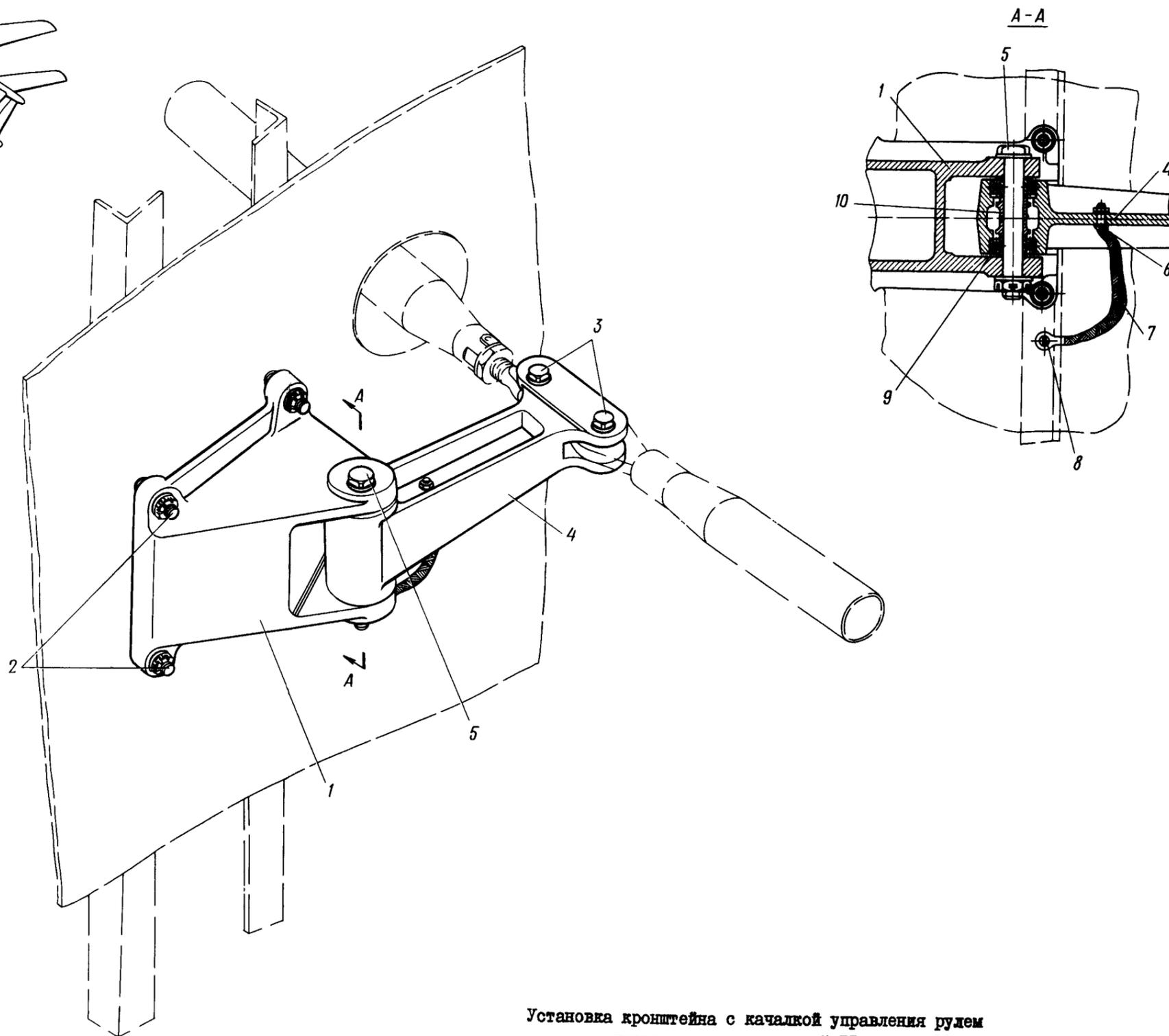
Установка кронштейна с качалкой управления рулем
