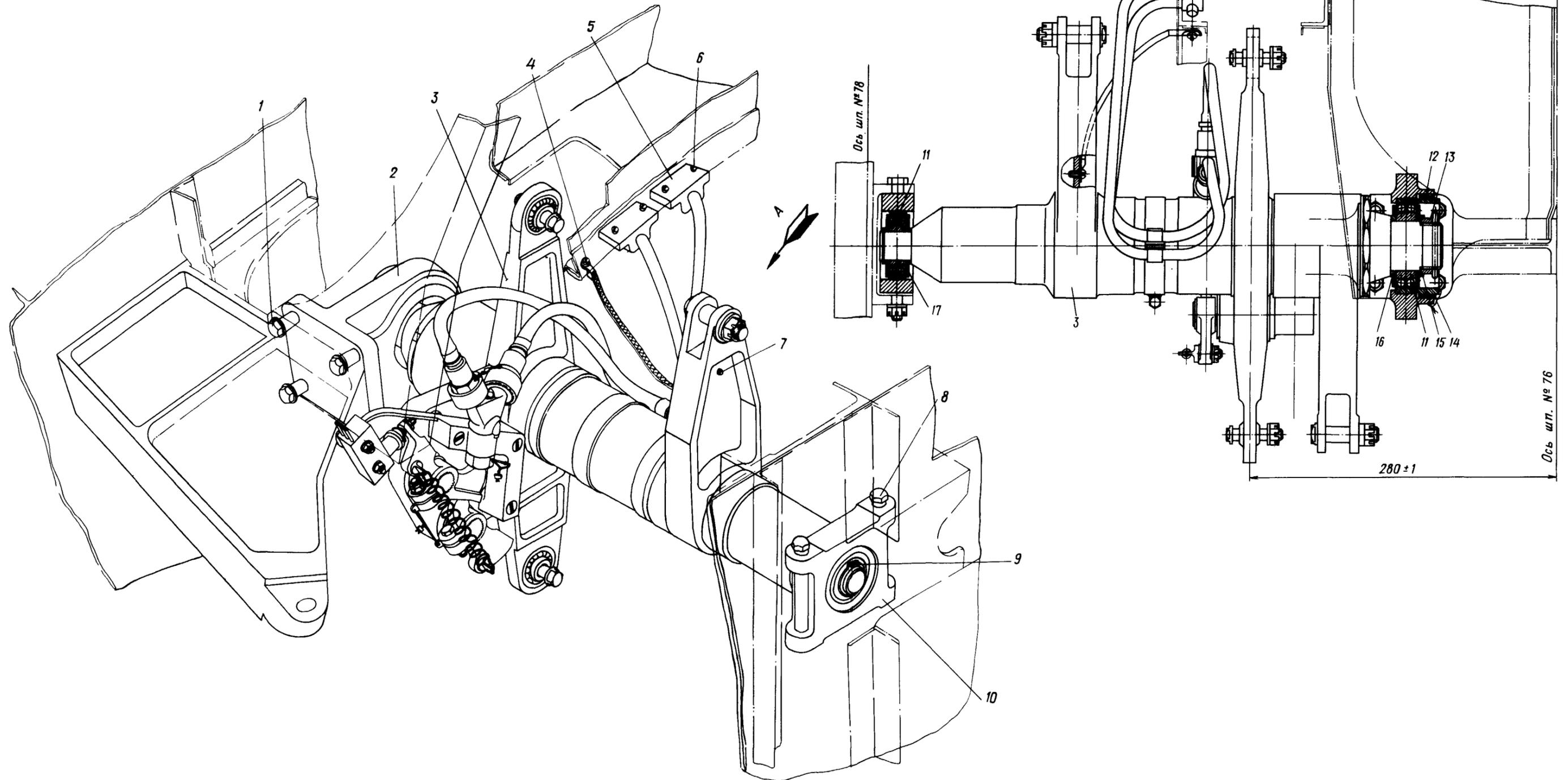
Установка качалки с механизмом отстрела
