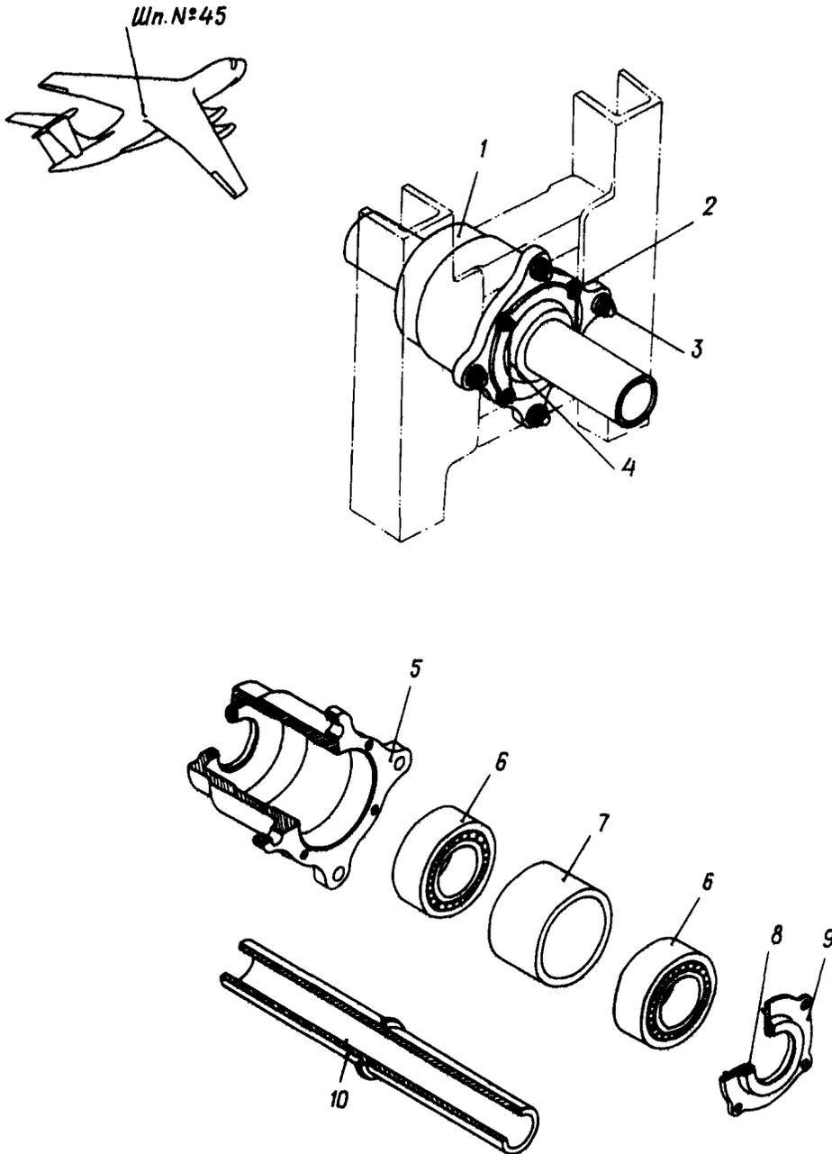
Установка опоры в фюзеляже
