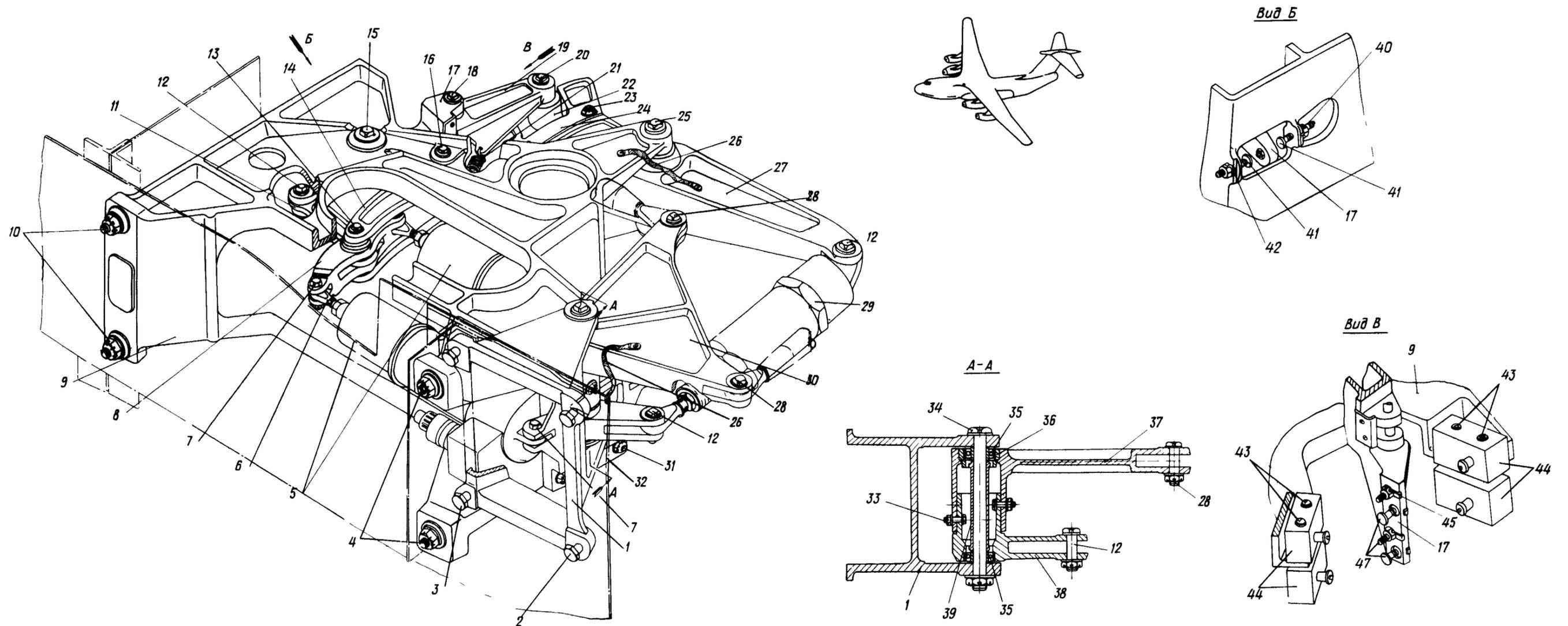
Установка одноступенчатого ограничителя углов отклонения элеронов
