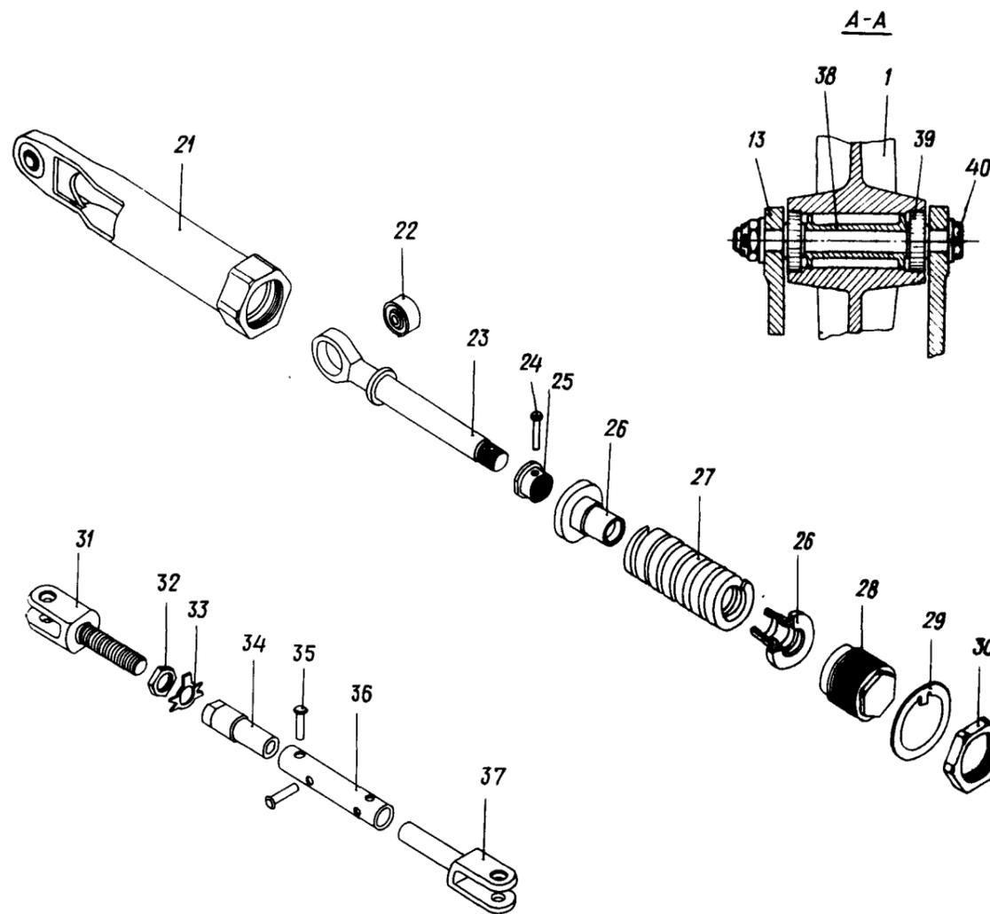
Установка пружинного догрузителя в канале руля направления
