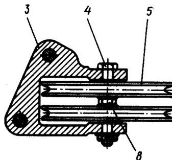
**Установка роликов тросов спойлеров на шпангоуте № 18
