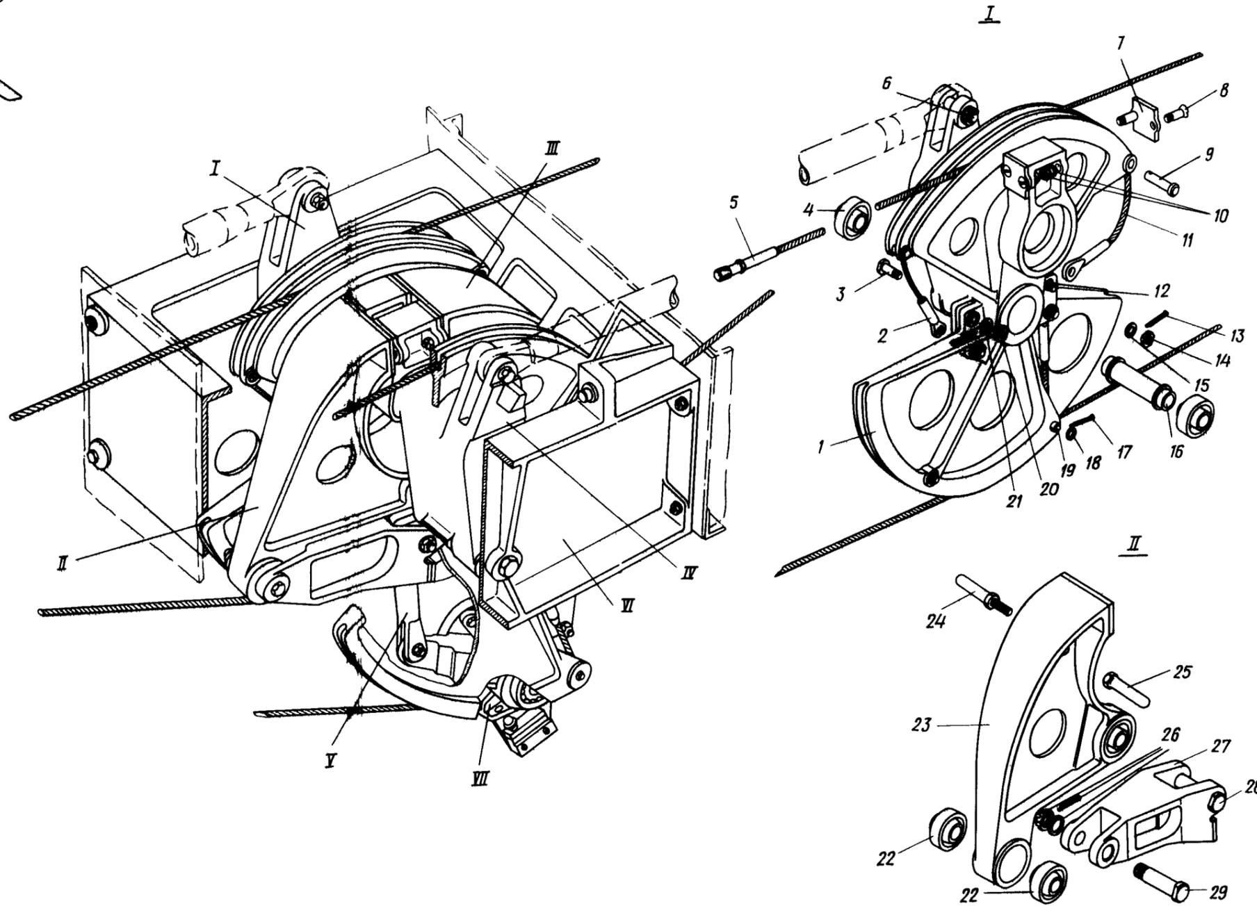
Механизм расщепления проводок управления элеронов и спойлеров
