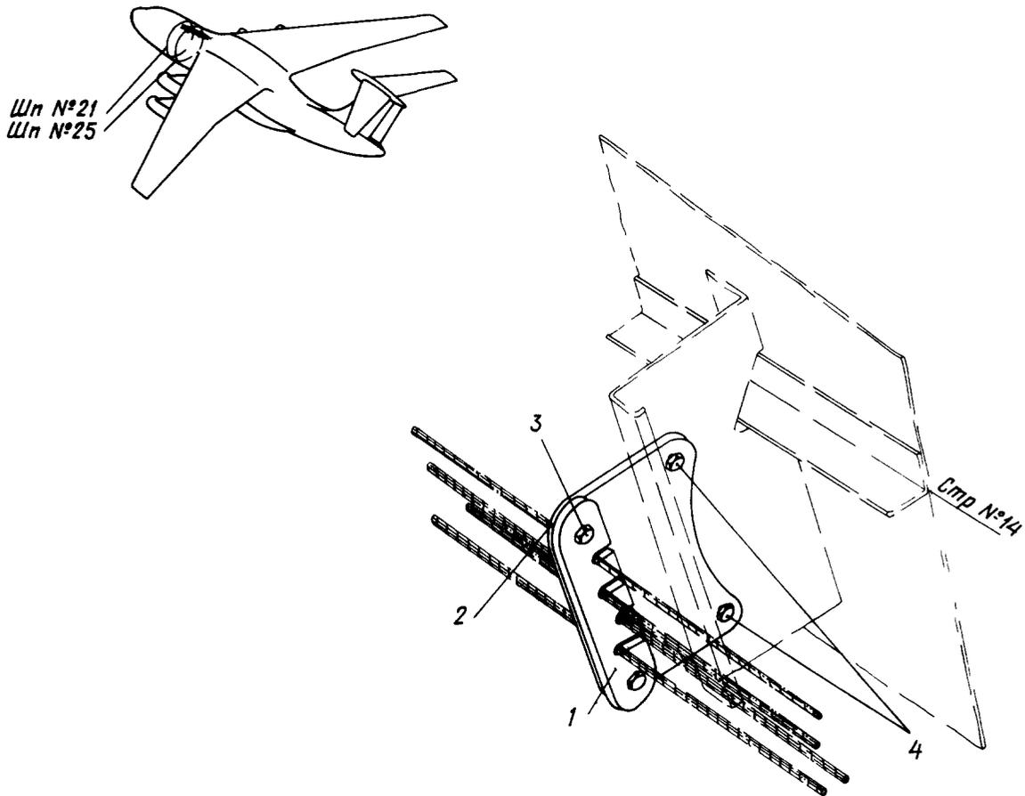
**Установка гребенок тросов спойлеров на шпангоутах № 21, 25**
