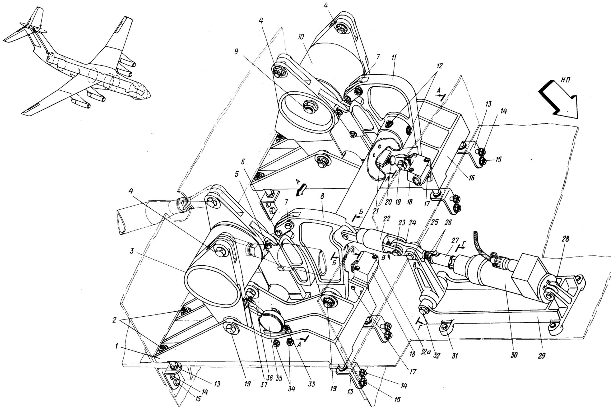
Установка качалки РВ с механизмом стопорения и упором
