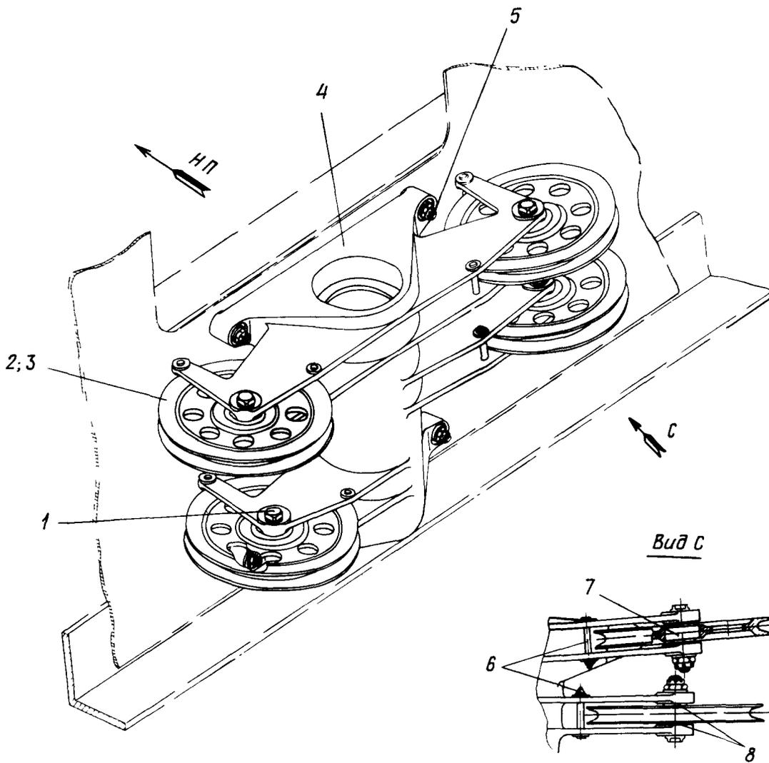
Установка роликов управления элеронами на шпангоуте № 7
