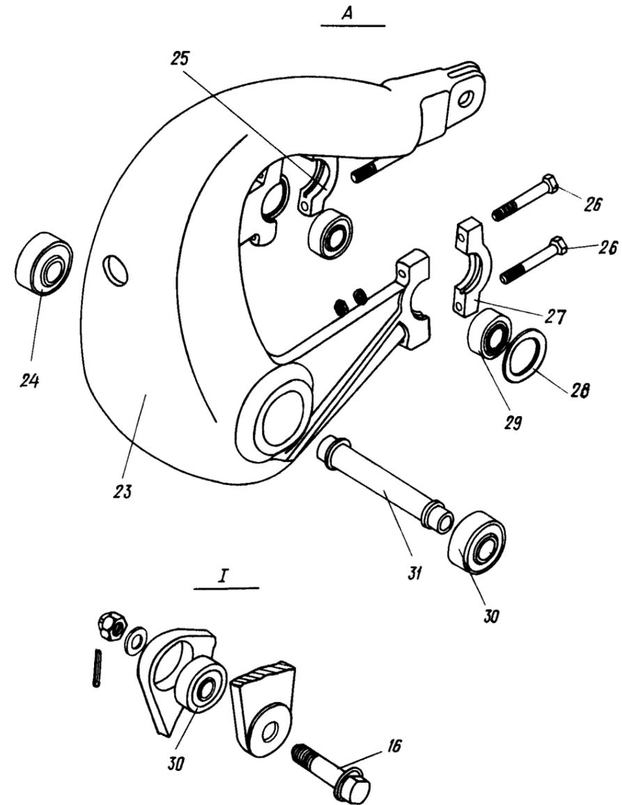
Установка загрузочного устройства в канале РВ
