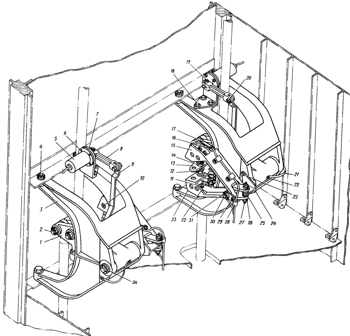
Установка качалки у нервюры № 17 с механизмом сигнализации
