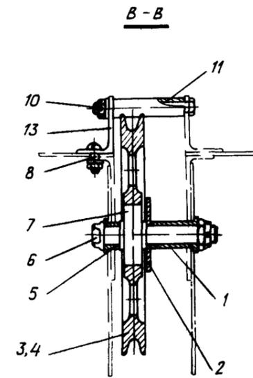
Установка роликов управления элеронами
