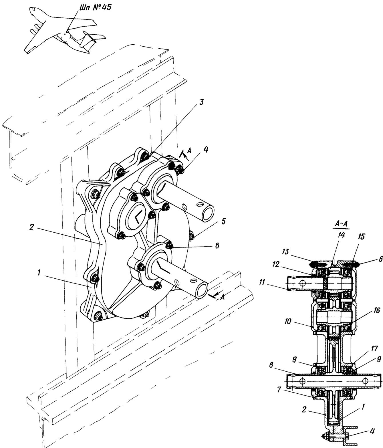
Установка обводного редуктора в фюзеляже
