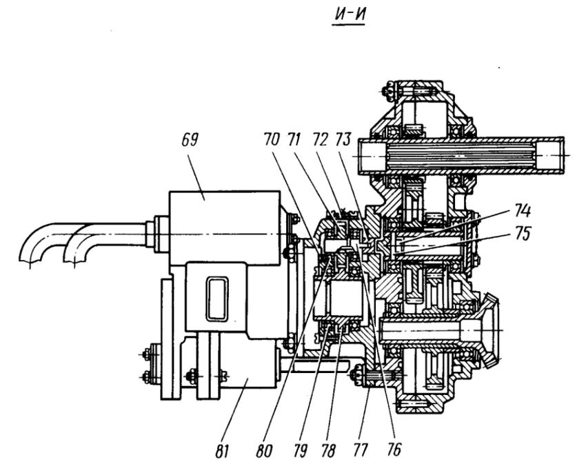
Установка винтовых механизмов
