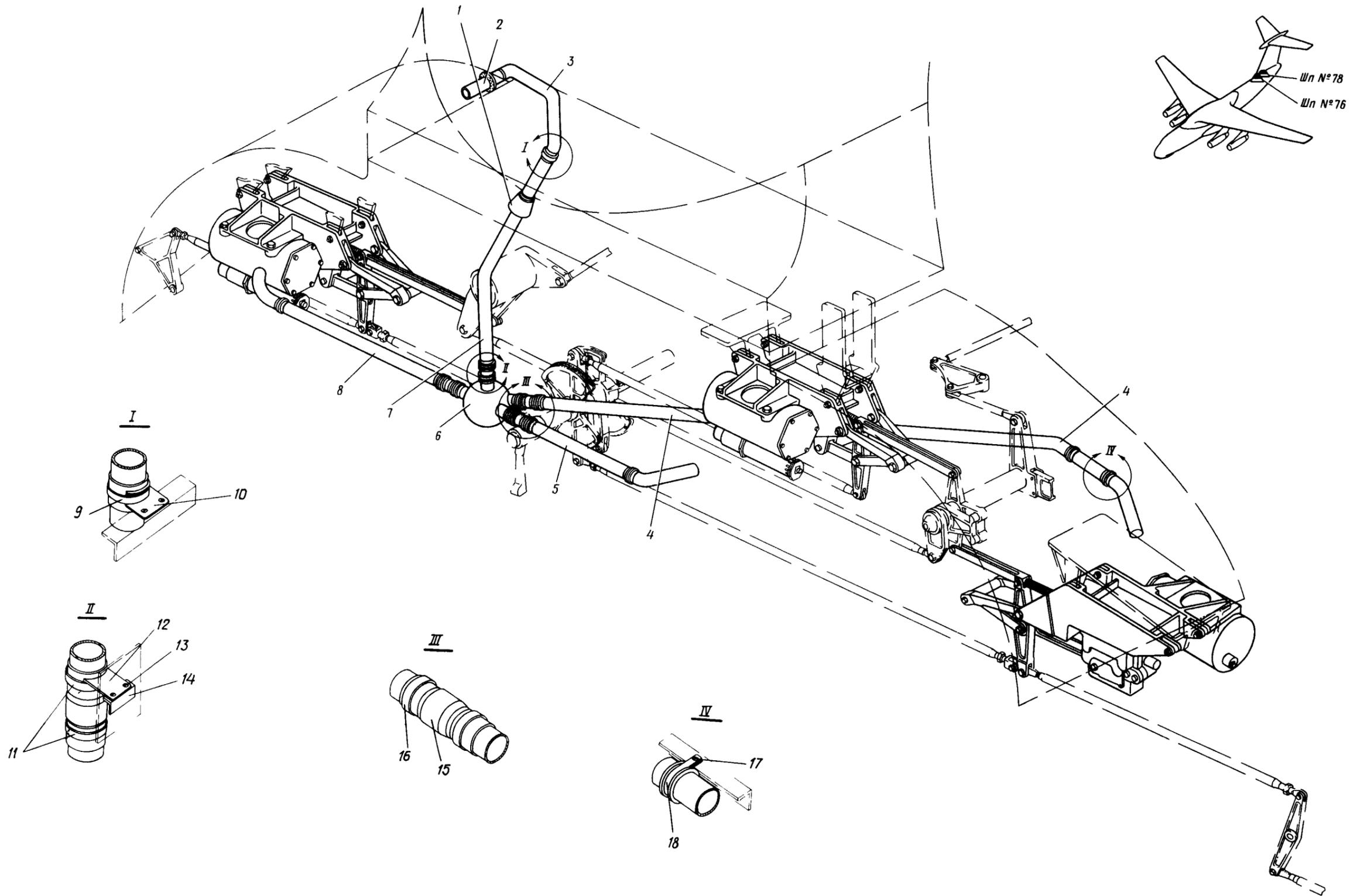
Установка трубопроводов обдува АРМ-62Р в канале РВ
