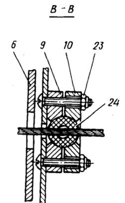
Установка роликов тросов спойлеров на шпангоуте № 41 и панели
