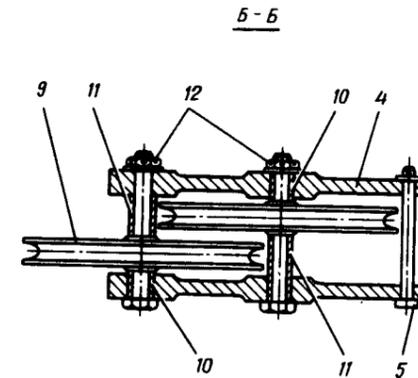
Установка роликов тросов спойлеров на балке пола шпангоута № 7
