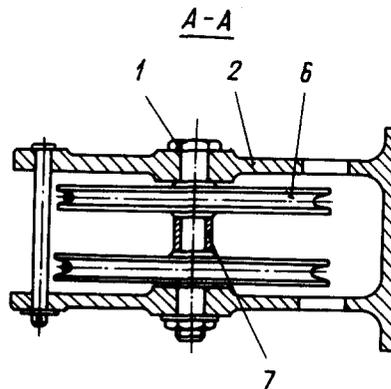
Установка роликов тросов спойлеров на балке пола шпангоута № 13
