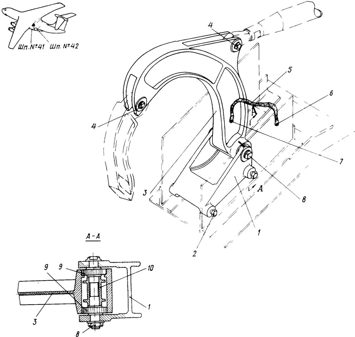
Установка качалки управления элеронами на балке шпангоута № 42
