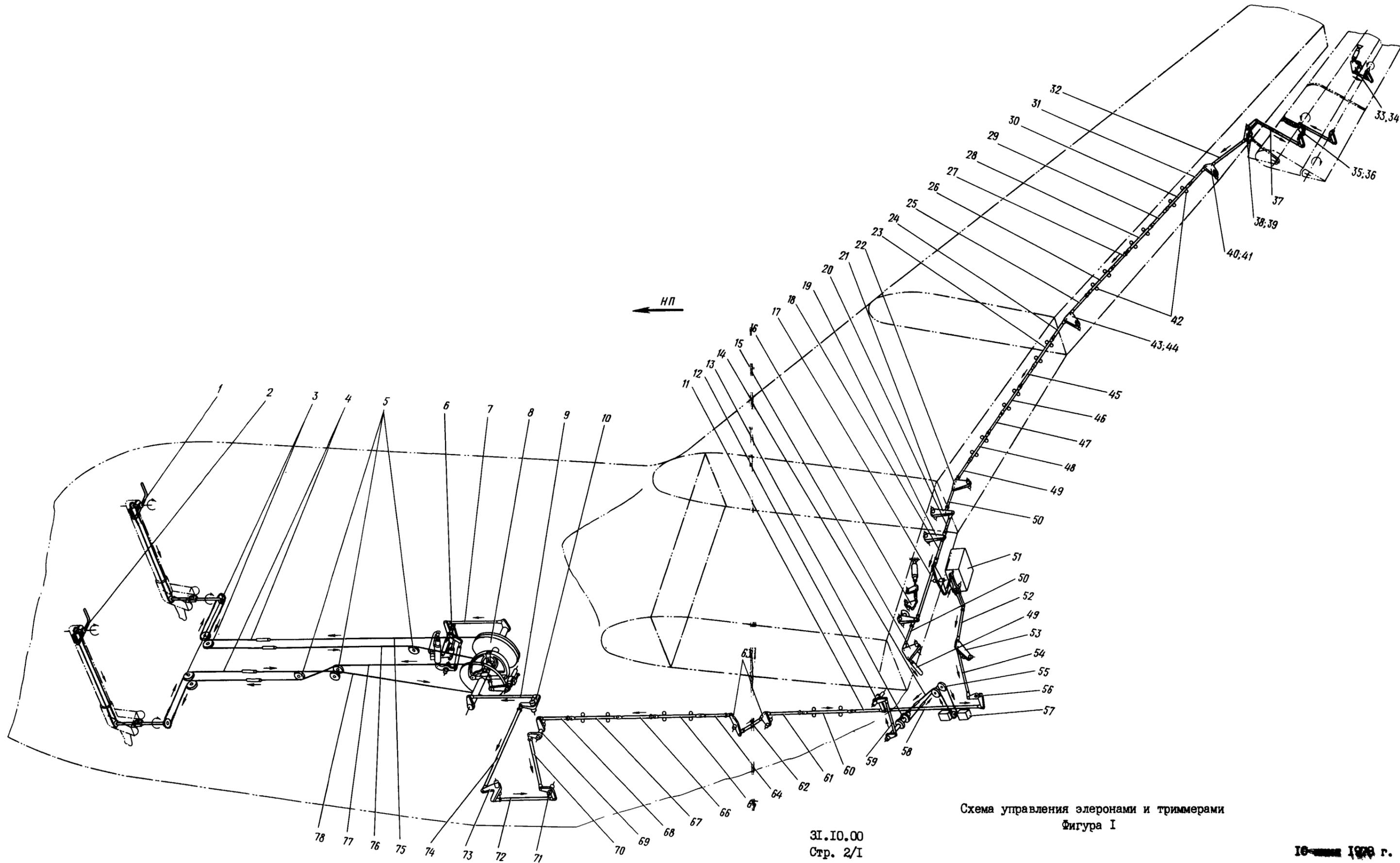
Схема управления элеронами и триммерами
