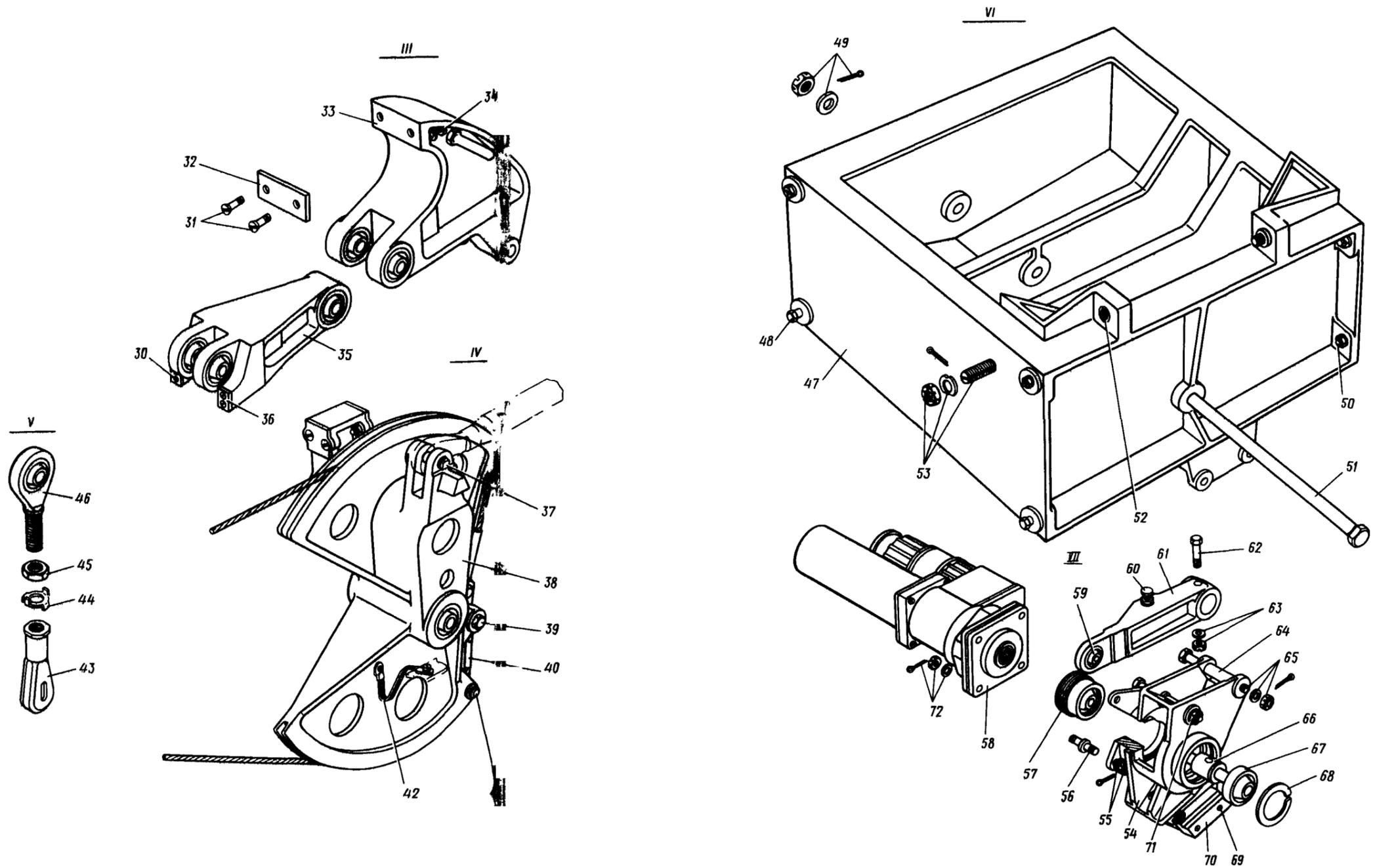
Механизм расщепления проводов управления элеронов и спойлеров
