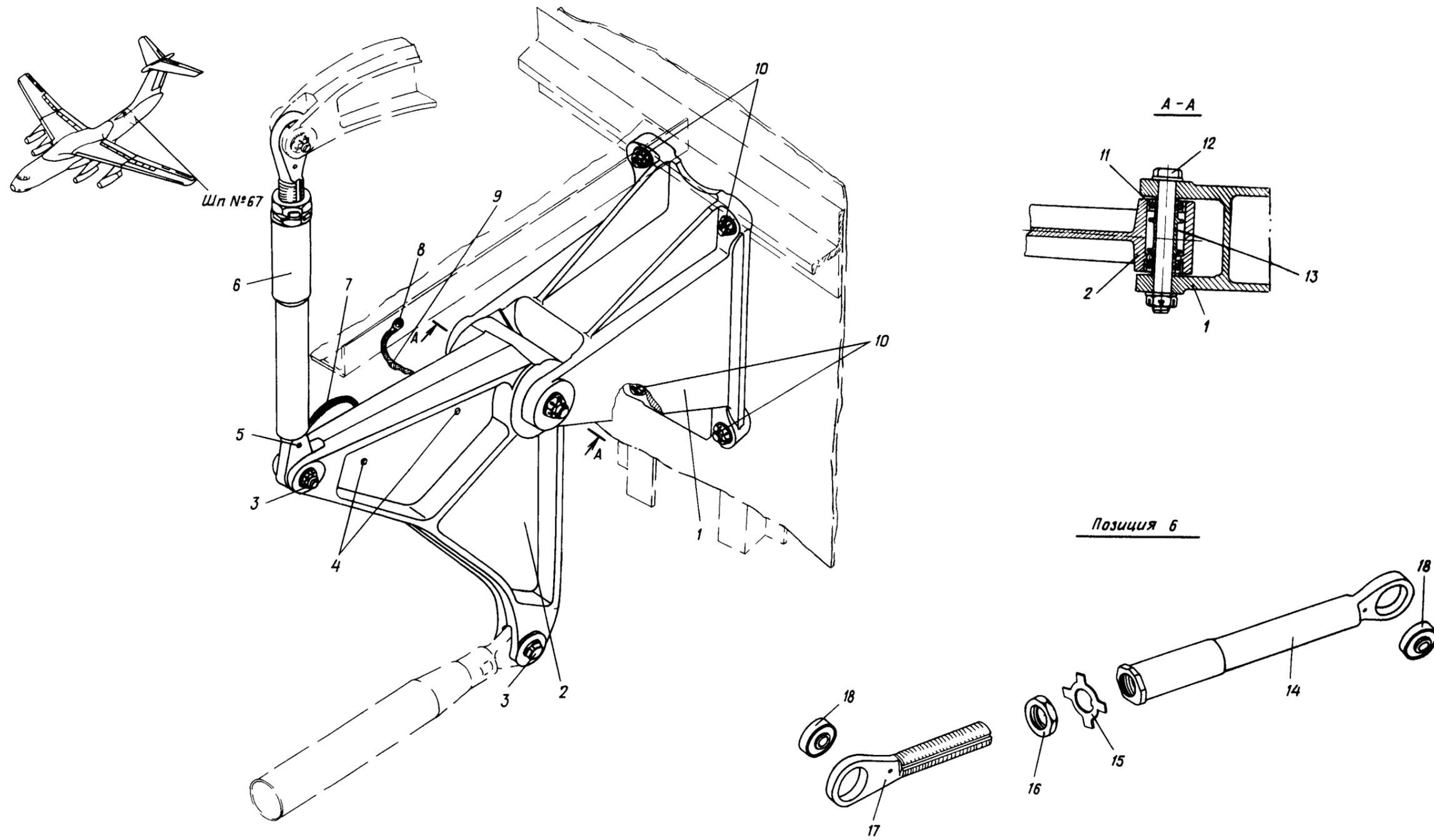
Установка качалки управления РП на шпангоуте № 67
