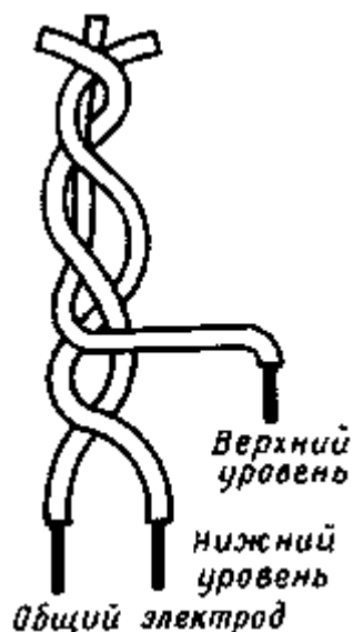
Рис. 4.61. Простая схема электродов из трехжильного изолированного провода для кратковременного слежения за уровнем воды (защита от коррозии не требуется)
