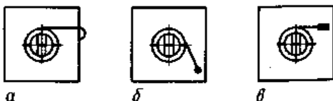
Рис. 6.4. Варианты закрепления пружины якоря электромагнита: а — зацепление за корпус электромагнита; б — введение конца пружины в отверстие; в — припайвание
