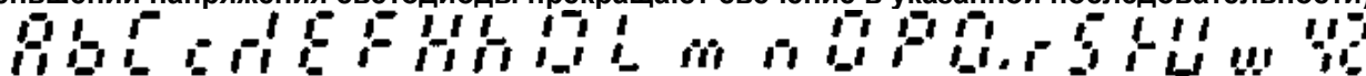
Рис. 4.9. Представление букв на цифровом индикаторе в семисегментном коде (представление букв m и w возможно только при повороте индикатора на 90°)
