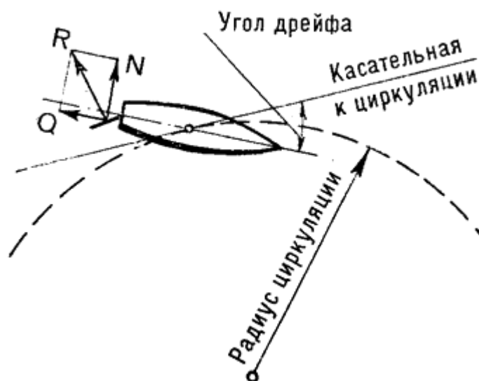
Рис. 83. Схема действия руля
