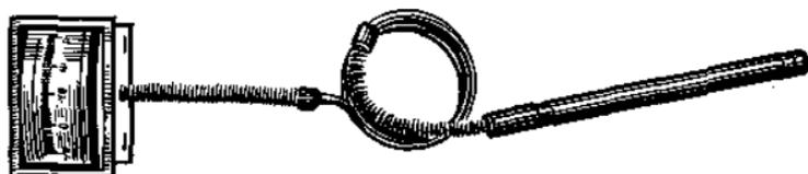
Рис. 7.3. Термометр манометрический показывающий
