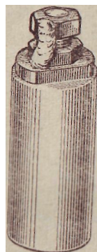
Рис. 3. Толкатели с приваренными к корпусу регулировочными болтами
