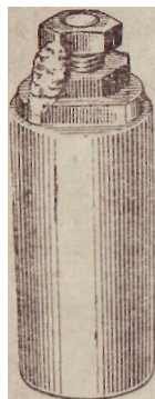
Рис. 3. Толкатели с приваренными к корпусу регулировочными болтами
