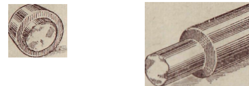
Рис. 5. Обрыв ножки клапана
