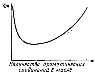
Рис 27. Зависимость скорости окисления масла с парафиновой основой от количества ароматических соединений
