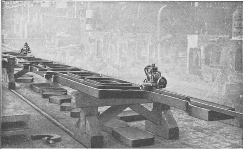
Abb. 218. Ausschneiden von Lokomotivrahmen mit kleinen Schneidmaschinen.
