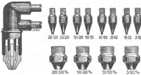
Abb. 208. Heiz- und Schneidmündstücke zum Schneidbrenner der Abb. 207.
