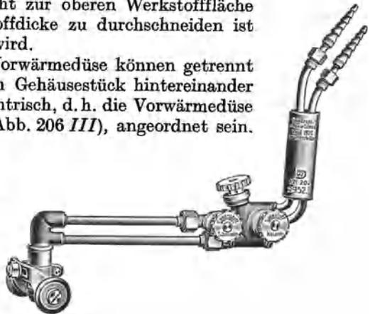
Abb. 207. Schneidbrenner für Wasserstoff-Sauerstoff und Acetylen-Sauerstoff.
