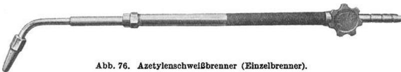
Abb. 76. Azetylschweißbrenner (Einzelbrenner).
