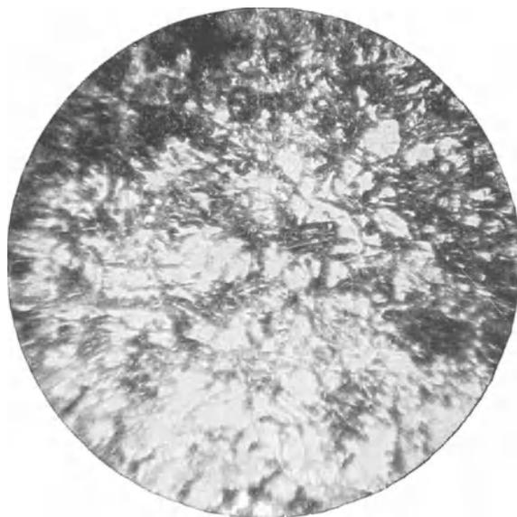
Abb. 196. Grobkörnige Aluminiumschweiße ( $V = 80$ ).
