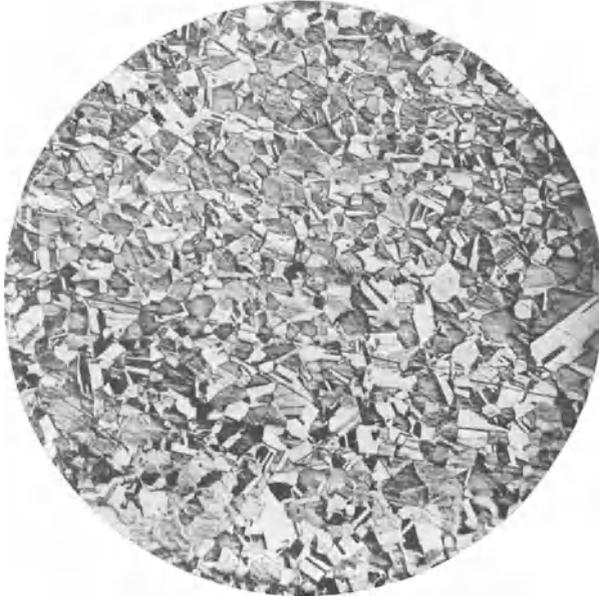
Abb. 193. Kleingefüge von Kupfer, ungeschweißt ( $V = 115$ ).
