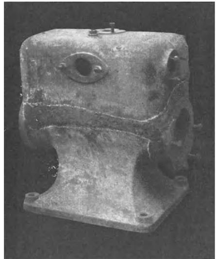
Abb. 160. Geschweißter Kondensatormantel.
