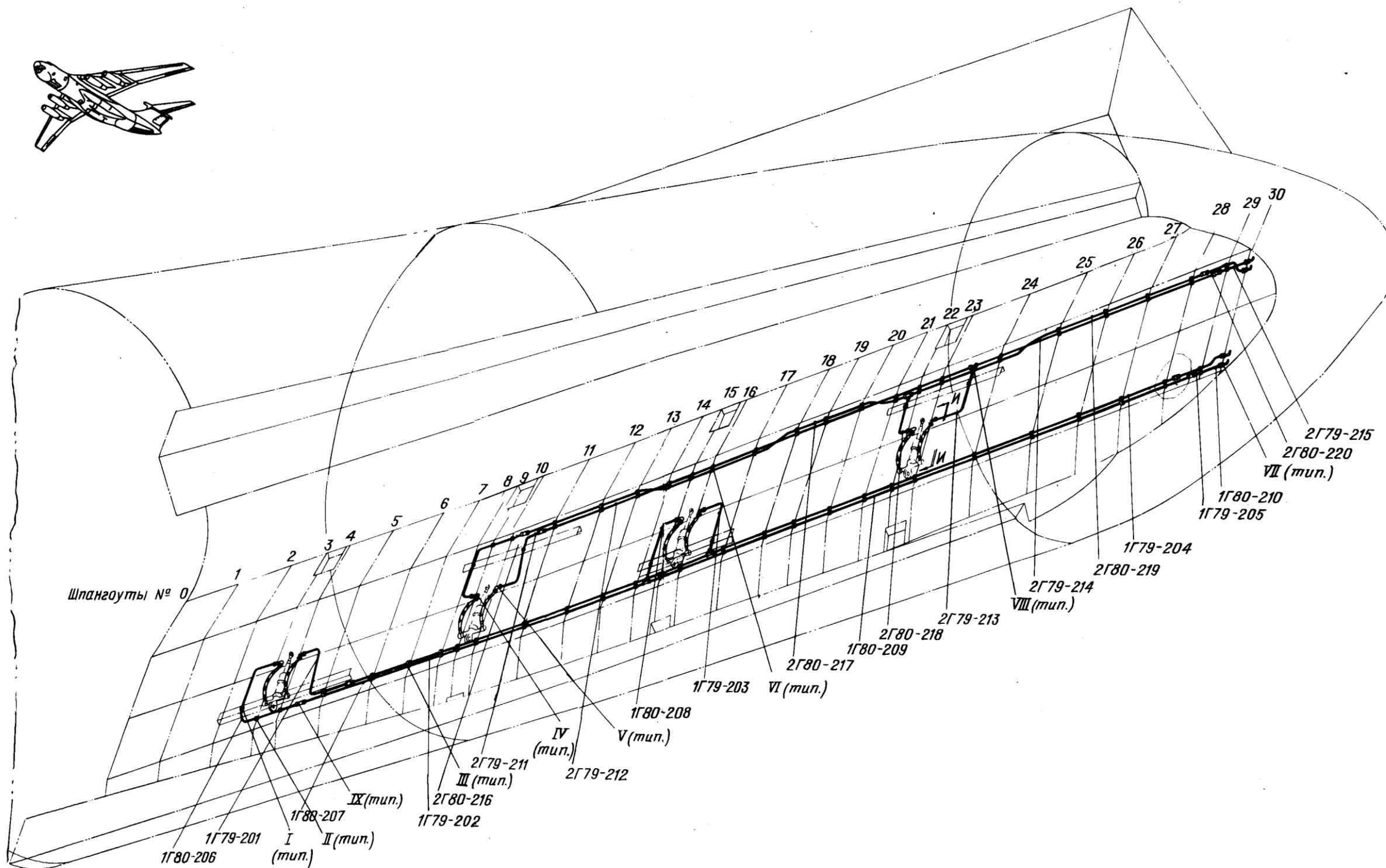
Трубопроводы на средней створке грузового отсека
