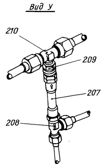
Гидросистема в отсеке главного шасси
