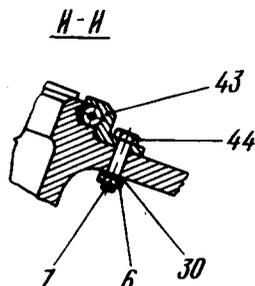
Управление поворотом колес носовой ноги шасси
