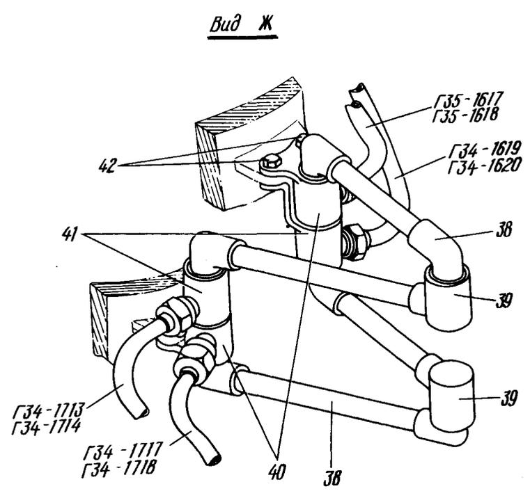
*Типовая сборка шарнира*
