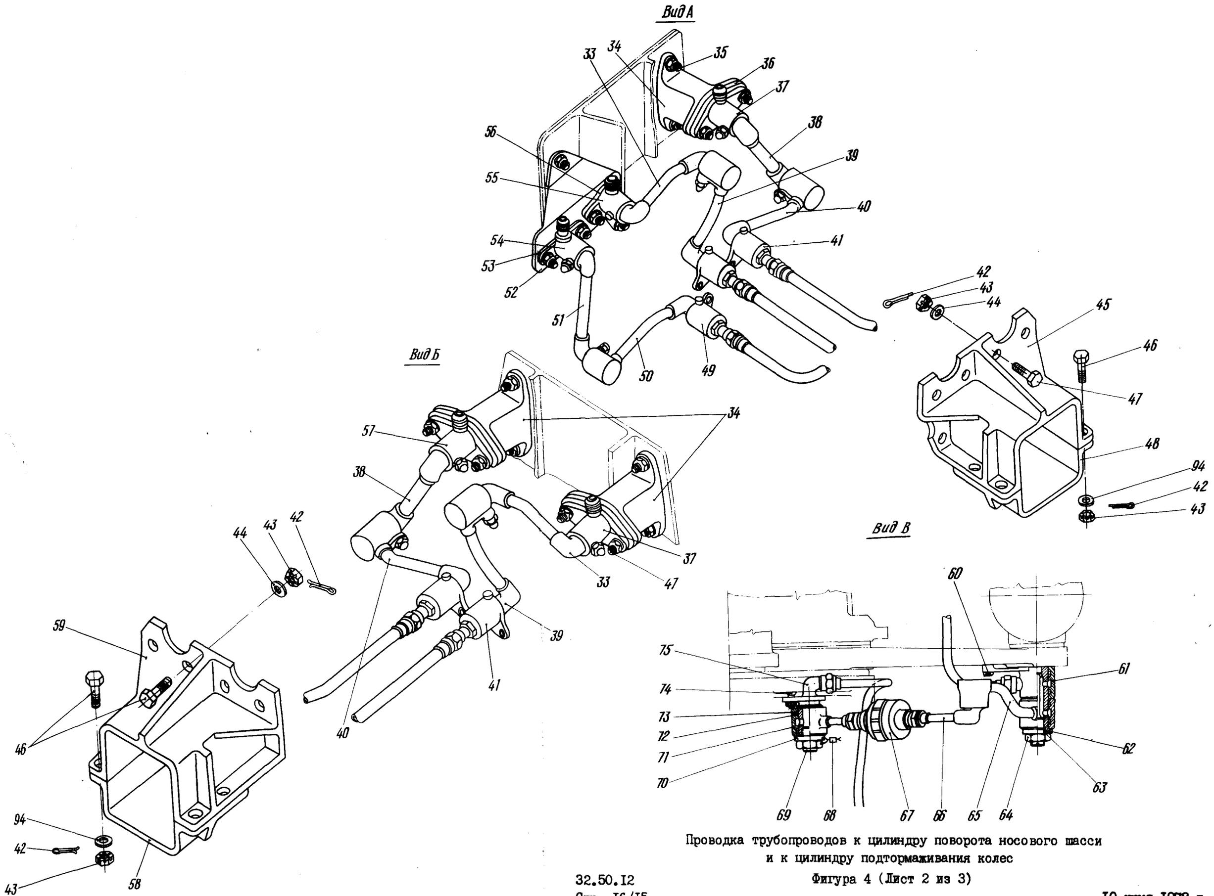
Проводка трубопроводов к цилиндру поворота носового шасси
