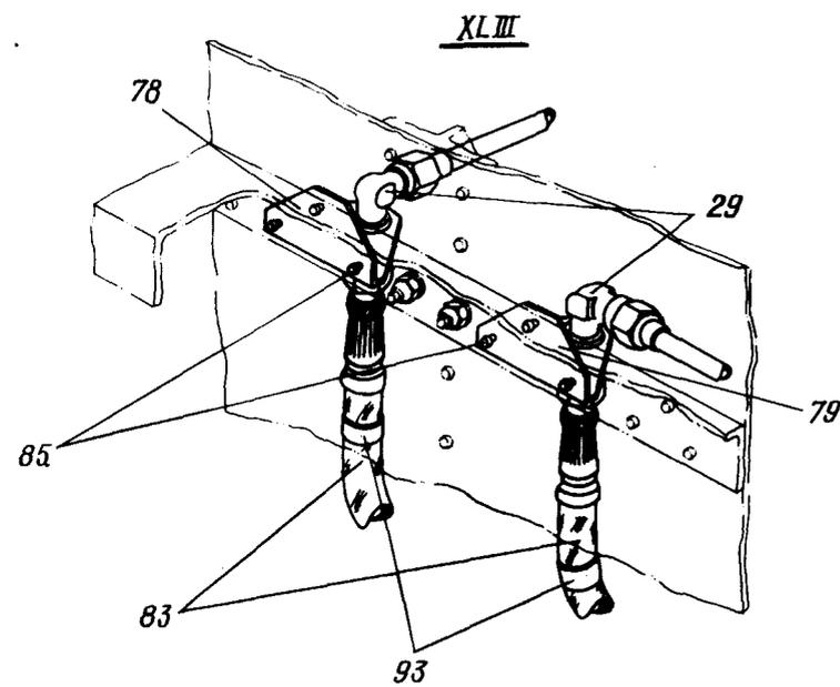
Гидросистема в отсеке носовой ноги шасси
