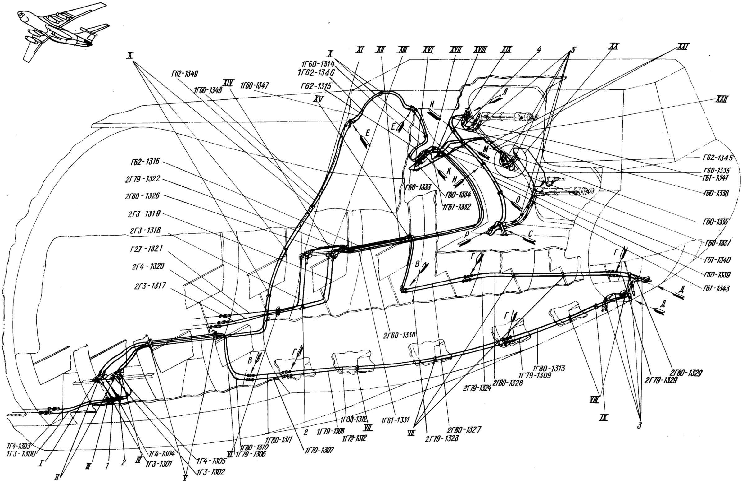
Гидросистема в хвостовой части фюзеляжа
