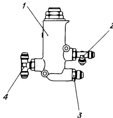
Панель агрегатов стояночного торможения
