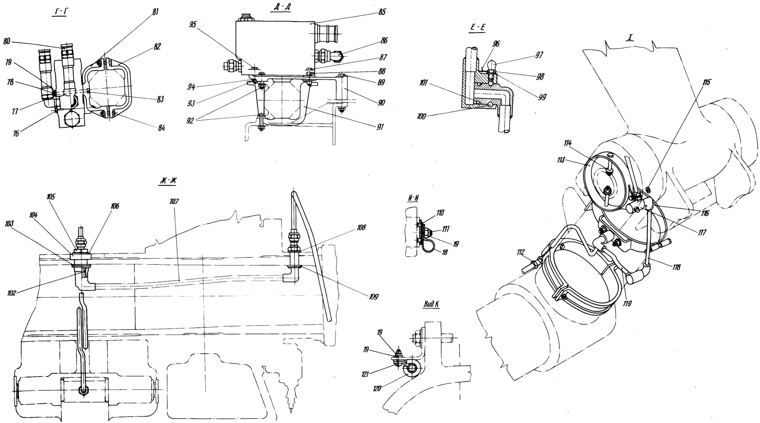
Проводка трубопроводов к цилиндру поворота носового шасси
