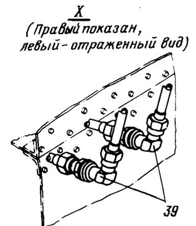
Гидросистема в отсеке носовой ноги шасси
