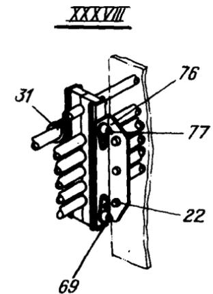
Гидросистема в отсеке носовой ноги шасси
