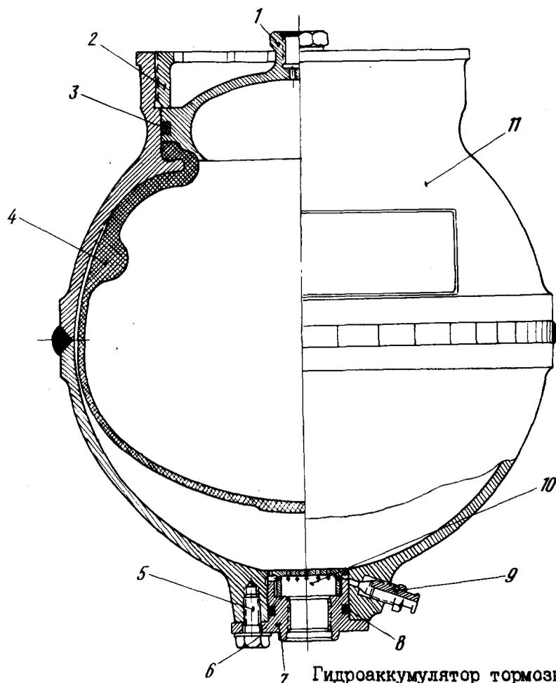
Гидроаккумулятор тормозной системы
