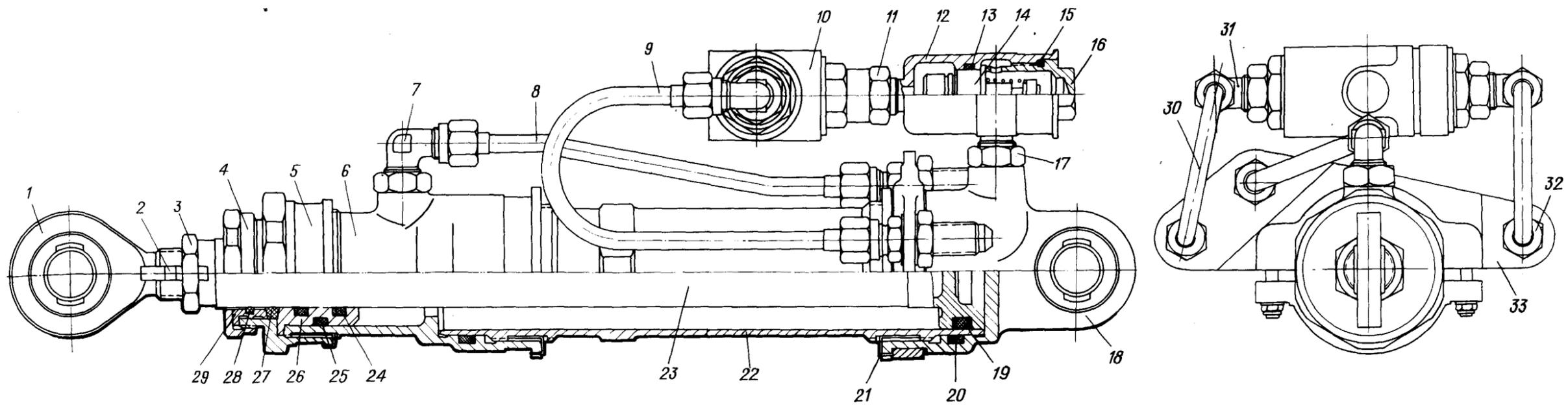
Гидроцилиндр складывающегося подкоса
