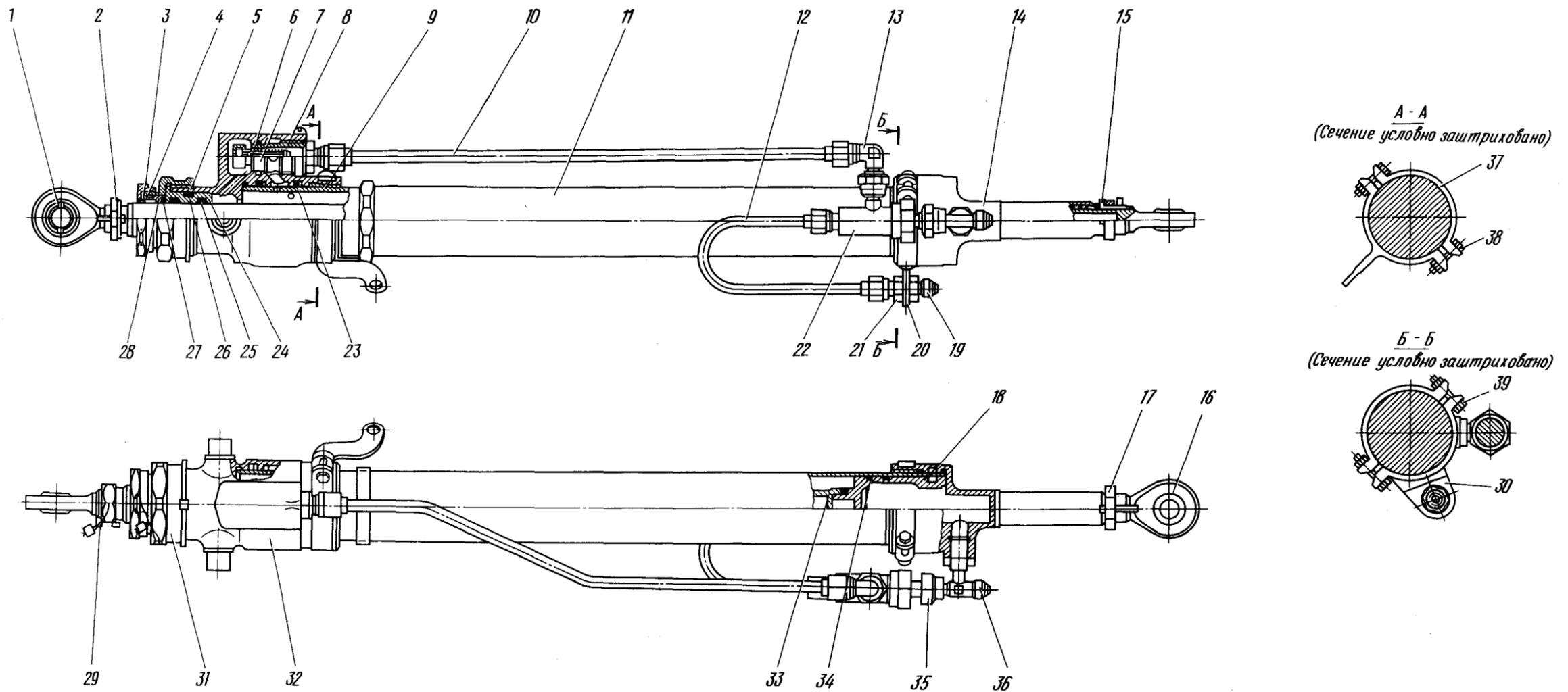
Гидроцилиндр больших створок отсека носовой ноги шасси
