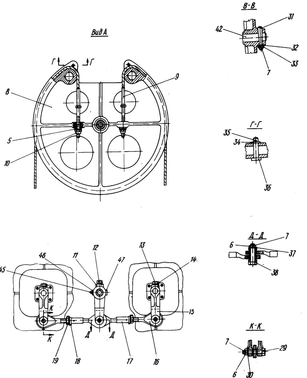
Управление поворотом колес носовой ноги шасси
