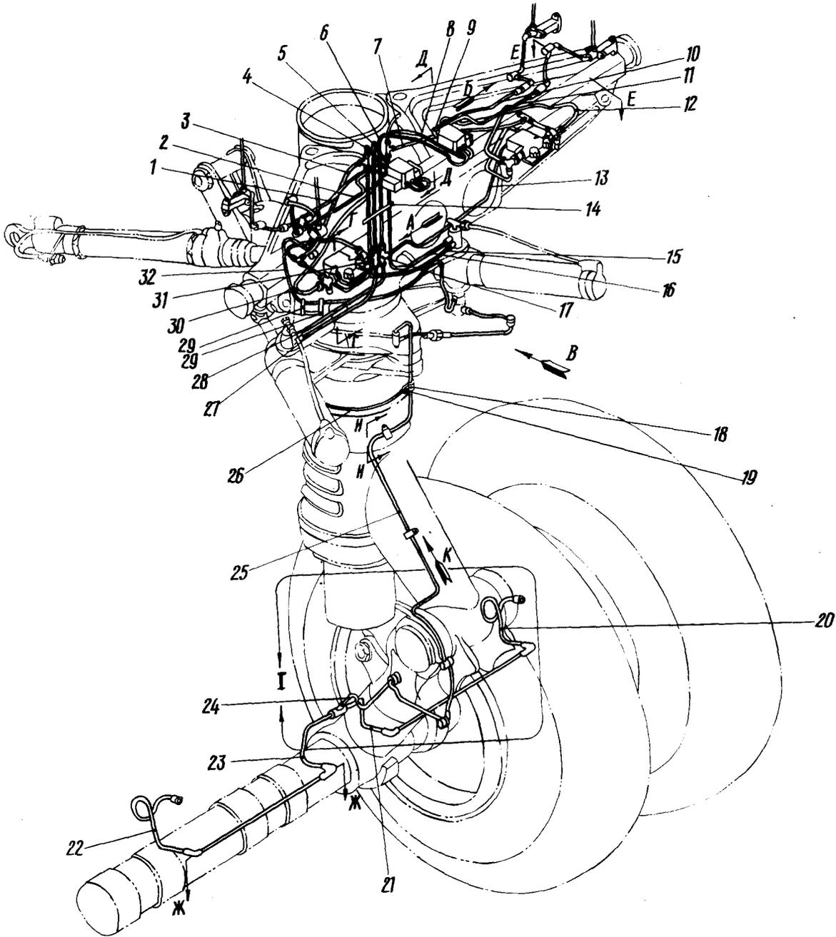
Проводка трубопроводов к цилиндру поворота носового шасси
