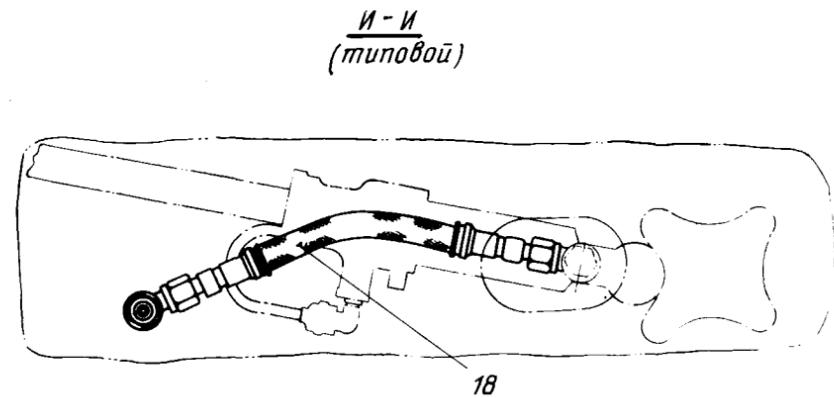
Трубопроводы на средней створке грузового отсека
