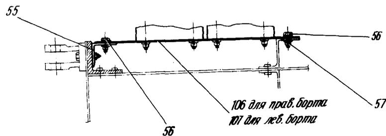
Гидросистема в отсеке носовой ноги шасси
