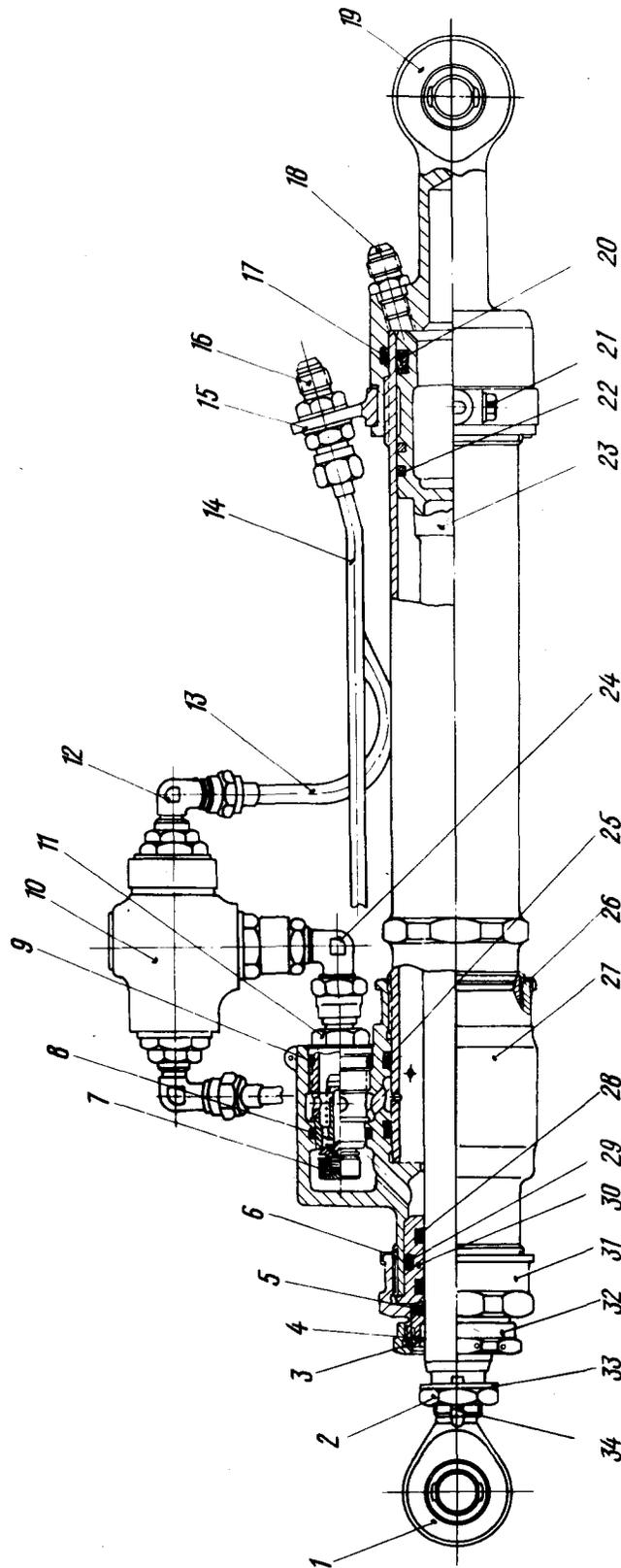
Гидроцилиндр больших створок отсека главной ноги шасси
