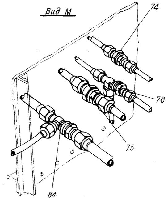
Гидросистема в отсеке главного шасси
