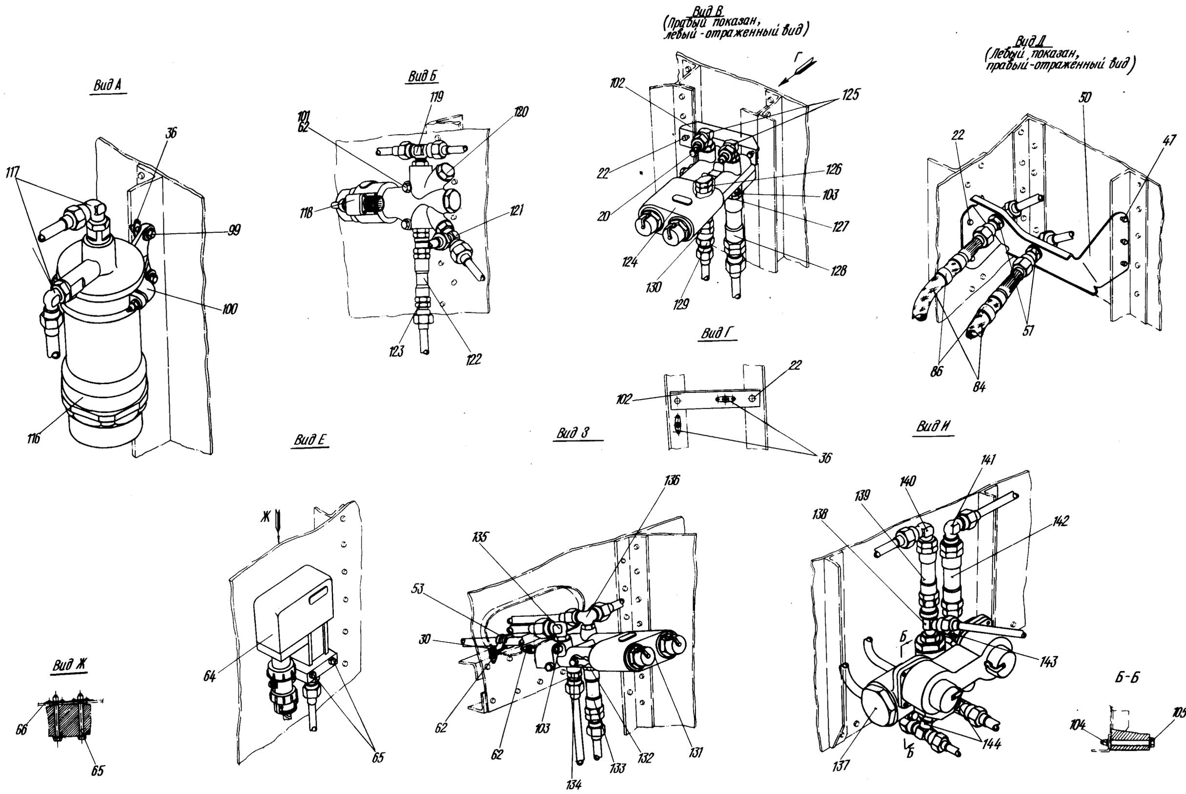
Гидросистема в отсеке носовой ноги шасси
