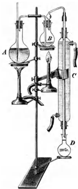
Apparat zur Bestimmung der flüchtigen Säure. Aus Barth „Weinanalyse“.
