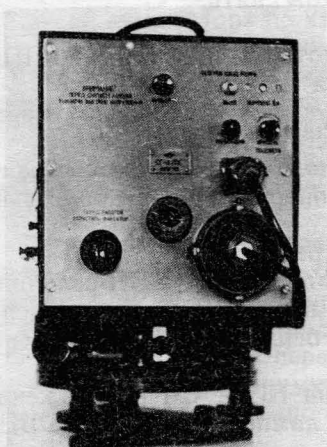
Рис. 18. Исходные положения органов управления на блоках светодальномера СГ-3 (слева — прямо-передающий блок, справа — счетчик, блок управления и блок питания)
