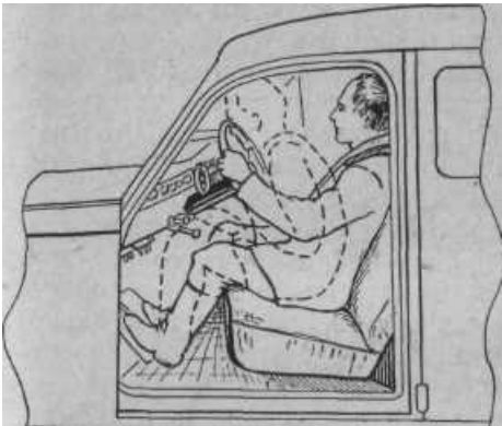
Рис. 32. Механизм травмы водителя в кабине автомобиля. Положение тела перед столкновением автомобиля и в момент столкновения (обозначено пунктиром) (схема).
