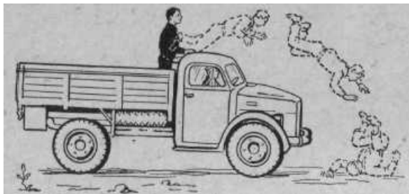
Рис. 19. Механизм травмы пассажира, стоящего в кузове грузового автомобиля у кабины, при экстренном торможении.
