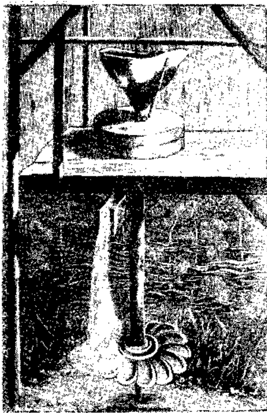
Рис. 98. Мутовчатая мельница — прообраз активной водяной турбины, подучившая широкое распространение в России в XVI веке. — По рисунку XVIII век.
