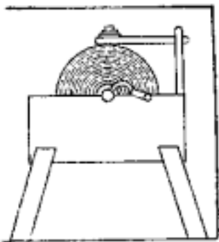
Рис. 30. Прибор для испытания прочисти материалов, изобретенный М. В. Ломоносовым. — По Б. Н. Маншуткину.
