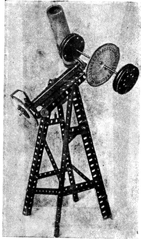
Рис. 41. Модель экваториальной установки из полос „Конструктора“.
