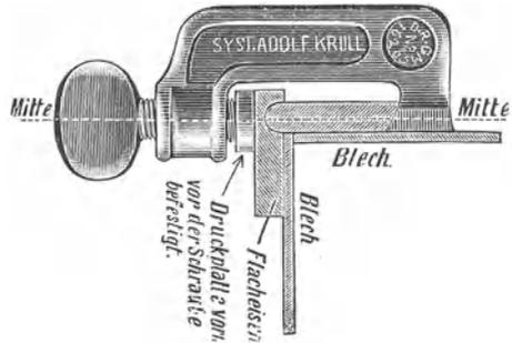
Abb. 39. Wirkungsweise des Schraubzwingenverschlusses.
