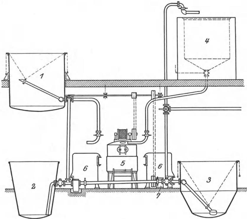
Abb. 29. Seifen-Siede-, -Pump- und Kühlanlage.
