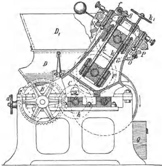
Abb. 168. Pilliermaschine (Seifenreibemaschine) mit 4 Walzen (Vorderansicht).
