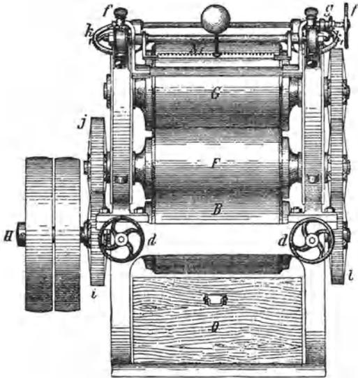
Abb. 167. Piliermaschine (Seifenreibemaschine) mit 4 Walzen (Seitenansicht).
