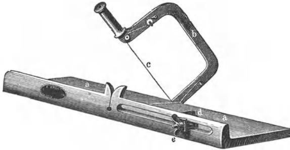
Abb. 76. Kleine Stückenschneidemaschine für den Handverkauf.
