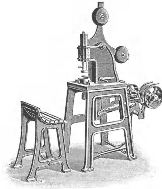
Abb. 81. Pendelschlagpresse für Kraftbetrieb.
