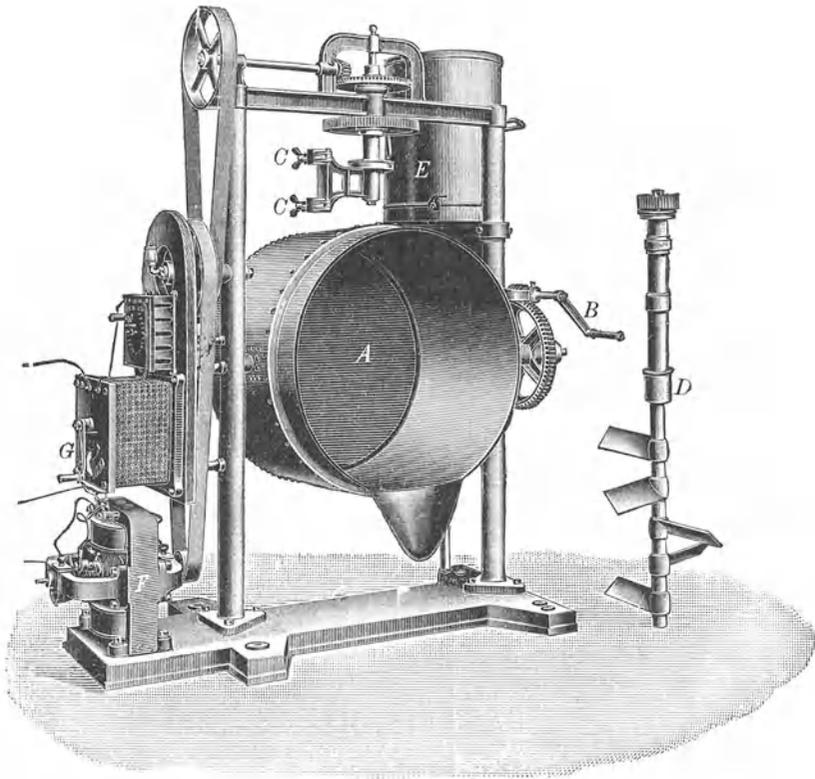
Abb. 151. Doppelwand-Kippkessel mit Dampfheizung und abgenommenen Planetenrührwerk.
