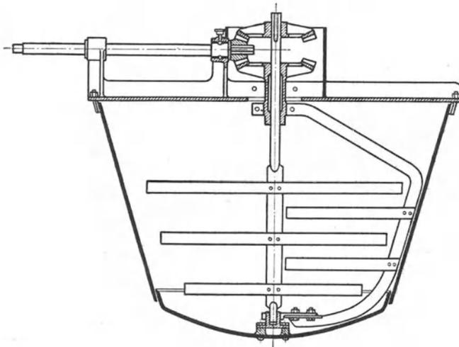
Abb. 22. Rührwerk mit gegenläufiger Bewegung der inneren und äußeren Flügel.
