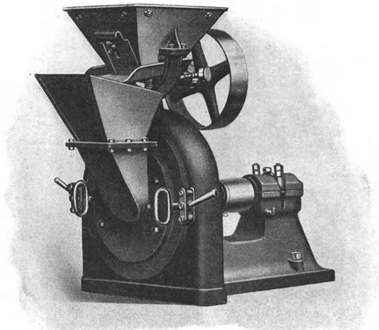
Abb. 110. Seifenpulvermühle mit rotierender Schlagscheibe und automatischem Zuführungsapparat.
