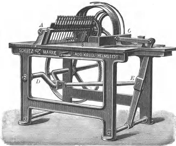
Abb. 65. Riegelschneidemaschine für Kraftbetrieb.
