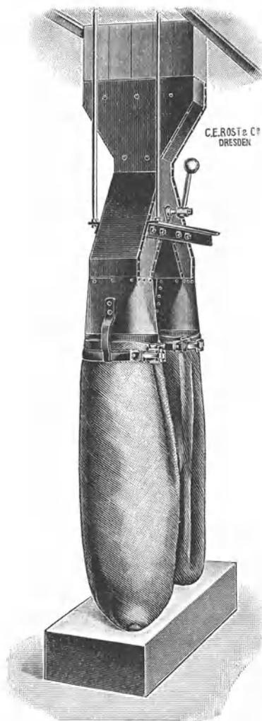
Abb. 112. Absackvorrichtung für Seifenpulver.
