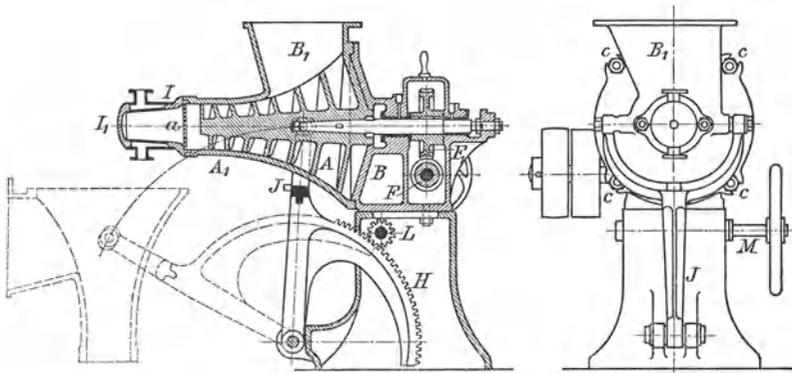
Abb. 170 u. 171. Querschnitt und Rückansicht einer Seifenstrangpresse.
