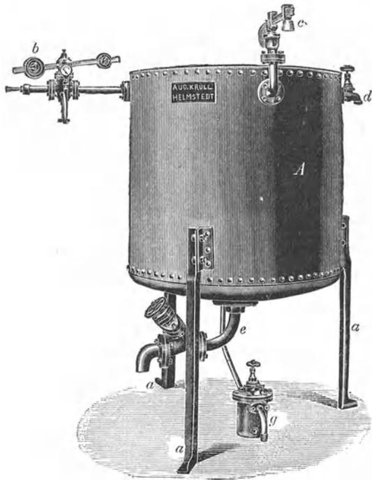
Abb. 142. Doppelwand-Siedekessel für Dampfheizung.
