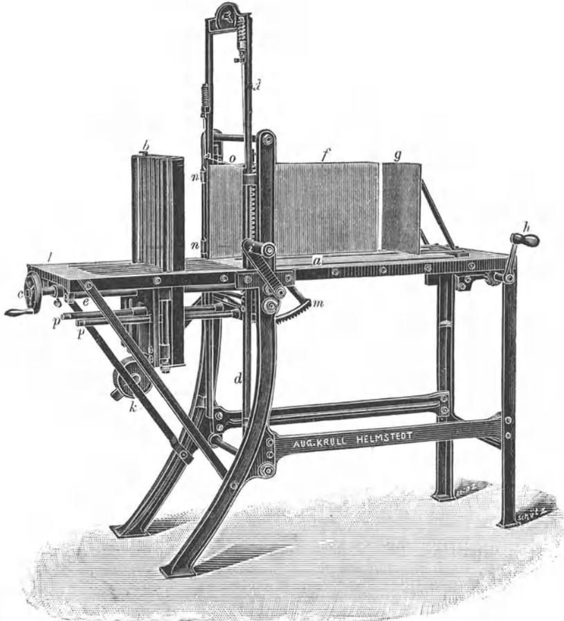
Abb. 71. Stückenschneidemaschine vor dem Schnitt.
