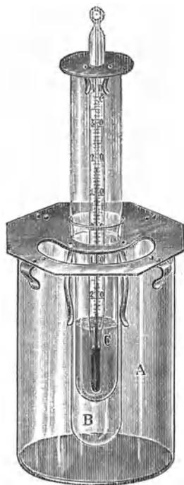
Abb. 127. Apparat zur Bestimmung des Erstarrungspunktes ätherischer Öle.
