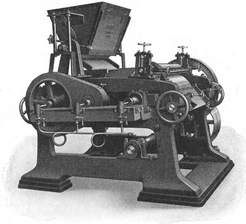
Abb. 121. Dreiwalzwerk in liegender Bauart zur Herstellung von Seifenflocken.
