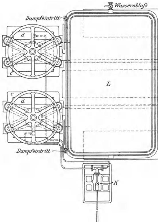
Abb. 97. Hydraulische Seifenkühlpresse von Klump (Grundriß).
