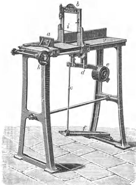
Abb. 74. Kleine Stückenschneidemaschine für Fußbetrieb.
