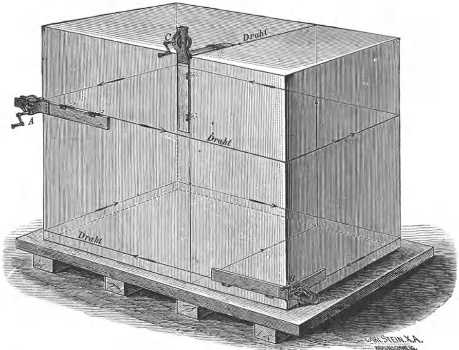
Abb. 49. Zerteilung eines Formblocks mit dem Fällapparat.
