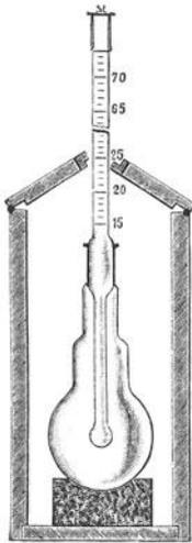
Abb. 4. Apparat zur zolltechnischen Titerbestimmung nach Finkener.
