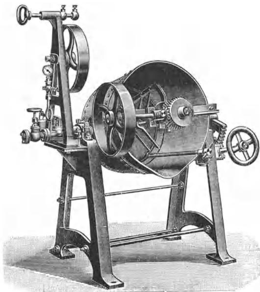
Abb. 149. Doppelwand-Kippkessel mit Dampfheizung und Doppelrührwerk (Innenansicht).
