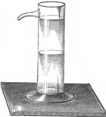
Abb. 125. Standglas zur Trennung von Flüssigkeiten von verschiedenen spezifischen Gewichten.
