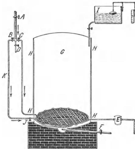
Abb. 15. Siedekessel mit Dampfheizung und Laugenbehälter.
