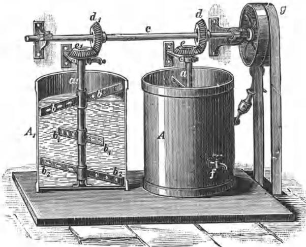
Abb. 137. Schüttelapparat zur Herstellung von Auszügen aus Blumenpomaden.
