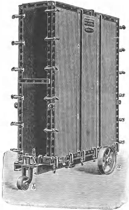
Abb. 44. Fahrbare Seifenform mit Schraubzwingenverschluss.
