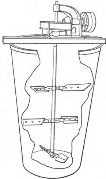
Abb. 21. Freihängendes Rührwerk mit Stahlkugellager.
