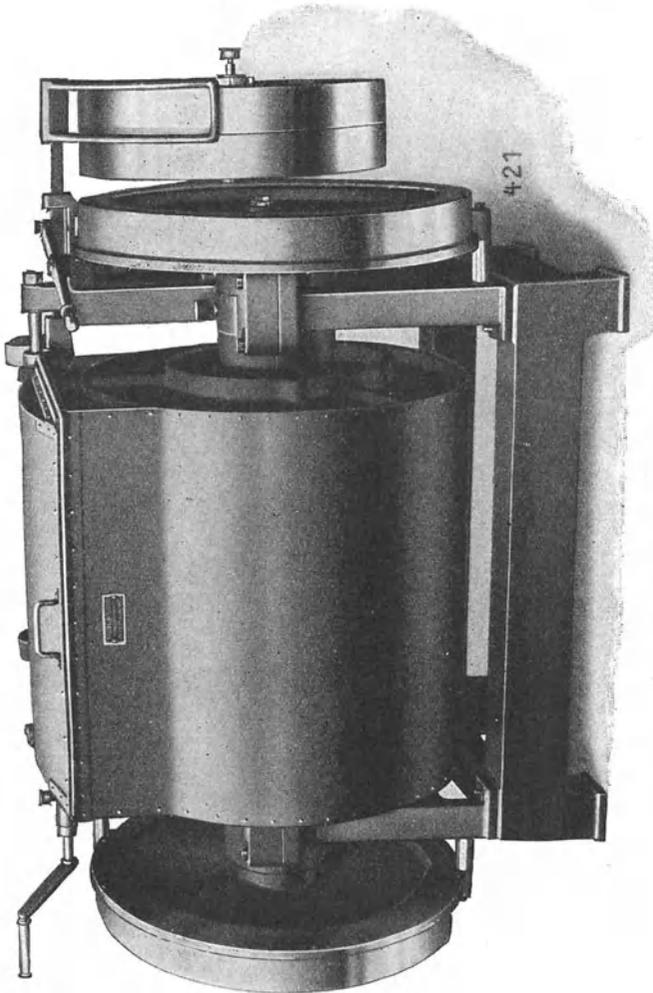
Abb. 164. Mischmaschine für Grundseifenspäne (Arbeitsstellung).
