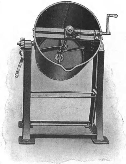
Abb. 25. Kippkessel mit Rührwerk für Handbetrieb.
