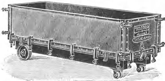
Abb. 45. Fahrbare Seifenform mit Schraubzwingenverschluss.
