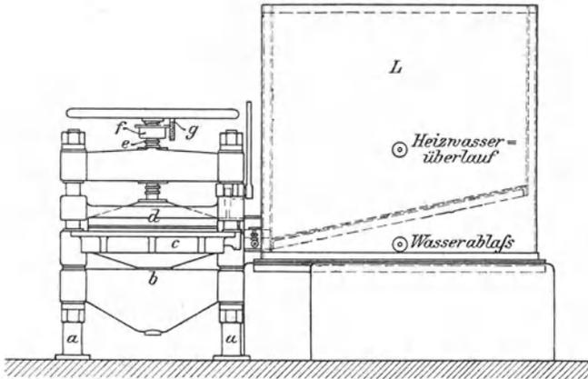
Abb. 96. Hydraulische Seifenkühlpresse von Klump (Aufriß).
