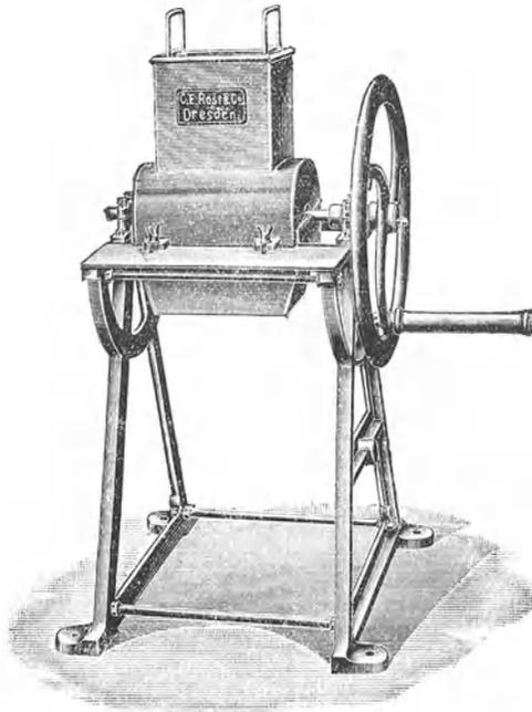
Abb. 106. Seifenreibemaschine für Handbetrieb
