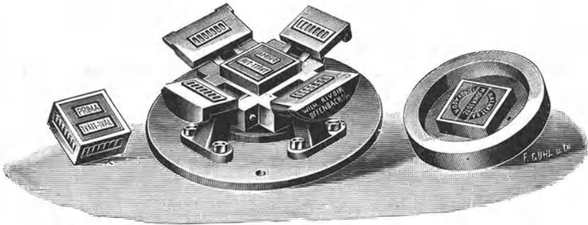
Abb. 94. Automatische, auf sechs Seiten prägende Klappform.
