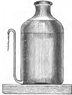
Abb. 124. Flasche zur Trennung von Flüssigkeiten von verschiedenen spezifischen Gewichten.
