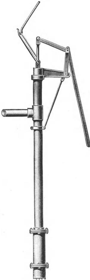
Abb. 30. Handpumpe zum Pumpen von Seifen und Unterlaugen.
