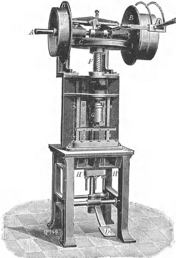
Abb. 83. Friktionsspindelpresse für Kraftbetrieb.
