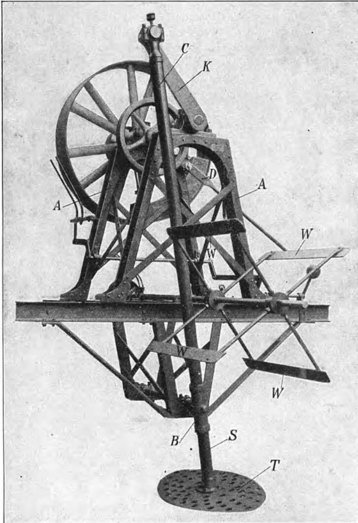
Abb. 18. Krückmaschine.
