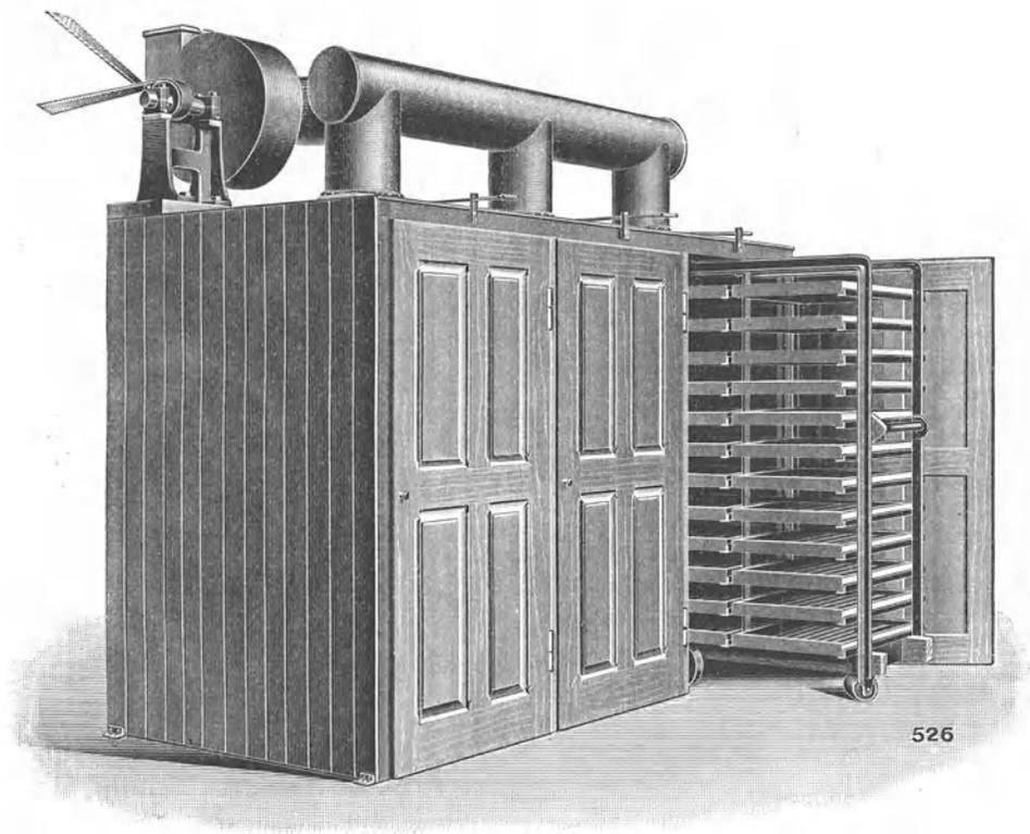
Abb. 156. Trockenkammer mit Ventilator.
