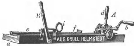
Abb. 160. Seifenkugel-Schneidemaschine.
