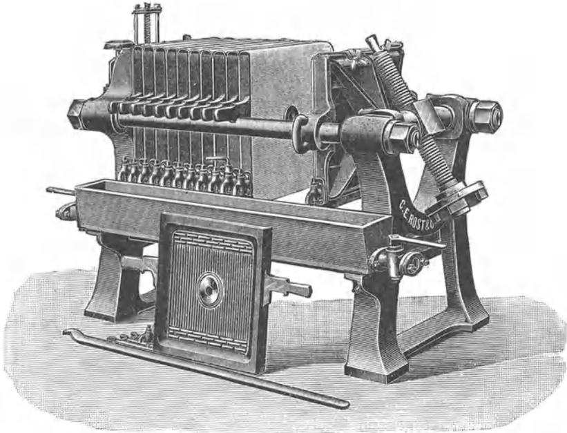
Abb. 120. Filterpresse in geöffnetem Zustande.
