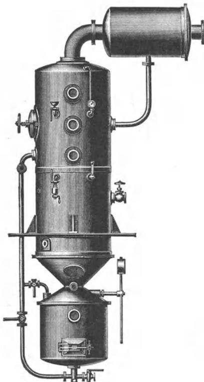
Abb. 116. Vakuumapparat zur Konzentration von Unterlauge mit Salzabscheider.
