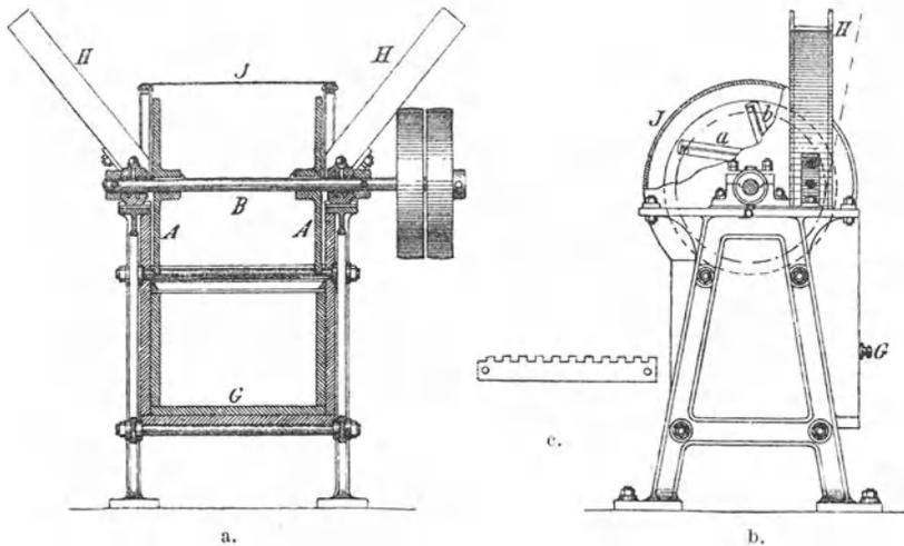
Abb. 163 a—c. Seifenhobelmaschinen für Kraftbetrieb.
