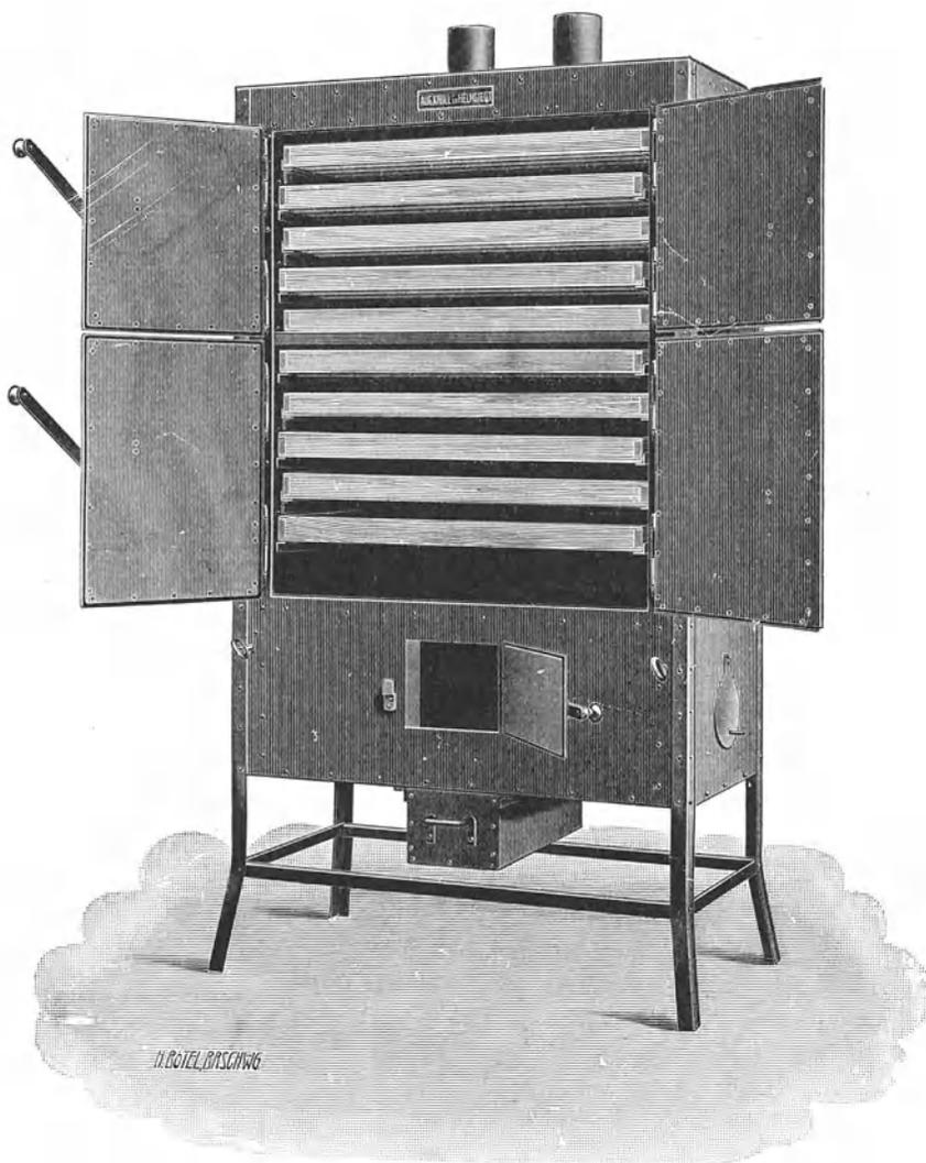
Abb. 155. Feinseifen-Anwärmeofen mit Kohlenheizung.
