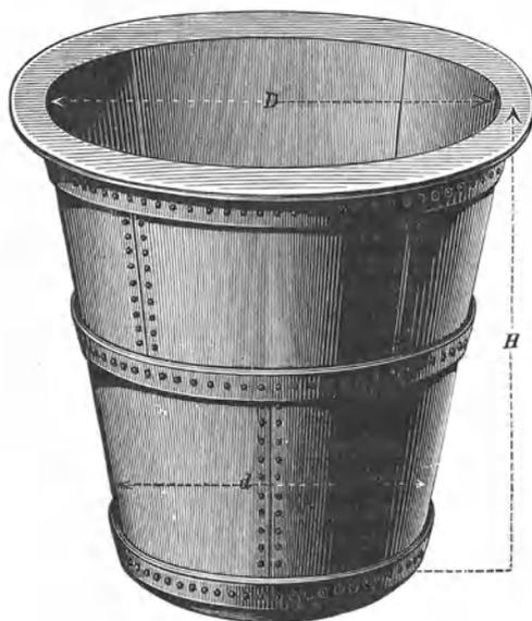
Abb. 10. Kegelförmiger Siedekessel.
