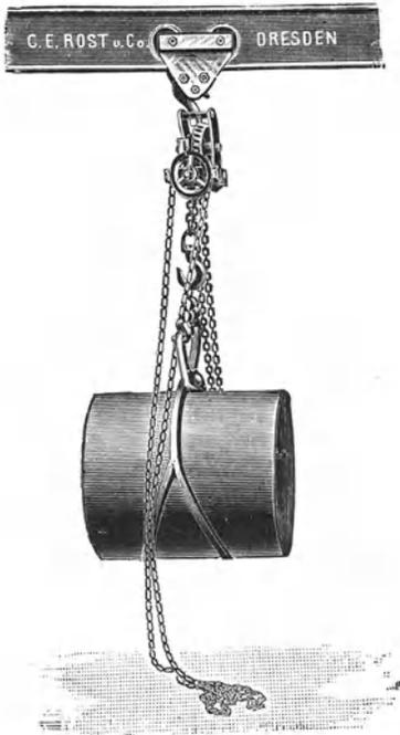
Abb. 8. Vorrichtung zum Auflösen der Trommelsoda.
