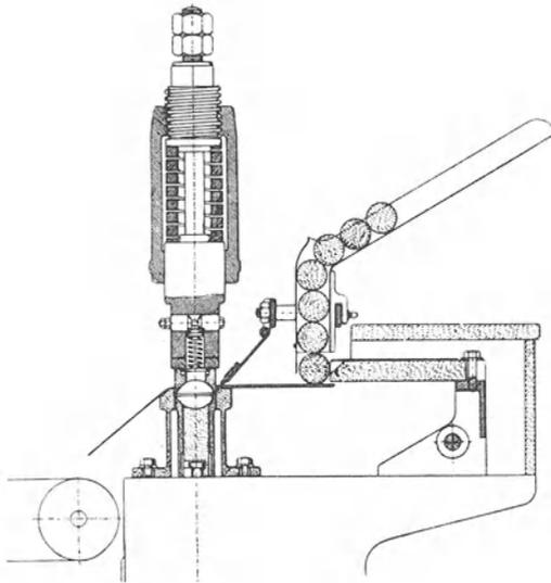
Abb. 85. Ausstoßvorrichtung der Autopresse.
