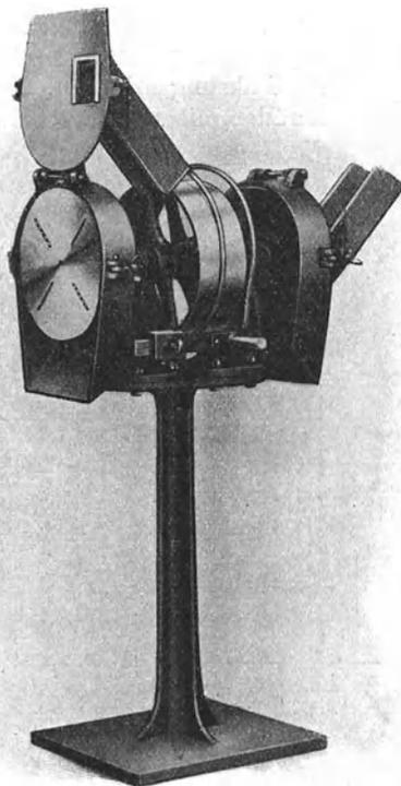
Abb. 162. Seifenhobelmaschine für Kraftbetrieb.
