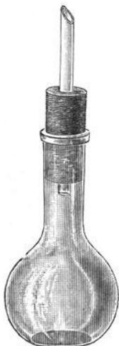
Abb. 131. Kölbchen zur Bestimmung der Verseifungszahl ätherischer Öle.
