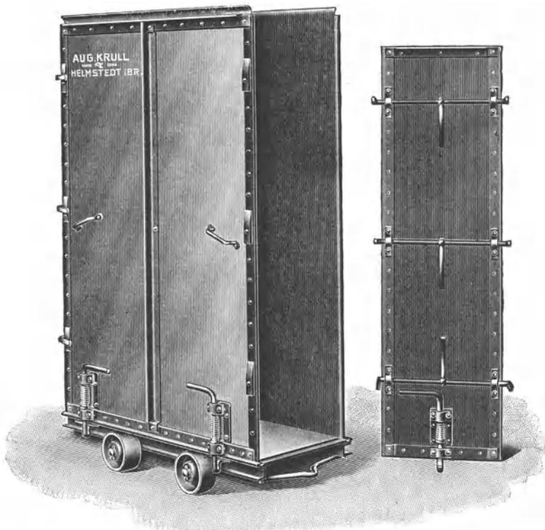
Abb. 43. Seifenform mit Momenthebelverschluss, geöffnet.
