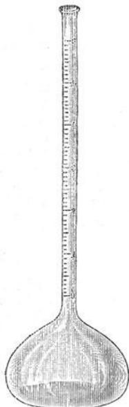
Abb. 133. Kölbchen zur Bestimmung des Zitratgehaltes ätherischer Öle.
