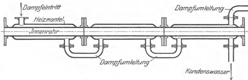
Abb. 35. Rohrleitung mit Dampfmantel zur Beförderung von leicht erstarrenden Flüssigkeiten. (Seifen, Fetten u. dergl.)
