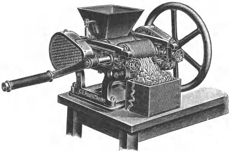
Abb. 166. Piliermaschine (Seifenreibmaschine) für Versuchszwecke.
