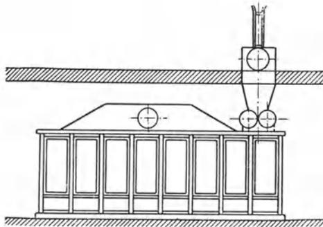
Abb. 177. Trockenapparat mit Aufgabe von Seifenplatten oder Riegeln von dem über dem Apparat gelegenen Stockwerk aus.
