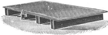
Abb. 41. Formboden mit Laugenablaßvorrichtung.
