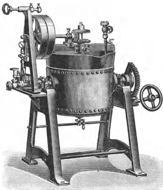
Abb. 148. Doppelwand-Kippkessel mit Dampfheizung und Doppelrührwerk.
