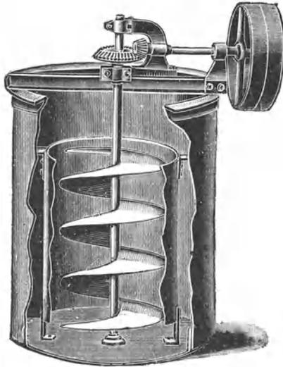
Abb. 23. Schneckenrührwerk.
