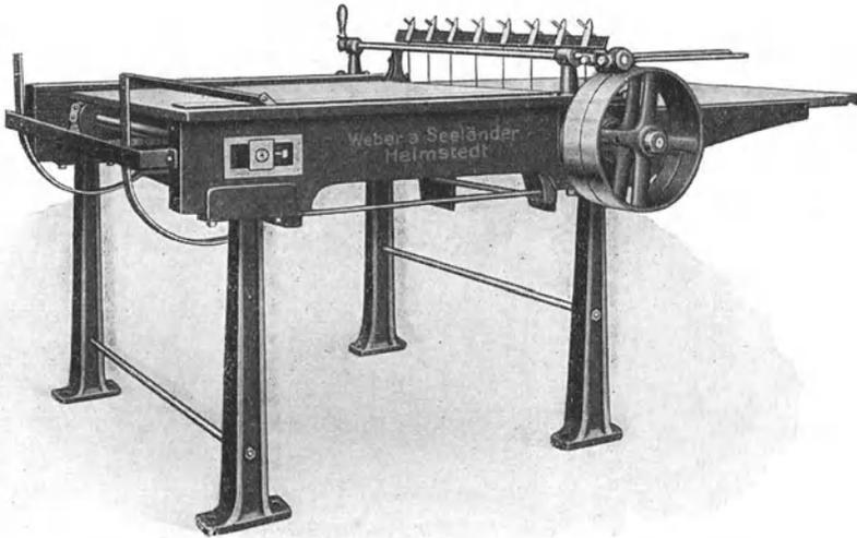
Abb. 73. Kontinuierlich arbeitende Stückenschneidemaschine für Kraftbetrieb.
