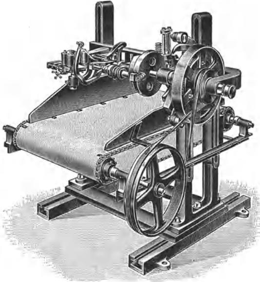
Abb. 176. Automatische Stückenschneidemaschine.
