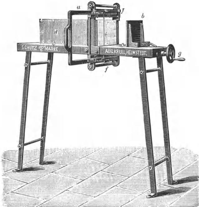
Abb. 75. Kleine Stückenschneidemaschine für Handbetrieb.
