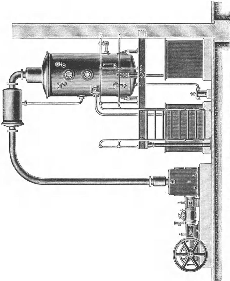
Abb. 118. Komplette Vakuumverlampfanlage für Glycerinwasser.
