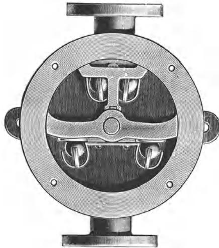
Abb. 31. Handflügelpumpe (geöffnet).
