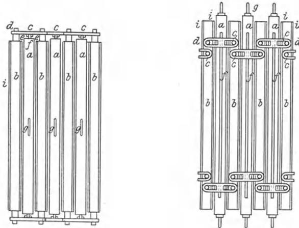
Abb. 101. a) Seitenansicht, b) Aufsicht der Kühlplatten der Schrauth'schen Plattenkühlmaschine.
