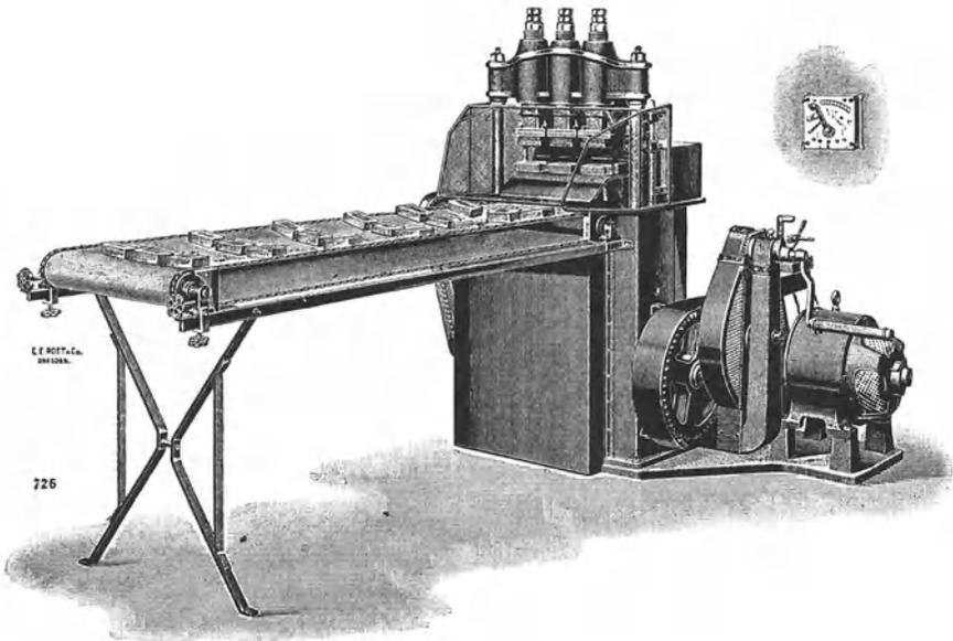
Abb. 86. Automatische Presse mit 3 Stanzen.
