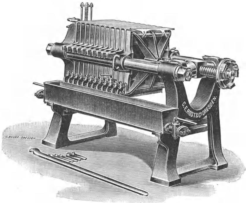
Abb. 119. Filterpresse zum Betriebe bereit gestellt.
