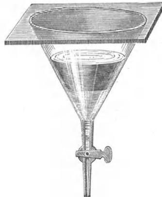
Abb. 126. Scheidetrichter zur Trennung von Flüssigkeiten von verschiedenen spezifischen Gewichten.
