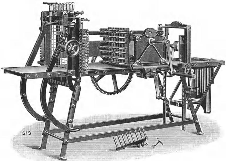
Abb. 72. Kombinierte Riegel- und Stückenschneidemaschine.
