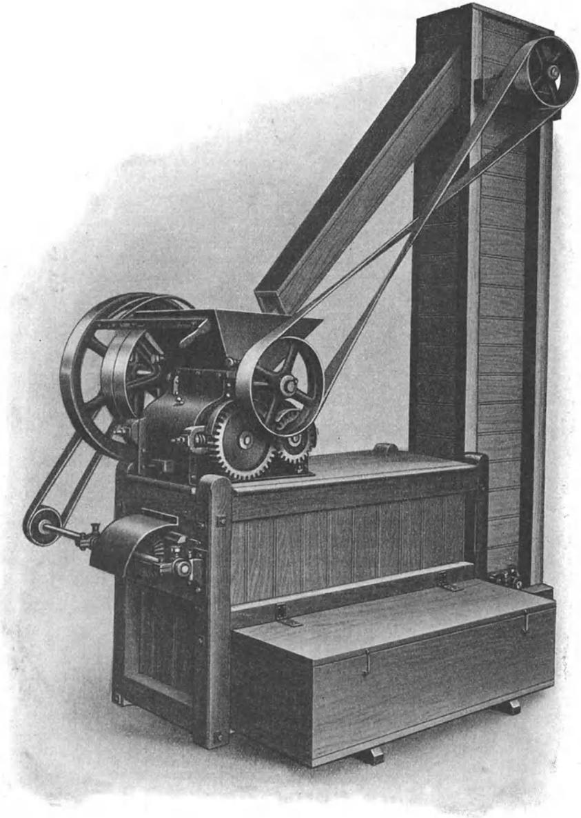
Abb. 109. Seifenpulvermühle mit eingebautem Siebwerk.
