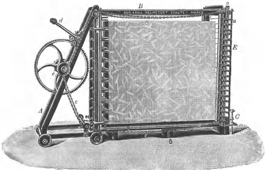
Abb. 66. Formblock-Schneidemaschine.
