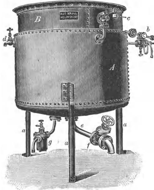
Abb. 143. Doppelwand-Siedekessel mit niedrigem Außenmantel.
