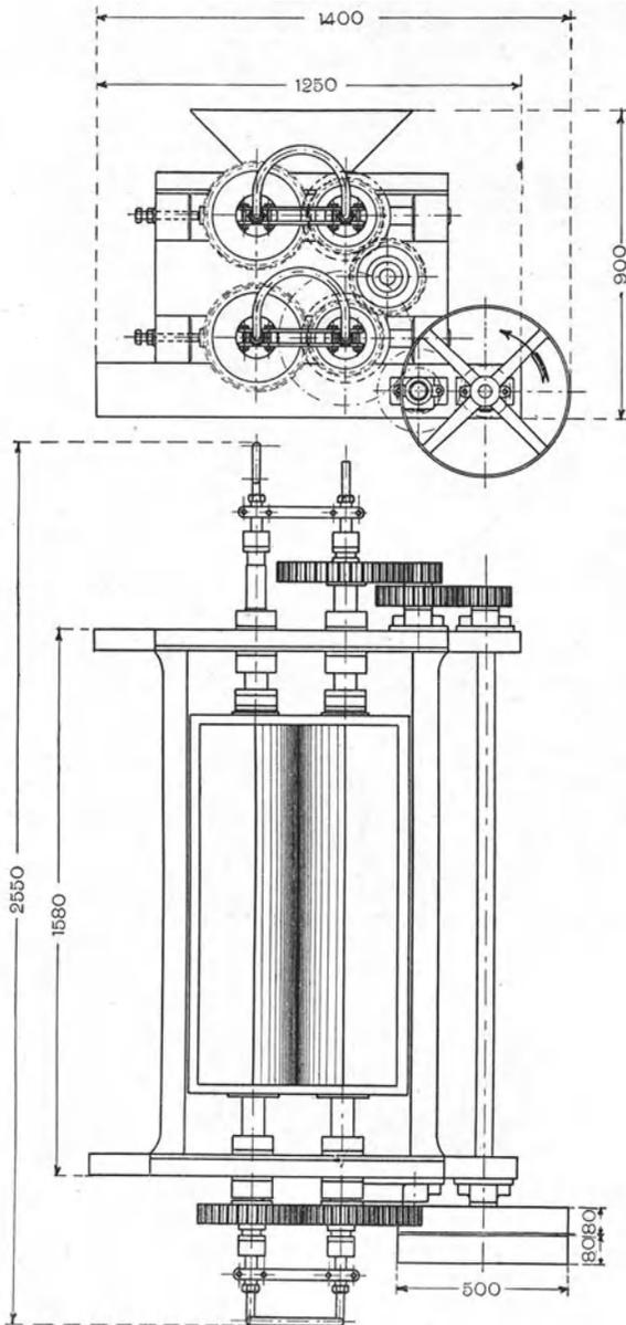
Abb. 180. Kühlwalzwerk für flüssige Grundseife.
