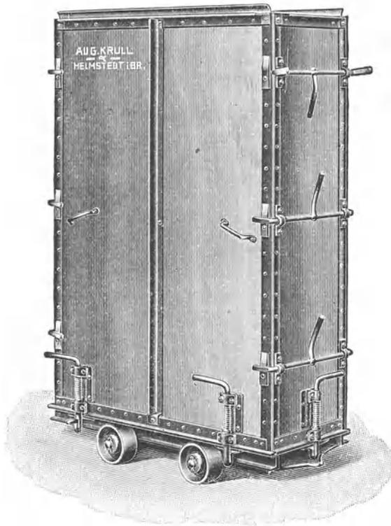
Abb. 42. Seifenform mit Momenthebelverschluss, geschlossen.
