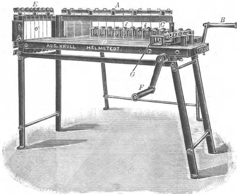
Abb. 68. Schneidemaschine zur Verarbeitung von Einzelplatten.
