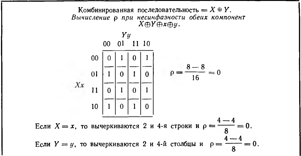
Рис. 5.8. Автокорреляционная функция комбинированной последовательности, не имеющая дополнительных пиков
