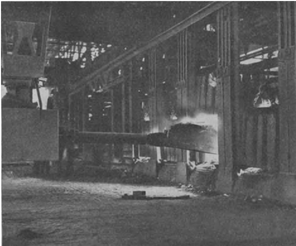
Abb. 45. Beschicken eines Siemens-Martinofens (Beratungsstelle für Stahlverwendung).
