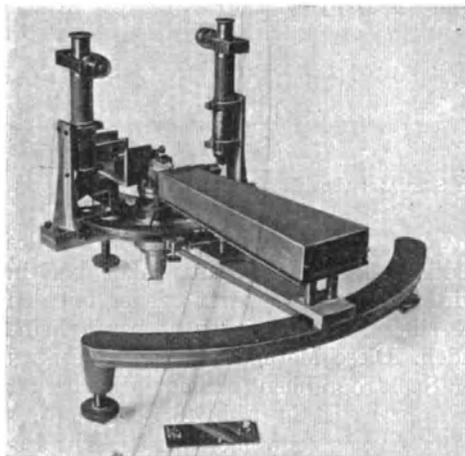
Abb. 49. Röntgenspektrograph von SIEGBAHN und JÖNSSON
