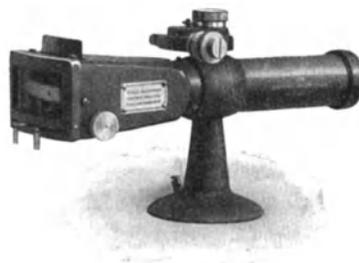
Abb. 51. Röntgenspektrograph von MARCH, STAUNIG und FRITZ
