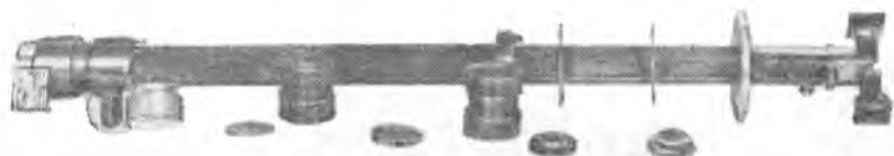
Рис. 6.1. Сверхпроводящие СВЧ резонаторы (рабочая частота 10 ГГц, тип колебаний H_{011} , рабочая температура 4,2—1,65 К, добротность резонатора, изготовленного методом электролитического нанесения свинца, 2 \cdot 10^7 — 2 \cdot 10^9 , ниобиевого резонатора 2 \cdot 10^7 — 1,5 \cdot 10^8 ).
