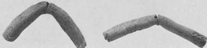
Abb. 53. Ton- und Lehmwalzen nach der Biegeprobe.
