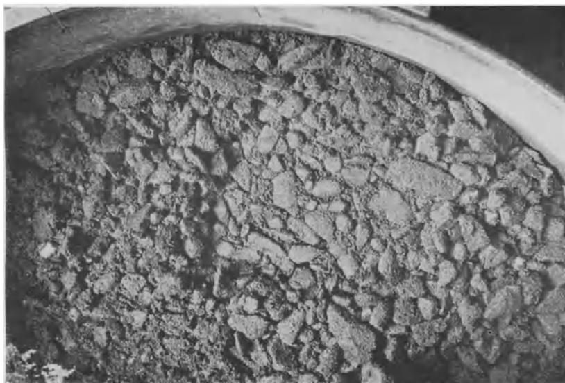
Abb. 144. Stampfbeton, der zu wenig Mörtel enthielt. Mit der Kelle wurden 10 Schläge ausgeführt. Die geschlagene Fläche hat sich nicht hinreichend geschlossen.
