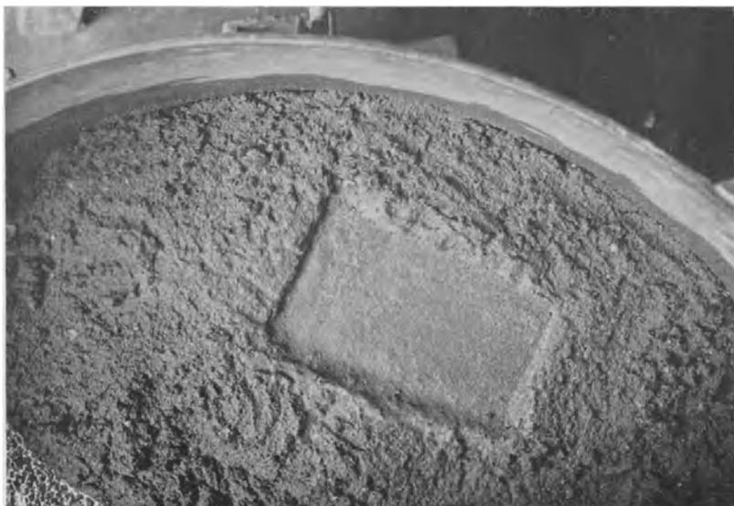
Abb. 146. Beton für massige Eisenbetontragwerke. Mörtelgehalt größer als nötig. Die geglättete Fläche entstand unter 2 Kellenschlägen mit erheblicher Einsenkung des Betons.
