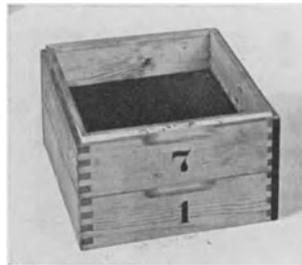
Abb. 133. Kleiner Siebsatz zur Ermittlung des Sandgehalts von Kiessand usf., sowie des Betonfeinsands im Betonsand.
