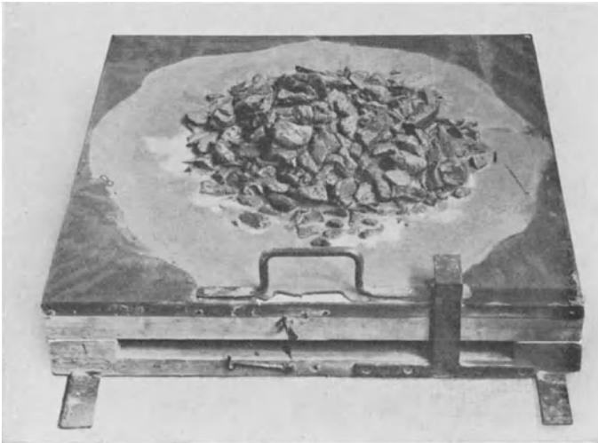
Abb. 154. Beton mit zu großem Anteil der groben Zuschläge.
