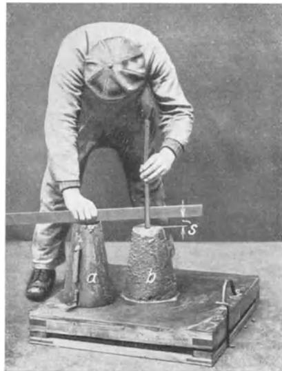
Abb. 150. Setzprobe. Messen von *s*.
