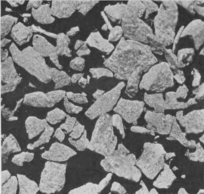
Abb. 37. Doppelt gebrochener Basaltquetschsand, Rückstand auf dem Sieb mit 1 mm Lochdurchmesser, abgesiebt auf dem Sieb mit 3 mm Lochdurchmesser, in etwa sechsfacher Vergrößerung.
