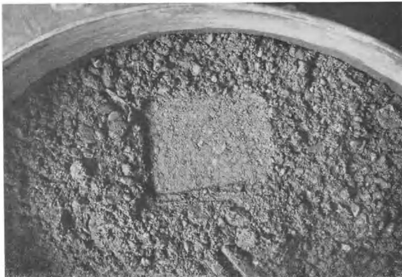
Abb. 145. Stampfbeton mit genügendem Mörtelgehalt und hinreichend nachgiebig. Die geglättete Fläche ist unter 5 Kellenschlägen entstanden.
