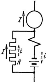
Abb. 22. Schaltung III mit Erregerbatterie und Parallelwiderstand.
