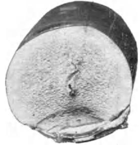
Abb. 69. Nickelstahl, im Einsatz gehärtet.
