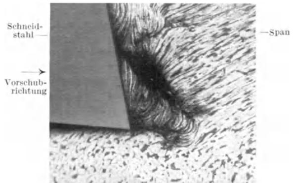
Abb. 26. Kaltverformung beim Zerspanen.
