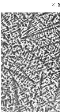
Abb. 22. Stahl mit 0,35% C: Gußgefüge.
