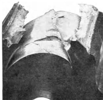
Abb. 72. Bruch eines vergüteten Chromnickelstahls.
