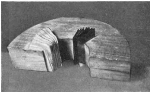
Abb. 39. Schaufelklotz zur ersten Versuchsturbine.
