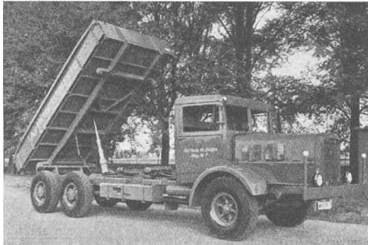
Abb. 44. Büssing-Dreiaxlastkraftwagen 135/145 PS, 9 t Nutzlast.
