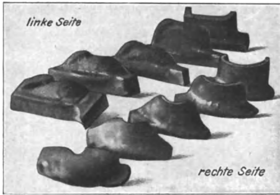
Abb. 103. Faltungssystem. Linke Seite: Vierkantöhr; die Falte wird zur scharfen Ecke umgebildet. Rechte Seite: Die Umbildung des zylindrischen Öhrs aus der Halbkugel.
