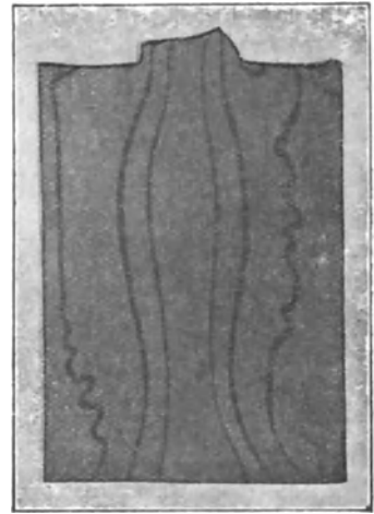
Abb. 201. Die Bildung von V_1 , V_2 und V_3 . Wegen seiner exzentrischen Lagerung im Aufnehmer ist die Pressung rechts weiter vorgeschritten als links. Betriebsversuch.
