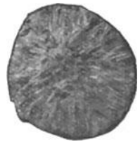
Abb. 221. Radiale Kristallagerung im gegossenen Block (Knüppel).
