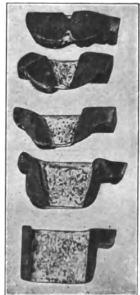
Abb. 110. Ziehen eines vierkantigen Öhrs in einem Arbeitsgang.
