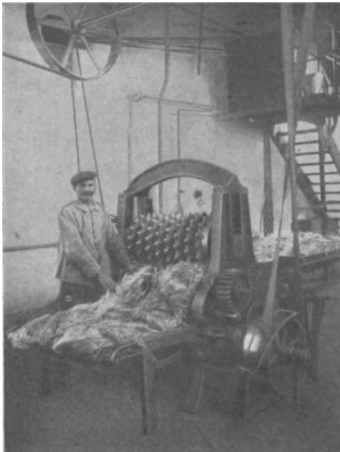
Abb. 52. Schaubild des Seydelschen Ballenöffners.
