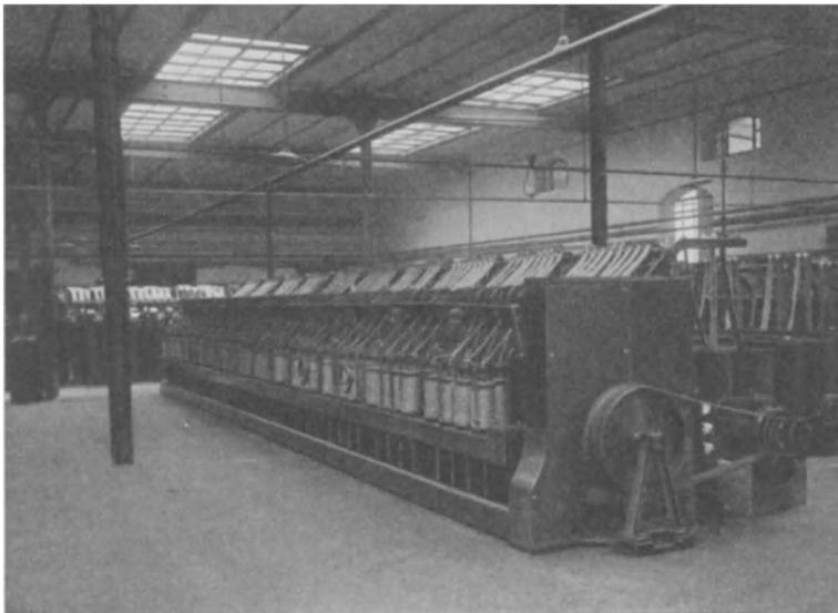
Abb. 313. Vorspinnmaschine mit 80 Spindeln  $10 \times 6$  Zoll von James Mackie & Sons, Belfast.
