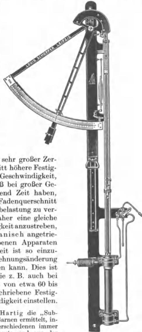
Abb. 8. Schopper-Festigkeitsprüfer mit Wasserantrieb.
