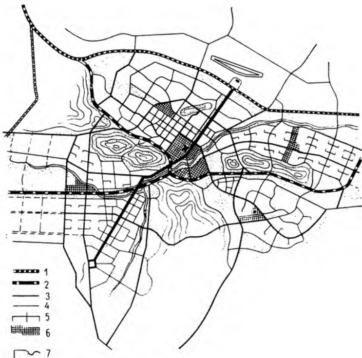
Рис. 2.11. Кабул (Афганистан). Планировочная схема городского движения 1 — скоростная магистраль государственного значения; 2 — скоростные магистрали; 3 — городские магистрали; 4 — районные связи; 5 — подъезды к жилой застройке; 6 — основные центры города; 7 — пешеходные связи
