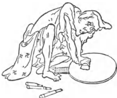
Abb. 19. Japanischer Handwerker beim Polieren eines Spiegels der Art, die den „Zauber-effekt“ zeigt. Aus Silvanus Thompsons Buch „Light Visible and Invisible“ (Sichtbares und unsichtbares Licht). Teilansicht eines japanischen Stiches aus dem British Museum.
