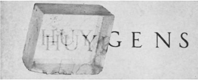
A. Diese Photographie zeigt die Verdopplung von Gegenständen, die man durch ein Kalkspatprisma hindurch betrachtet. (S. 130, 131.)
