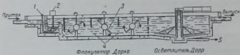
Рис. 100. Перемешивание, флокуляция и коагулирование при горизонтальном потоке (по материалам Dorr Co)
