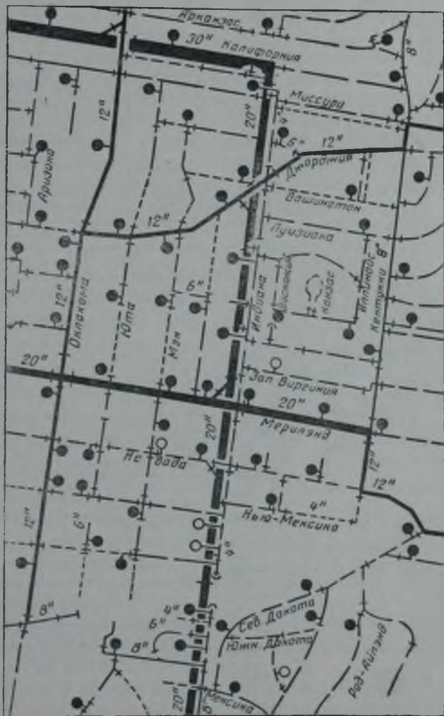
Рис. 89. Часть полного плана водопроводной распределительной системы (из Recommended Practice for Distribution System Records, J. A. W. W. A., February, 1940, p. 188)
