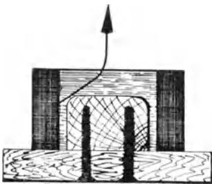
Abb. 32. Aus dem Spinnkopf genommener Spinnkuchen.
