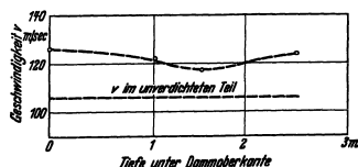
Abb. 34. Die Ausbreitungsgeschwindigkeit der Wellen von der Frequenz 40 Hz in verschiedenen Tiefen, gemessen auf dem verdichteten Teil des Dammes.
