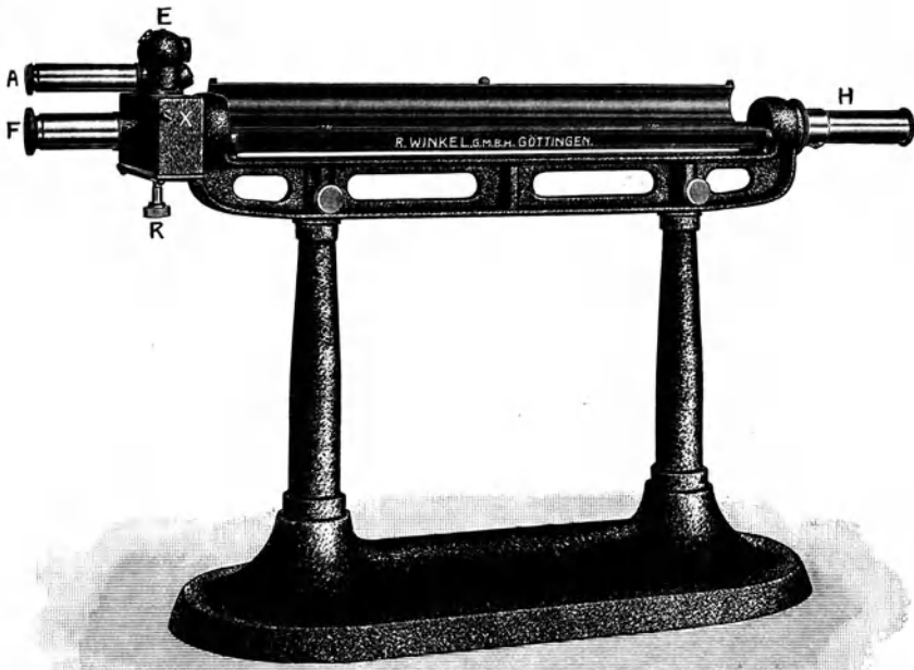
Abb. 21. Polarisationsapparat mit einfacher Quarzkeilkompensation und abnehmbarem Oberteil
