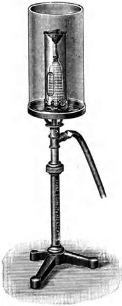
Abb. 29. Gasglühlampe für Polarisationsapparate
