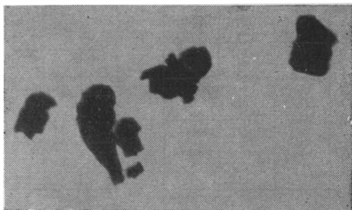
Рис. 15. Микрофотография частиц кокса, полученного при 350—390 °С (увеличено в 14 000 раз).
