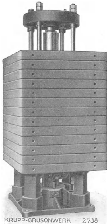
Abb. 15. Akkumulator mit Gewichtsbelastung.
