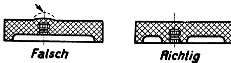
Abb. 60 u. 61. Abstand der Einpreßteile von der Oberfläche.
