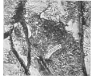
Fig. 24. Perlitischer Grauguß. V = 350×
