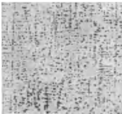
Fig. 28. Phosphorkristallseigerung. V = 5x
