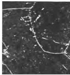
Fig. 12. Überperlitischer Stahl ( C = 1,5 ). V = 100 \times
