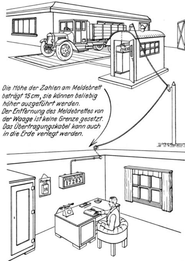
Abb. 44. Elektrische Fernanzeige des Kontrollergebnisses.
