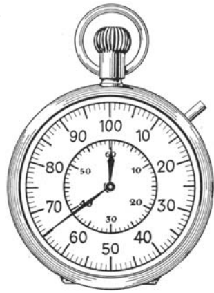
Abb. 3. Die Krone betätigt Anfang, Stopp, Weiterlauf. Der Knopf betätigt Nullstellung.
