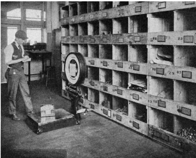
Abb. 7. Verwägung kleinerer Mengen mittels einer als Zählwaage ausgebildeten Neigungswaage (Continental Toledo G. m. b. H.).
