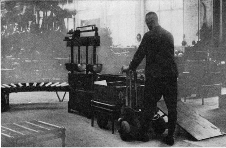
Abb. 16. Stückzählwaage in einem Preßwerk (Werksleiter 19 [1929], S. 470).
