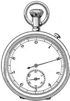
Abb. 5. Die Krone betätigt den Anfang, Stopp und Nullstellung. Der Knopf betätigt den Schleppzeiger.
