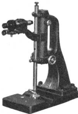
Abb. 25. Einrichtung zur Durchmesserprüfung von Gewindebohrern ohne Zentrierung; rechts Einrichtung zur Zentrierung (AEG).
