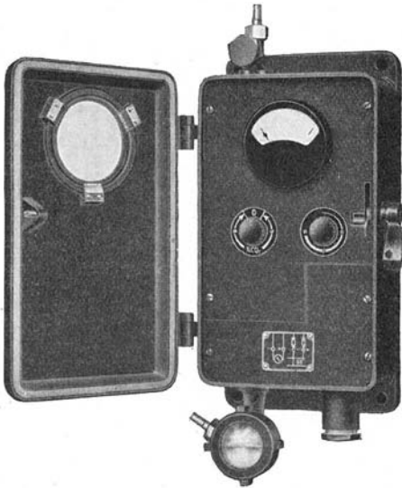
Abb. 18. Siemens-CO 2 -Geber geöffnet. Das Rauchgas tritt durch das Filter links unten in den Apparat und verläßt ihn links oben.
