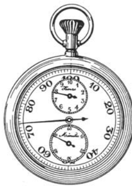
Abb. 2. Die Krone betätigt Anfang, Stopp, Weiterlauf. Der Schieber betätigt Nullstellung.
