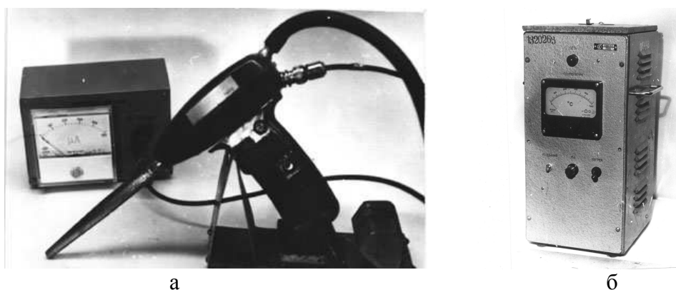
Рис. 4.15. УЗ паяльник УЗП2-0,025 (а) и УЗ ванна УЗВЛ-0,4 (б)
