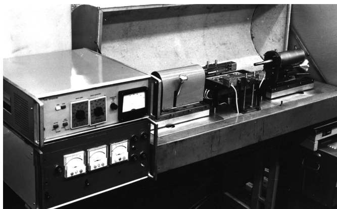
Рис. 5.8. Установка УЗ пайки микроплат в корпусе микросборок
