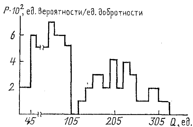
Рис. 9.7. Гистограмма добротностей жестких электродов маломощных транзисторов первого типа
