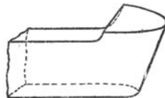
Fig. 27. Stahl mit gekrümmter Schneide.
