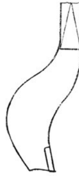
Fig. 396. Nutenstahl mit aufgeschweißtem Schnellstahl.
