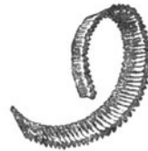
Fig. 7. Spanlocke von hartem und zähem Stahl.
