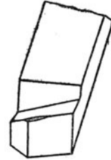
Fig. 543. Auf Grauguß abgenutzte Schneide.
